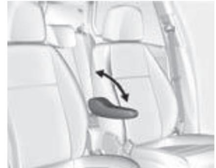
Puede haber un descansabrazos en la parte interior del asiento del conductor. Para levantar o bajar el descansabrazos, presiónelo hacia arriba o jálelo hacia abajo.
