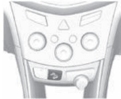
Active el sistema presionando el botón del sistema de control de descenso (DCS) que se ubica en la columna central. La luz verde del sistema de control de descenso (DCS) se enciende en el grupo de instrumentos cuando el sistema está encendido.
