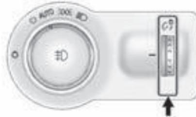
Si está equipado, función controla el brillo de los controles del panel de instrumentos y la pantalla de infoentretenimiento. La rueda para pulgar está a la izquierda de la columna de dirección sobre el tablero de instrumentos.
