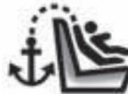
Para ayudar a ubicar los anclajes con correa superior, el símbolo del anclaje de correa superior está ubicado sobre la moldura cerca del anclaje.
