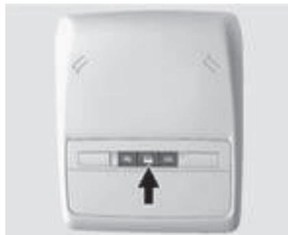
Si está equipado, los controles de las luces delanteras del techo están en la consola superior.
