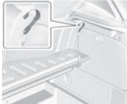
Doble el piso de carga. Coloque el gancho desde el piso de carga dentro del gancho sobre la moldura lateral.
