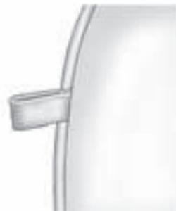
1. Ubique el circuito de anclaje en el respaldo trasero externo, cerca de la parte superior.
