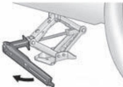
5. Coloque el extremo de tubo hexagonal de la llave sobre la cabeza hexagonal del gato para unirlos.
