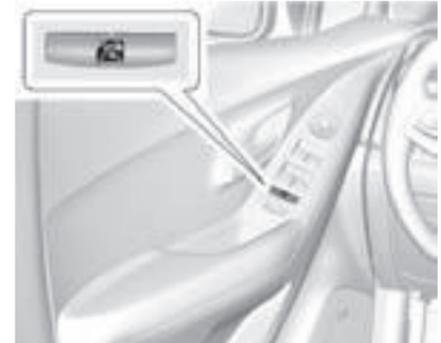
La función de bloqueo de ventanilla trasera impide que las ventanillas traseras del lado del pasajero sean operadas, excepto desde la posición del conductor.
