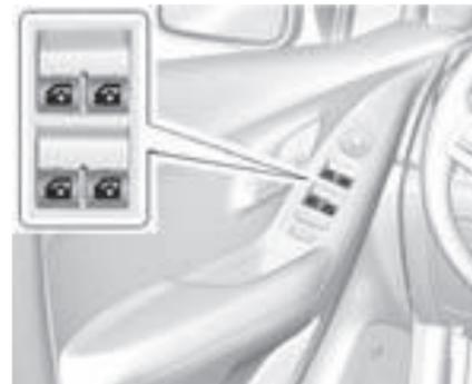
La puerta del conductor también tiene interruptores que controlan las ventanas del conductor y traseras. Los interruptores funcionan cuando el vehículo se encuentra en ON/RUN (encendido/funcionamiento) o ACC/ACCESSORY (accesorio), o en Energía retenida para los accesorios (RAP). Consulte *Energía retenida para los accesorios (RAP) en la página 9-22*.
