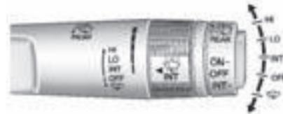
La palanca del limpiaparabrisas/lavador está en el lado derecho de la columna de dirección.
