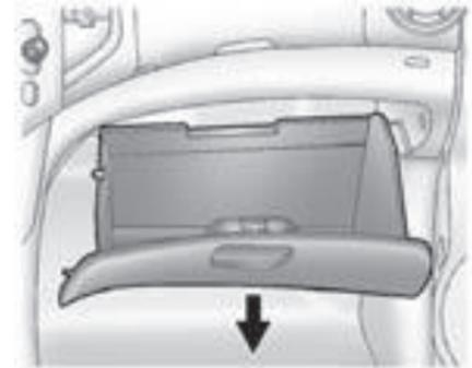
1. Abra la guantera completamente y desconecte el amortiguador en el lado externo.
