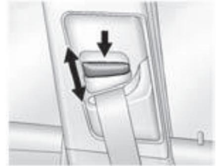
Para mover el ajustador de altura del cinturón de hombro hacia abajo, oprima el botón de liberación y mueva el ajustador de altura a la posición deseada. Se puede mover el ajustador de altura presionando la guía del cinturón del hombro.
