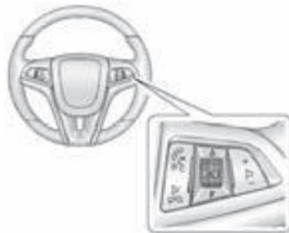
Algunos controles de audio del volante de dirección pueden diferir dependiendo de las opciones del vehículo. Algunos controles de audio se pueden ajustar al volante.
