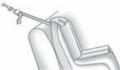
Si la posición que usa no tiene cabecera y utiliza una atadura sencilla, dirija la atadura sobre el respaldo.
