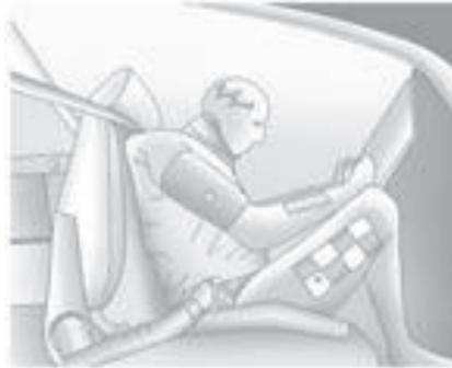
Al ir en el vehículo, usted viaja a la velocidad del mismo. Si algo detiene el vehículo de manera abrupta, usted continuará viajando hasta que algo lo detenga. Podría ser el parabrisas, el tablero de instrumentos o los cinturones de seguridad.
