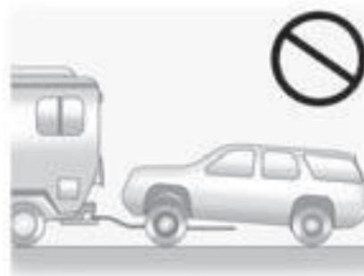
Los vehículos de tracción en las cuatro ruedas no deben remolcarse con dos ruedas en contacto con el suelo. Para remolcar estos vehículos en forma adecuada, se deben colocar en un remolque de
