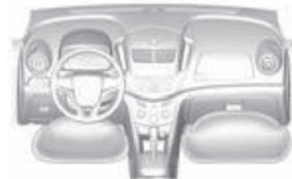
Si el vehículo tiene una bolsa de aire de rodilla para el conductor y para el pasajero exterior delantero, la bolsa de aire de rodilla para el conductor está debajo de la columna de dirección. La bolsa de aire de rodillas del pasajero está debajo de la guantera.
