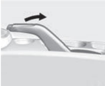
Para ajustar el freno de estacionamiento, sostenga abajo el pedal del freno y tire hacia arriba la palanca del freno de estacionamiento. Si el encendido está activado, la luz de advertencia del sistema de frenos se enciende. Consulte *Luz de advertencia del sistema de frenos en la página 5-19*.
