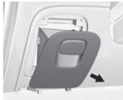
La caja de fusibles del tablero de instrumentos se encuentra en el lado inferior del tablero de instrumentos del lado del conductor. Para tener acceso a los fusibles, remueva el compartimento de almacenamiento. Para remover el compartimento de almacenamiento, presione en ambos lados y extráigalo.
