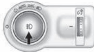
Si el vehículo está equipado con luces de niebla delanteras, el botón está en la parte exterior del tablero de instrumentos.
