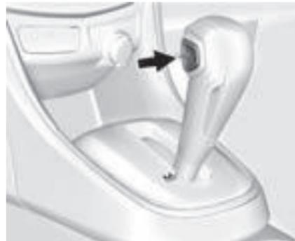
DSC le permite cambiar a una transmisión automática que es similar a una transmisión manual. Para usar la función de DSC:
