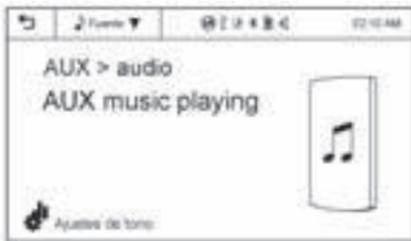
Conecte el dispositivo auxiliar a la terminal de entrada AUX. La reproducción empezará cuando el sistema haya terminado de leer la información en el dispositivo.
