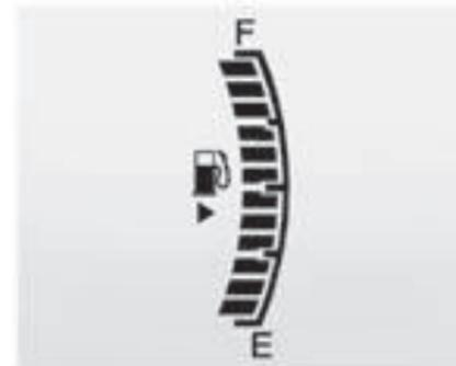
El indicador de combustible muestra cuánto combustible queda cuando se gira la ignición a ON/RUN (encendido/operación).
