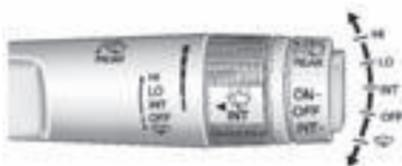
La palanca del limpiador/lavador del parabrisas está ubicada del lado derecho de la columna de dirección.
