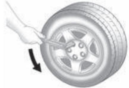
3. Haga girar la llave para las ruedas en sentido inverso al de las manecillas del reloj para aflojar las tuercas de la rueda. No las retire aun.
