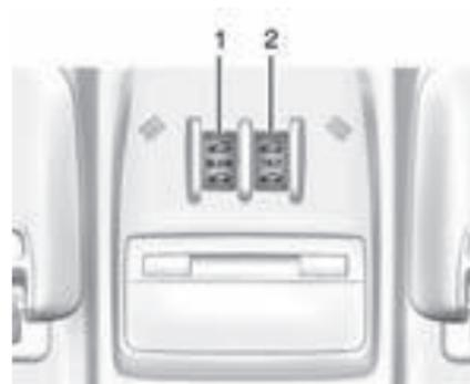
Si está equipado el quemacocos sólo funciona cuando la ignición está en ON/RUN o la energía retenida para los accesorios (RAP) está activa.
