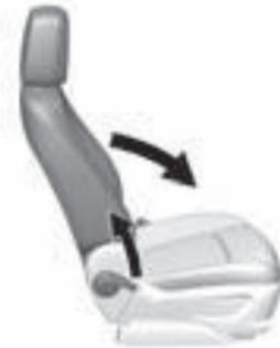
3. Eleve la palanca completamente y pliegue el respaldo hacia adelante.
