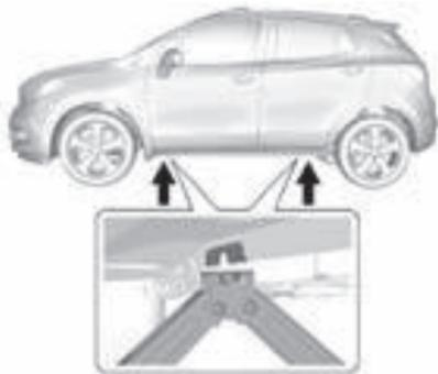
4. Coloque el gato hidráulico en la posición marcada con un medio círculo.
