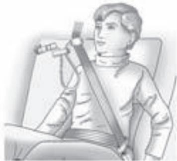
7. Abroche y coloque el cinturón de seguridad como se describe previamente en esta sección. Compruebe que el cinturón de hombro cruce el hombro.
