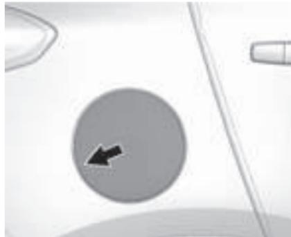
Para abrir la puertecilla para el tanque de gasolina, empuje la puertecilla en el centro del borde que da hacia la parte trasera del vehículo y libérela; ésta se abrirá.
