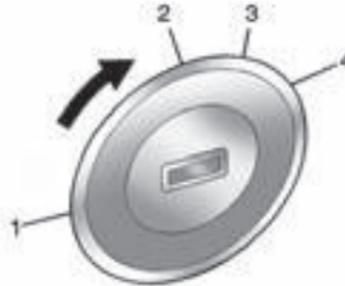
El interruptor de encendido tiene cuatro posiciones diferentes.
