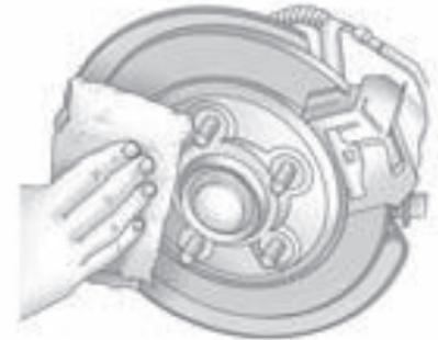
10. Elimine todo el óxido y la suciedad de los pernos de la rueda, las superficies de montaje y la rueda de refacción.
