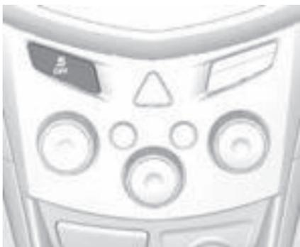
El botón para el sistema de control de tracción (TCS) y StabiliTrak está en la columna central.
