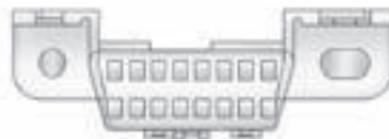
El DLC está debajo del tablero de instrumentos del lado izquierdo del volante. Visite su concesionario si necesita asistencia.
