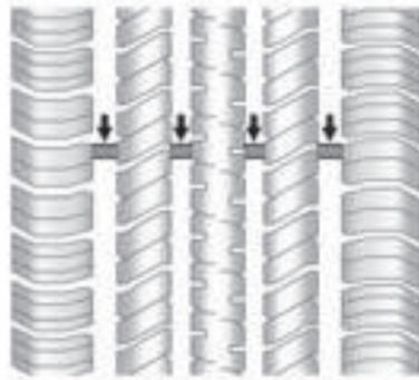
Los indicadores de desgaste del dibujo son una de las maneras de decidir cuándo es el momento para nuevas llantas. Los indicadores de desgaste aparecen cuando las llantas tienen solamente 1.6 mm (1/16 de pulgada) de dibujo remanente. Vea *Inspección de las llantas en la página 10-63*. *Rotación de las llantas en la página 10-63*.
