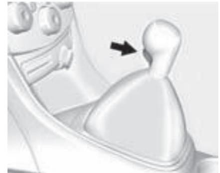
Para enganchar la R (Reversa), con el vehículo detenido, jale del botón en la palanca selectora y enganche la velocidad. Si la velocidad no se engancha, coloque la palanca en
