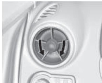
Gire las perillas en las ventilas de aire laterales en sentido contrario a las manecillas del reloj o en sentido de las manecillas del reloj para abrir o cerrar el flujo de aire.
