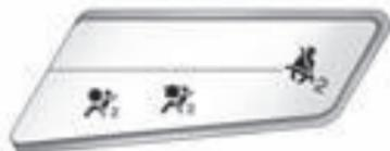
El símbolo para ON (encendido) y OFF (apagado) será visible durante la verificación del sistema. Cuando la verificación del sistema esté completa, el símbolo para encendido o apagado estará visible. *Vea Indicador de estatus de la bolsa de aire del pasajero (Canadá) en la página 5-15.*
