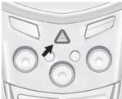
**△ (Luces intermitentes):** Oprima y sostenga momentáneamente este botón para hacer que las luces direccionales delanteras y traseras destellen intermitentemente. Esto advierte a otros que usted está teniendo problemas. Presione y sostenga momentáneamente este botón nuevamente para apagar las intermitentes.
