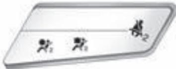
Cuando se arranca el vehículo, el indicador de estado de la bolsa de aire del pasajero encenderá el símbolo para ON (encendido) y OFF (apagado), durante varios segundos a modo de revisión al sistema. Entonces, después de varios segundos, el indicador de estado
