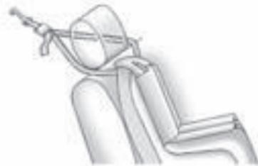
Si la posición que está utilizando tiene una cabecera ajustable y está utilizando una atadura doble, levante la cabecera y pase la correa por debajo de la cabecera así como alrededor de las barras de la cabecera.
