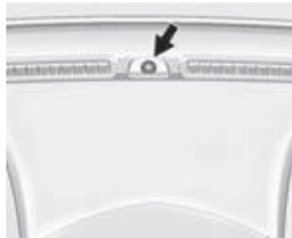
El vehículo tiene un sensor de luz en la parte superior del tablero de instrumentos. Asegúrese de que no
