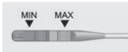
Si el aceite está por debajo de la marca MIN (mínimo) en la varilla de medición, añada 1 L (1 qt) del aceite recomendado y, entonces, vuelva a revisar el nivel. Vea la explicación sobre qué tipo de aceite usar en "Elección del aceite correcto para el motor" en esta sección. Para conocer la capacidad del cárter de aceite, consulte *Capacidades y especificaciones en la página 12-3*.
