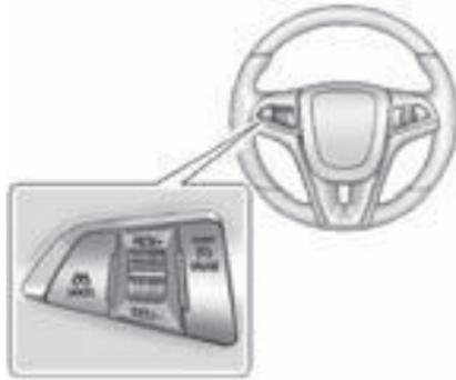
**CRUISE (encendido/apagado):** Oprima para encender y apagar el sistema de control de crucero.
