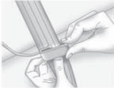
3. Coloque la guía sobre el cinturón e inserte los dos bordes del cinturón dentro de las ranuras de la guía.
