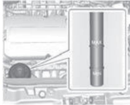
Cuando el motor está caliente, el nivel debe estar en el nivel MAX caliente. Cuando el motor está frío, el nivel del líquido debe estar entre las marcas MIN y MAX de la varilla de medición.
