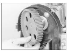
11.22A Refit the camshaft sprocket . . .
