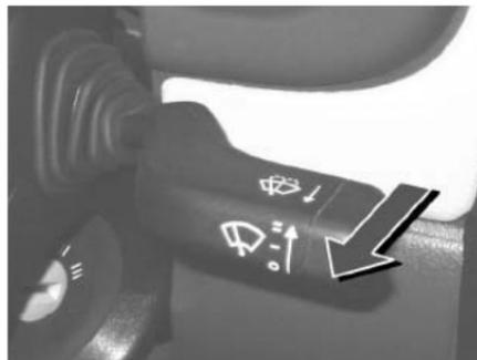
Presionar hacia adelante la palanca. Primera posición (pos. fija) = Limpiado
