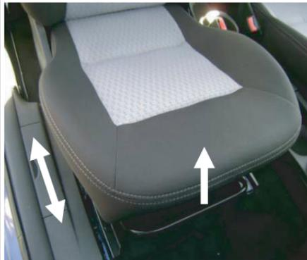
No variar nunca la posición del asiento del conductor estando en marcha el vehículo porque puede suceder que el asiento se desplace incontroladamente con la palanca liberada.
