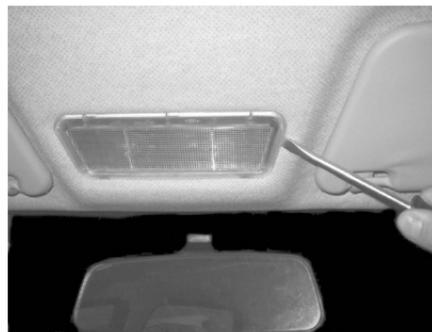
Antes de desmontar la lámpara de la cajueta mantener oprimido el interruptor de contacto, para que el foco no tenga corriente.
