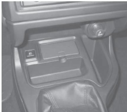
El encendedor de cigarrros se encuentra debajo del portaobjetos o bien del radio. Presionar el encendedor de cigarrros estando el encendido conectado. El encendedor se desconecta cuando está incandescente la resistencia en espiral. Extraerlo entonces.
