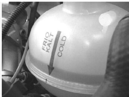
Con el sistema de enfriamiento frío, el nivel de anticongelante en el depósito de compensación debe encontrarse un poco por encima de la marca "COLD" (frío). Con el motor caliente a la temperatura de servicio, éste sube, volviendo a bajar al enfriarse el motor. Si el nivel desciende por debajo de la marca debe rellenarse hasta un poco por encima de dicha marca.
