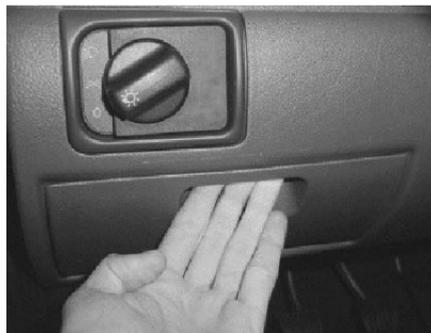
Para sustituir un fusible es necesario tener el interruptor de ignición en la posición de apagado.
