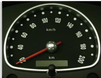
Indica la velocidad en kilómetros por hora (km/h)
