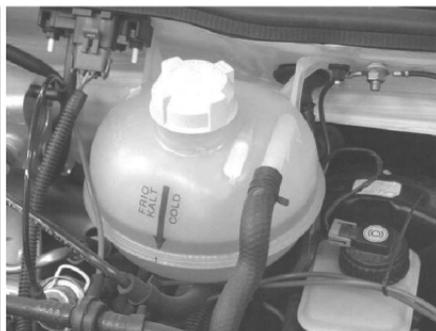
Si no fuera posible identificar el problema, y el nivel de líquido de enfriamiento no estuviese al máximo, añada al tanque de recuperación una mezcla de Agua potable limpia o si no hubiera entonces Usar agua destilada y refrigerante para motor DEX-COOL® a razón de 50%.
