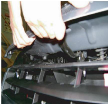
Para mantener el cofre abierto, este ha de levantarse de 20 a 25 centímetros desde su posición cerrada para permitir que de forma automática desde este punto el amortiguador abra completamente el cofre.
