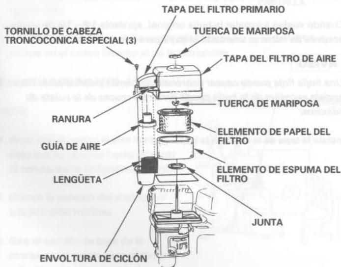
5. Limpie los elementos del filtro de aire si debe volver a utilizarlos.
