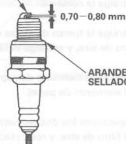
4. Mida el huelgo del electrodo de la bujía con un calibre de espesores del tipo de alambre. Corrija el huelgo, si es necesario, doblando con cuidado el electrodo lateral. El huelgo deberá ser: 0,70-0,80 mm
