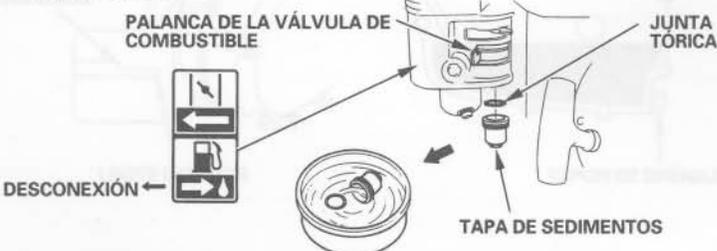
3. Ponga la junta tórica en la válvula de combustible, e instale la taza de sedimentos. Apriete con seguridad la taza de sedimentos.
