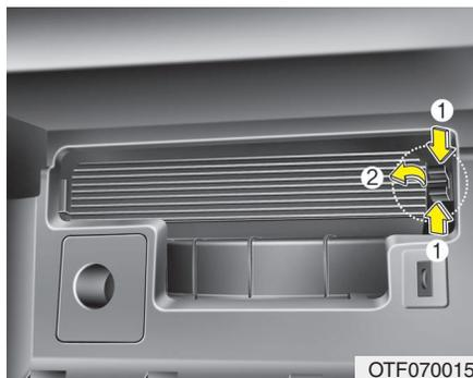
3. Extraiga la cubierta del filtro de aire del control del climatizador pulsando el bloqueo a la derecha de la cubierta.
