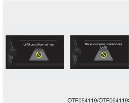
En la pantalla LCD aparecerá un mensaje si no se cumplen las condiciones para activar el LKAS. Además se escuchará una señal acústica. La advertencia desaparecerá cuando se cumplan las condiciones.
