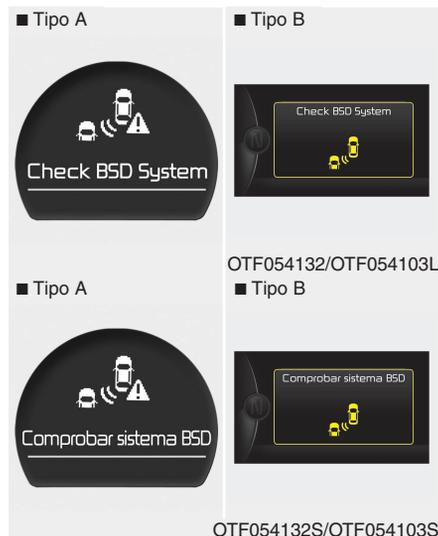
Si el sistema no funciona con normalidad, aparece un mensaje de advertencia y el testigo del interruptor se apaga. El sistema se apaga automáticamente.
