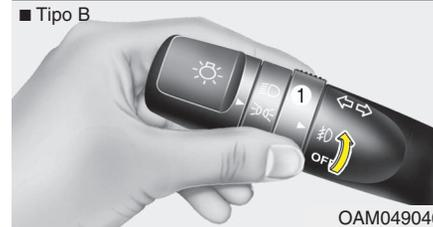
Las luces antiniebla mejoran la visibilidad y evitan accidentes en condiciones de niebla, lluvia, nieve, etc. Las luces antiniebla se encienden llevando a ON el interruptor correspondiente (1), una vez que se ha activado el mando de las luces de posición.
