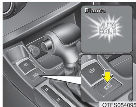
1. Con la puerta del conductor, el capó y la puerta del maletero cerradas, abroche el cinturón de seguridad del conductor o pise el pedal del freno y pulse el botón Auto Hold. El indicador AUTO HOLD se encenderá en color blanco y el sistema se colocará en la posición de espera.
