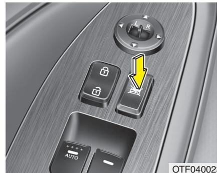
El conductor puede desactivar los interruptores de los elevalunas eléctricos de las puertas de los acompañantes traseros pulsando el interruptor de bloqueo de los elevalunas eléctricos hacia la posición de bloqueo (pulsado). Cuando el interruptor de bloqueo de elevalunas eléctrico está pulsado:
