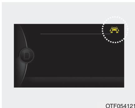
El indicador de fallo del LKAS (amarillo) se ilumina con una señal acústica si el LKAS no funciona correctamente. Recomendamos que se ponga en contacto con un distribuidor Kia autorizado.
