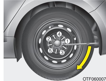
Coloque después la llave como se muestra en la figura y apriete las tuercas de la rueda. Asegúrese de que la cazoleta asienta completamente sobre la tuerca. No se ponga de pie sobre la llave ni utilice un tubo para prolongar el brazo de palanca. Apriete por tuercas alternas hasta terminar con todas. Debe volver a comprobar cada tuerca para comprobar el apriete. Después de cambiar las ruedas, recomendamos que haga revisar el sistema por un distribuidor Kia autorizado.
