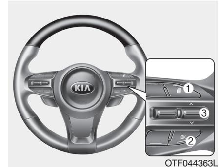
Los modos de la pantalla LCD pueden cambiarse usando los botones de ajuste en el volante.
