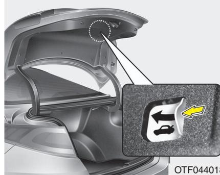
Su vehículo dispone de un cable de apertura de emergencia del maletero situado en el interior. Si se encierra a alguien sin darse cuenta en el maletero, mueva el mango exterior en la dirección de la flecha lo que desactivará el mecanismo de anclaje del maletero y abrirá el maletero.
