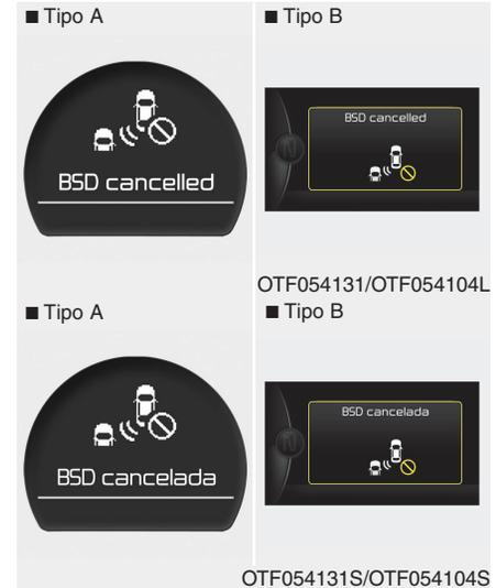
El mensaje aparece para notificar al conductor sobre la presencia de cuerpos extraños en el parachoques trasero o sobre la presencia de calor cerca del parachoques trasero. El testigo del interruptor y el sistema se apagan automáticamente.
