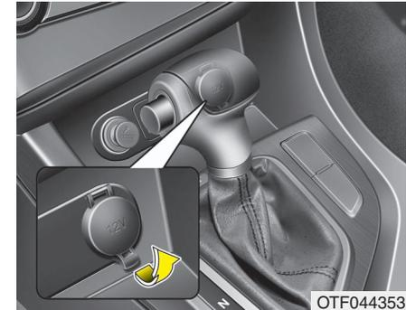
Se ha dispuesto un enchufe que suministra corriente eléctrica para teléfonos móviles u otros dispositivos que funcionen conectados al sistema eléctrico. Dichos dispositivos deben consumir menos de 10 amperios y han de utilizarse con el motor en marcha.
