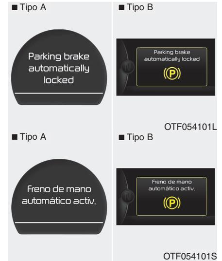
Si se acciona el EPB mientras la sujeción automática (Auto Hold) está activada debido a la señal ESC (Control de estabilidad electrónica), sonará una alarma acústica y aparecerá un mensaje.
