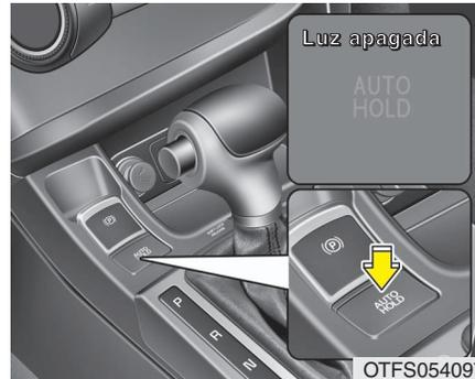
Para cancelar la operación de Auto Hold, pulse el interruptor Auto Hold. Se apagará el indicador AUTO HOLD. Para cancelar la operación de Auto Hold (sujeción automática) cuando el vehículo esté parado, pulse el interruptor Auto Hold mientras pisa el pedal del freno.
