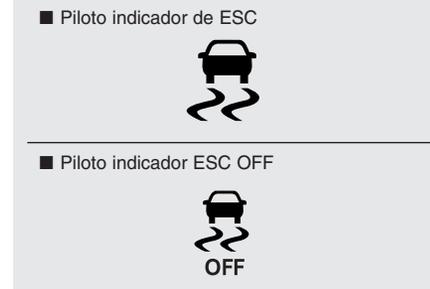
Cuando se lleva el contacto a ON, el piloto indicador se ilumina, y se apaga a continuación si el sistema ESC funciona correctamente.
