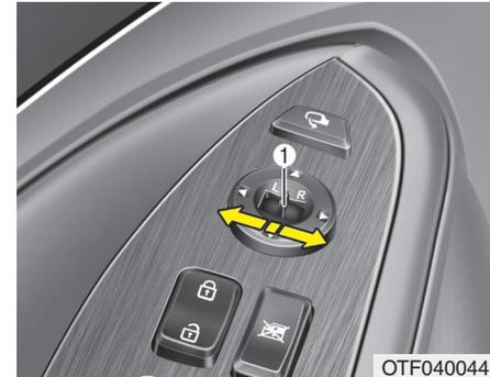
El mando eléctrico de los retrovisores permite ajustar la posición de los espejos izquierdo y derecho. Para ajustar la posición de cualquier de los retrovisores, el contacto debe de estar en la posición ACC.
