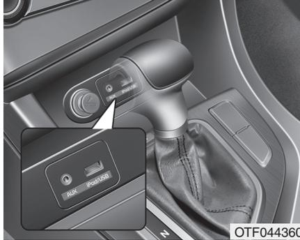
Si su vehículo tiene una puerto AUX y/o USB (bus serial universal) o iPod®, puede usar el puerto AUX para conectar los aparatos del audio y el puerto USB para enchufar un aparato USB y el puerto iPod® para enchufar un iPod®.
