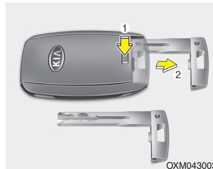
Si la llave smart no funciona correctamente, puede bloquear o desbloquear todas las puertas usando la llave mecánica.
