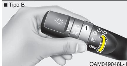
Para encender los pilotos antiniebla traseros, coloque el interruptor de la luz antiniebla trasera (1) en la posición ON con la luz de estacionamiento encendida.
