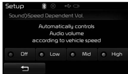
El nivel del volumen se controla automáticamente según la velocidad del vehículo. SDVC puede ajustarse seleccionando Off/Low/Mid/High.
