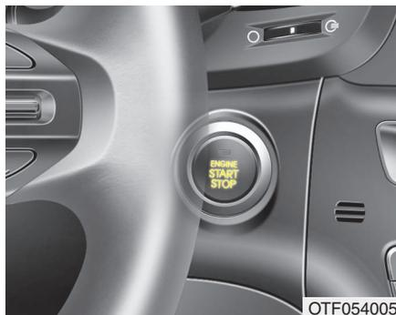
Cada vez que se abre una puerta delantera, el botón de inicio/parada del motor se iluminará como ayuda. La luz se apaga 30 segundos después de cerrar la puerta. Se apagará inmediatamente cuando se active el sistema de alarma.
