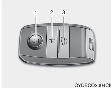
Si tiene una llave smart, puede bloquear y desbloquear una puerta (y el maletero) e incluso arrancar el motor sin meter la llave.
