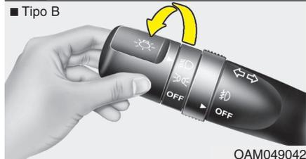
Cuando el interruptor de las luces está en la posición de faros, se encenderán los faros, la parte trasera, la matrícula y el panel de instrumentos.
