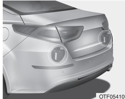
Los sensores están situados dentro del parachoques trasero. Mantenga el parachoques trasero siempre limpio para que el sistema pueda funcionar correctamente.
