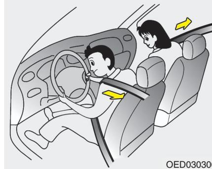
Su vehículo está provisto de cinturones de seguridad con pretensores para el conductor y el acompañante. El objeto de los pretensores es asegurar el ajuste firme de los cinturones contra el cuerpo en ciertas colisiones frontales. Los pretensores del cinturón del asiento pueden activarse en choque cuando la colisión frontal es lo bastante fuerte.
