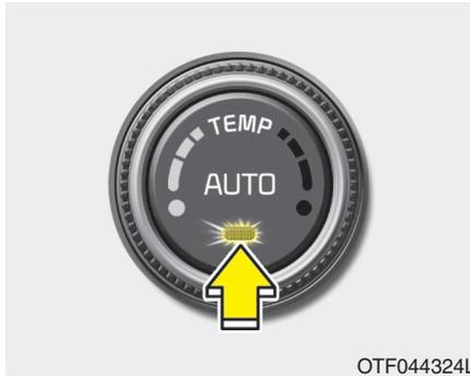
1. Pulse el botón AUTO. Al fijar la temperatura quedarán controlados automáticamente los modos, las velocidades del ventilador, la entrada de aire y el aire acondicionado.
