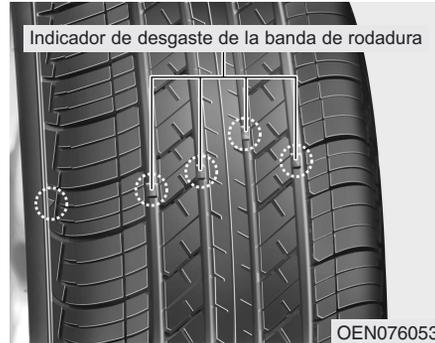
Si el neumático está gastado uniformemente, aparecerá un indicador de desgaste de la banda de rodadura en forma de una banda sólida transversal. Esto indica que quedan menos de 1,6 mm (1/16 de pulgada) de banda de rodadura. Es el momento de sustituir el neumático.
