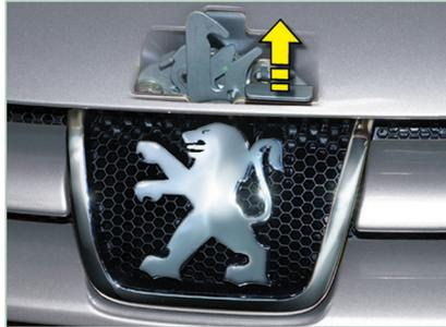
**Desde el exterior:** levante el mando, levante el capot y fije el soporte para mantener el capot abierto.
