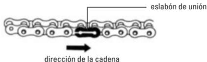
Si la cadena o el piñón y la corona se encuentran excesivamente gastados o dañados, deberán ser reemplazados. Nunca utilizar una cadena nueva con piñón y corona desgastados, esto acelerará su desgaste.
