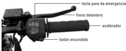
2 Inserte la llave de arranque en el interruptor y posícionelo en ON (encendido). Verifique que el cambio se encuentra en posición N (neutral), el indicador del tablero se encenderá.
