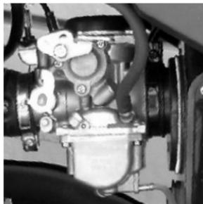
Ajuste el carburador con el tornillo de regulación ralentí hasta obtener 1400 R.P.M. en vacío.
