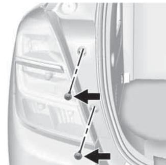
2. Retire los dos tornillos, que aseguran el ensamblaje de la luz trasera.
