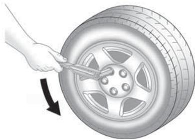
3. Haga girar la llave para las ruedas en sentido inverso al de las agujas del reloj para aflojar las tuercas de la rueda. No las retire aun.
