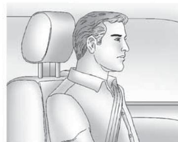
Ajuste los apoyacabezas de tal forma que la parte superior de la misma esté a la misma altura que la parte superior de la cabeza del ocupante. Esta posición reduce la probabilidad de una lesión de cuello durante un accidente.
