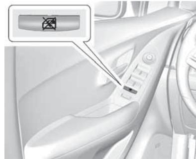
La función de bloqueo de ventanilla trasera impide que las ventanillas traseras del lado del pasajero sean operadas, excepto desde la posición del conductor.
