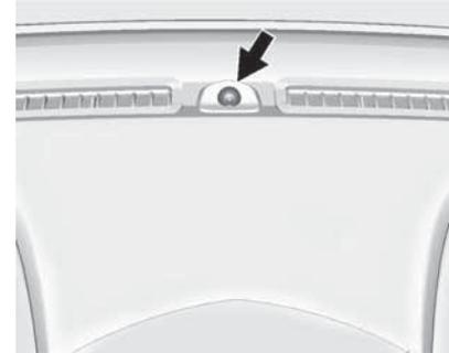
El vehículo tiene un sensor de luz en la parte superior del tablero de instrumentos. Asegúrese de que no está cubierto, o los faros se encenderán cuando no sean necesarios.
