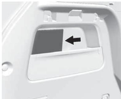
La caja de fusibles del compartimiento trasero se encuentra detrás de una cubierta en el lado izquierdo del compartimiento trasero. Para tener acceso a los fusibles, remueva la cubierta.
