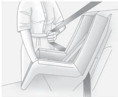
4. Tire del cinturón de hombro completamente fuera del retractor para ajustar el seguro. Cuando el seguro del retractor esté ajustado, el cinturón se puede apretar pero no se puede jalar fuera del retractor.
