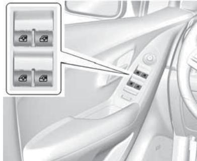
La puerta del conductor también tiene interruptores que controlan las ventanillas del conductor y traseras. Los interruptores funcionan cuando el vehículo se encuentra en ON/RUN (encendido/funcionamiento) o ACC/ACCESSORY (accesorio), o en Energía retenida para los accesorios (RAP). Consulte *Energía retenida para los accesorios (RAP) en la página 9-21*.
