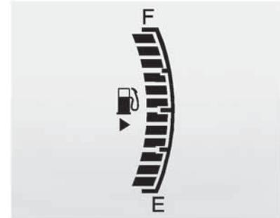
El indicador de combustible muestra cuánto combustible queda cuando se gira la ignición a ON/RUN (encendido/operación).
