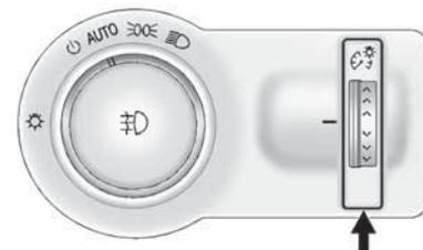
Esta función controla el brillo de los controles del panel de instrumentos y la pantalla de infoentretenimiento. La rueda para pulgar está a la izquierda de la columna de dirección sobre el tablero de instrumentos.
