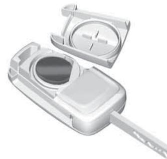
1. Extienda la llave y abra la cubierta de la batería en la parte trasera del transmisor haciendo palanca con un dedo.
