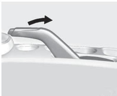
Para ajustar el freno de estacionamiento, sostenga abajo el pedal del freno y tire hacia arriba la palanca del freno de estacionamiento. Si el encendido está activado, la luz de advertencia del sistema de frenos se enciende. Consulte *Luz de advertencia del sistema de frenos en la página 5-18*.
