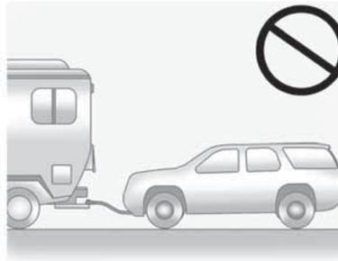
**Aviso:** Si el vehículo es arrastrado con las cuatro ruedas en contacto con el suelo podrían dañarse los componentes del mecanismo de transmisión. Las reparaciones no estarían cubiertas por la garantía del vehículo. No arrastre el vehículo con las cuatro ruedas en contacto con el suelo.
