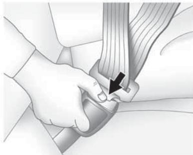
Para desabrochar el cinturón, presione el botón del broche. El cinturón debería regresar a su posición de almacenamiento. Deslice la placa del seguro hacia arriba por la banda trenzada del cinturón de seguridad cuando no esté utilizando el cinturón.
