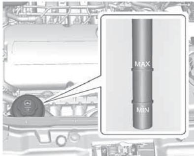
Cuando el motor está caliente, el nivel debe estar en el nivel MAX (máximo) caliente. Cuando el motor está frío, el nivel del líquido debe estar entre las marcas MIN (mínimo) y MAX (máximo) de la varilla de medición.
