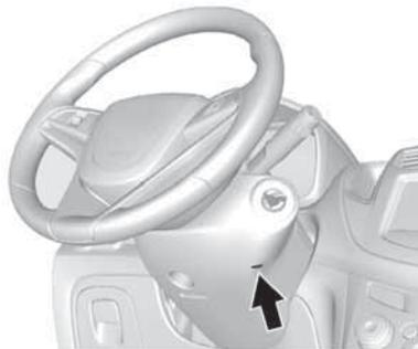
Los vehículos con transmisión automática pueden estar equipados con un sistema electrónico de liberación de bloqueo de la llave. Este sistema está diseñado para evitar el retiro de la llave de encendido, a menos que la palanca de cambios esté en P (estacionamiento).
