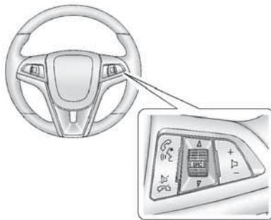
Los vehículos con sistema de Teléfono a Manos Libres pueden usar un teléfono celular con capacidad Bluetooth y un perfil de manos libres para hacer y recibir llamadas telefónicas. El sistema de Infoentretenimiento y el control de voz se utilizan para hacer funcionar el sistema. No todos los teléfonos son compatibles con todas las
