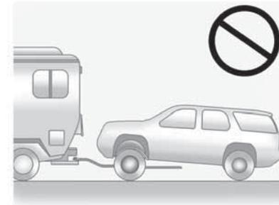
Los vehículos de tracción en las cuatro ruedas no deben remolcarse con dos ruedas en contacto con el suelo. Para remolcar estos vehículos en forma adecuada, se deben colocar en un remolque de
