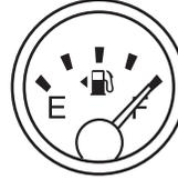
La flecha al lado del icono de la bomba de combustible indica en qué costado del vehículo está ubicado el orificio de llenado de combustible.
