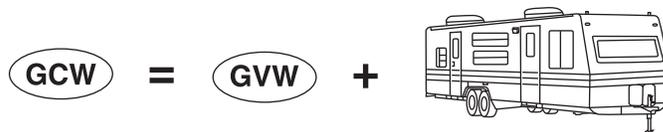
**GCW (Peso bruto combinado):** es el peso del vehículo cargado (GVW) más el peso del remolque totalmente cargado.
