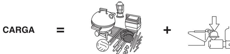
**Peso de la carga:** es todo el peso agregado al Peso base listo para rodar, incluyendo la carga y el equipamiento opcional. Si arrastra un remolque, el peso de la lanza del remolque o el peso apoyado en el pivote de arrastre también es parte del peso de la carga.
