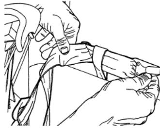
2. Guíe la correa de sujeción detrás de los soportes del apoyacabezas a un anillo detrás de una posición de asiento adyacente y enganche el gancho de la correa sobre el anillo. Si utiliza el lado del conductor, pase la correa detrás del montaje del cinturón de hombro para el asiento del centro.
