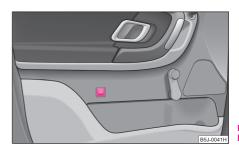
Fig. 24 Unlocking the boot lid
