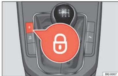
**Fig. 3** Consola central: pulsadores del cierre centralizado.
