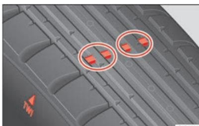
Fig. 225 Indicadores de desgaste del perfil del neumático.
