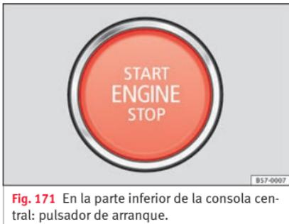
**Fig. 171** En la parte inferior de la consola central: pulsador de arranque.
