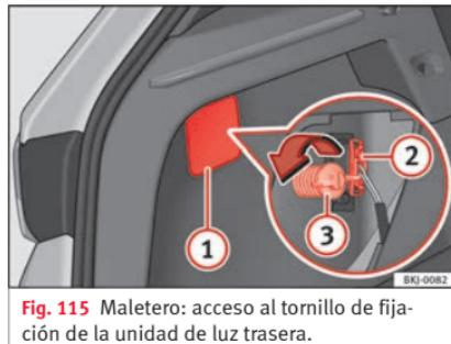
Fig. 115 Maletero: acceso al tornillo de fijación de la unidad de luz trasera.
