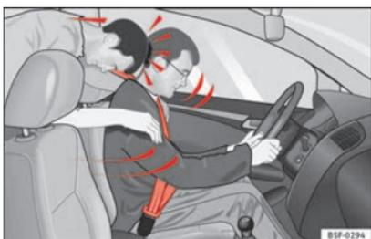
**Fig. 100** El ocupante del asiento trasero que no lleve puesto el cinturón de seguridad se verá lanzado hacia delante sobre el conductor que sí lleva el cinturón.
