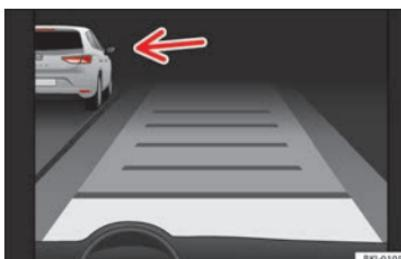
**Fig. 195** En la pantalla del cuadro de instrumentos: ACC activo, vehículo detectado por la izquierda
