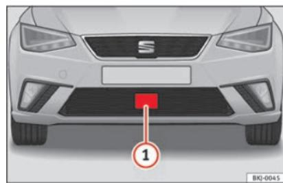
Fig. 185 En el paragolpes delantero: sensor de radar.
