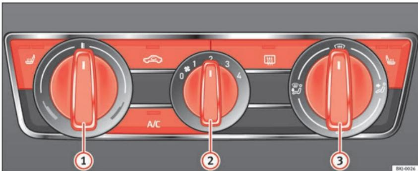
**Fig. 168** Mandos del aire acondicionado en el tablero de instrumentos.
