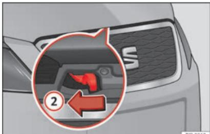
**Fig. 10** Palanca bajo el capó.
