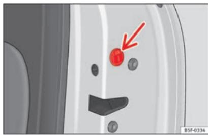
**Fig. 5** Bloqueo de emergencia de la puerta.
