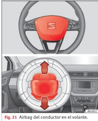
**Fig. 21** Airbag del conductor en el volante.
