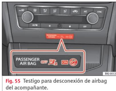
**Fig. 55** Testigo para desconexión de airbag del acompañante.
