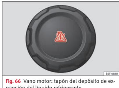
Fig. 66 Vano motor: tapón del depósito de expansión del líquido refrigerante.
