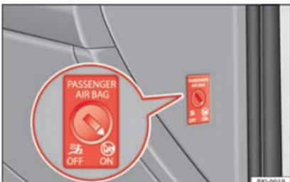
**Fig. 23** Comutador del airbag frontal del acompañante.
