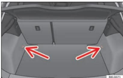
**Fig. 162** Disposición de las argollas de amarre en el maletero.
