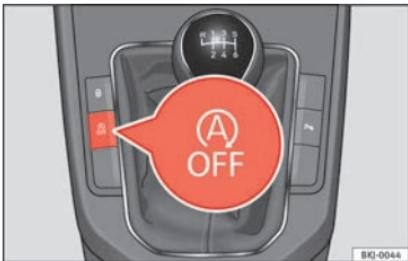
Fig. 179 Consola central: tecla del sistema Start-Stop.
