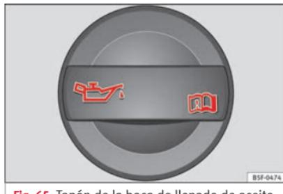
**Fig. 65** Tapón de la boca de llenado de aceite del motor en el vano motor.**Reponer aceite**
