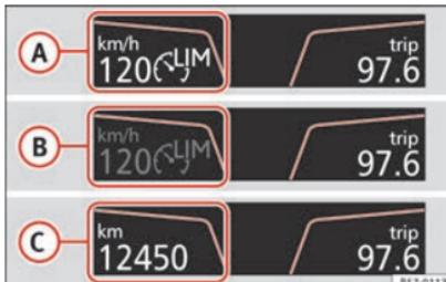
**Fig. 181** En la pantalla del cuadro de instrumentos: indicaciones del estado del limitador de velocidad.
