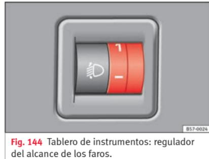
Fig. 144 Tablero de instrumentos: regulador del alcance de los faros.
