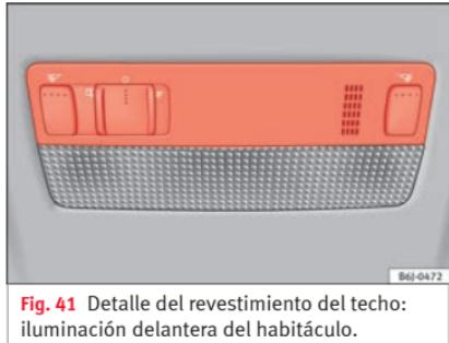
**Fig. 41** Detalle del revestimiento del techo: iluminación delantera del habitáculo.
