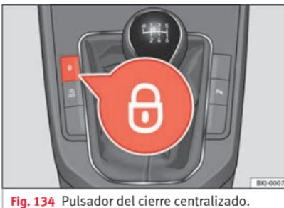
Fig. 134 Pulsador del cierre centralizado.
