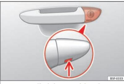
**Fig. 4** Manecilla de la puerta del conductor: bombín de cierre oculto.
