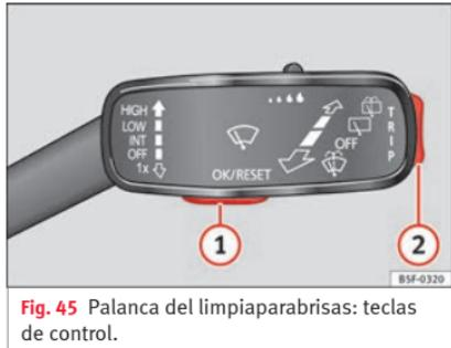
Fig. 45 Palanca del limpiaparabrisas: teclas de control.
