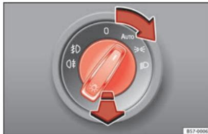
**Fig. 142** Tablero de instrumentos: mando de las luces.
