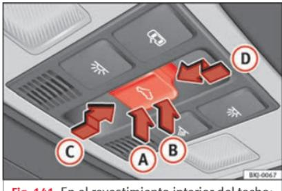
**Fig. 141** En el revestimiento interior del techo: tecla del techo de cristal.
