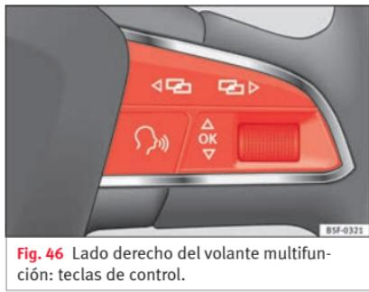
Fig. 46 Lado derecho del volante multifunción: teclas de control.
