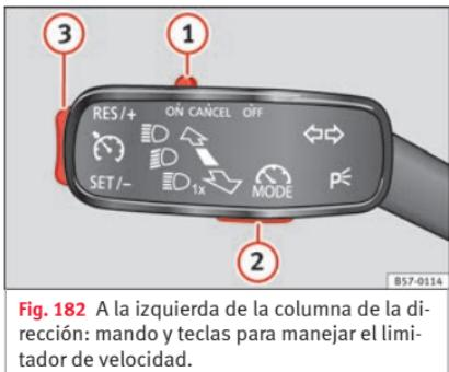
Fig. 182 A la izquierda de la columna de la dirección: mando y teclas para manejar el limitador de velocidad.
