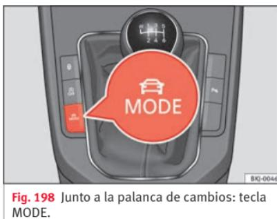
**Fig. 198** Junto a la palanca de cambios: tecla MODE.
