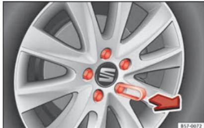
**Fig. 80** Rueda: tornillos de la rueda con capuchones.
