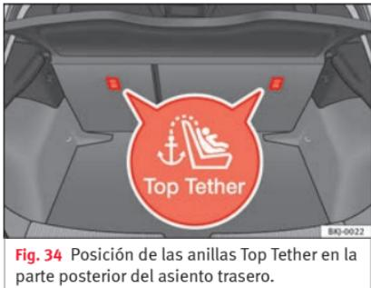
**Fig. 34** Posición de las anillas Top Tether en la parte posterior del asiento trasero.
