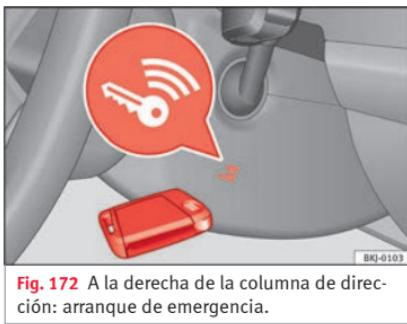
**Fig. 172** A la derecha de la columna de dirección: arranque de emergencia.
