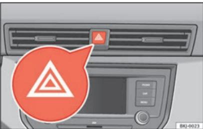
Fig. 40 Tablero de instrumentos: conmutador de los intermitentes de emergencia.
