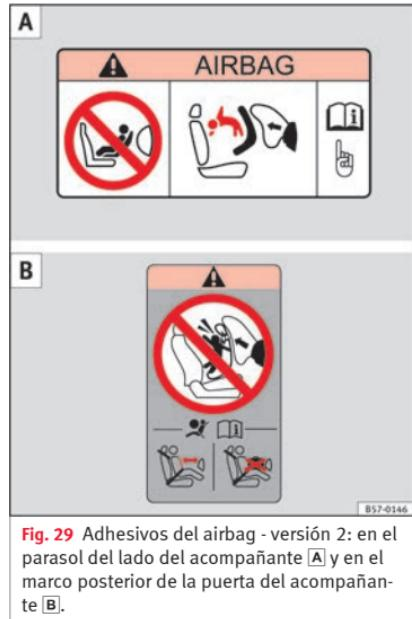
**Fig. 29** Adhesivos del airbag - versión 2: en el parasol del lado del acompañante **A** y en el marco posterior de la puerta del acompañante **B**.
