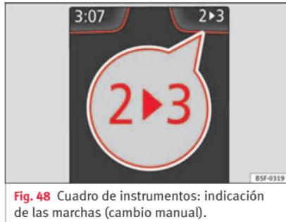
**Fig. 48** Cuadro de instrumentos: indicación de las marchas (cambio manual).
