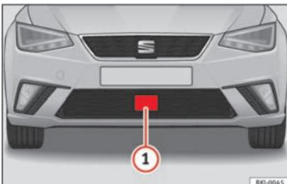
**Fig. 192** En el paragolpes delantero: sensor de radar.
