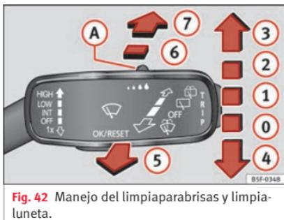
**Fig. 42** Manejo del limpiaparabrisas y limpialuneta.
