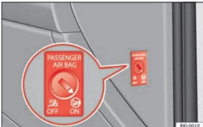
Fig. 103 Comutador con llave para activar y desactivar el airbag del acompañante.
