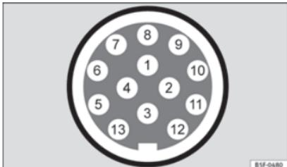
**Fig. 219** Representación esquemática: asignación de los pines de la toma de corriente del remolque.
