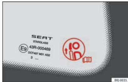
Fig. 96 Etiqueta de advertencia de la posición del apoyacabezas.
