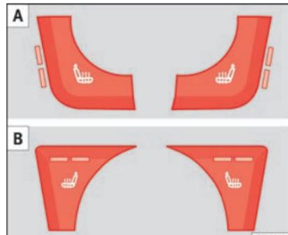
Fig. 150 En la consola central: mandos para la calefacción de los asientos delanteros. **A:** versión con Climatronic. **B:** versión con aire acondicionado manual.
