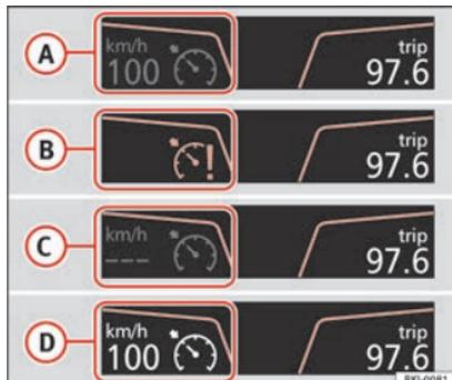
Fig. 180 Pantalla del cuadro de instrumentos: indicaciones de estado del GRA.
