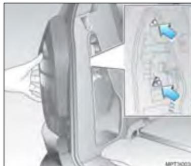
2. Solte a conexão do soquete da lâmpada.
