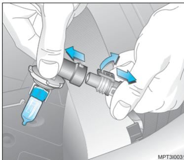
4. Levante a lingueta e solte a conexão do soquete.
