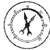
GUIAS DE VALVULAS DESGASTADAS (SE ESTABILIZA A MEDIDA QUE AUMENTA LA VELOCIDAD DEL MOTOR)
