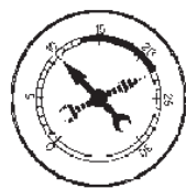
MUELLES DE VALVULA DESGASTADOS (MAS PRO- NUNCIADO A MEDIDA QUE AUMENTA LA VELOCIDAD DEL MOTOR)
