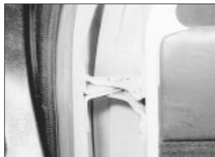
16.4a Front door upper hinge
