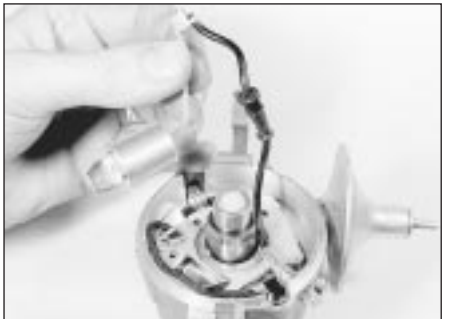
5.8 Removing the condenser (Lucas)
