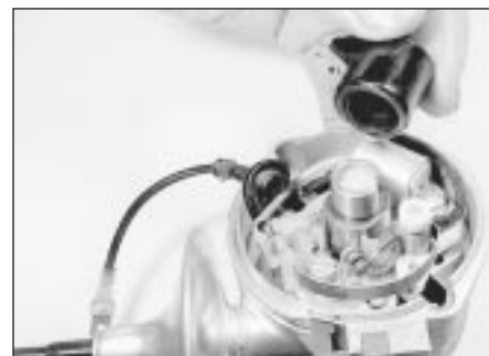
34.1 Removing the rotor arm (Lucas)
