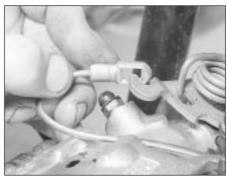
11.5a Unhook the handbrake cable . . .
