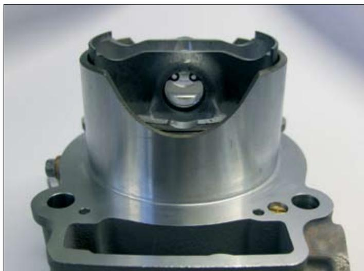
Deslice el cilindro hacia abajo entre los prisioneros hasta que el pie de biela quede alineado con el alojamiento del pasador. A continuación introduzca el pasador desde el lado que aún sigue abierto, y bloquéelo con su anillo elástico, habiendo lubricado previamente las superficies del propio pasador y su alojamiento.
