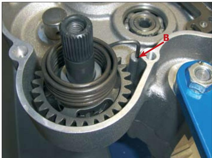
Coloque el engranaje de reenvío del arranque (17) en su eje, junto con las dos arandelas de empuje 18x27x0,5 (16 y 18), tras haber lubrificado las piezas en contacto entre sí, y asegúrelo con el anillo elástico (19).
