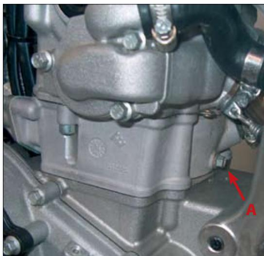
Sitúe un recipiente de drenaje bajo el motor y desatornille el perno de drenaje del sistema de refrigeración (A).
