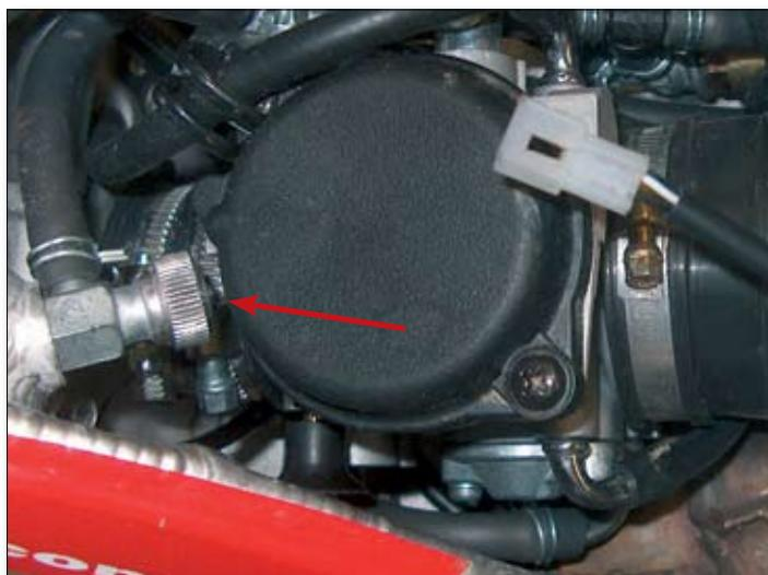
Cierre el tapón del depósito de combustible atornillando el pomo correspondiente.
