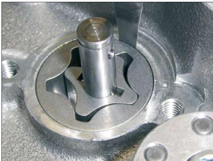
Mida la holgura entre el rotor externo y el alojamiento de la bomba, usando también una galga de espesores.
