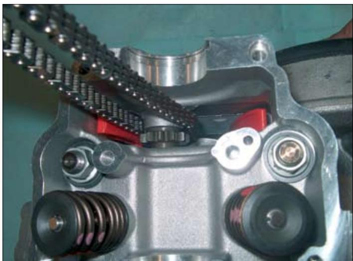
Desatornille las tuercas de fijación de la cabeza del cilindro, que están atornilladas en los prisioneros, así como el perno del lateral de la bomba de agua. A continuación retire la cabeza del cilindro y la junta, procurando retirar también los bulones de centrado.
