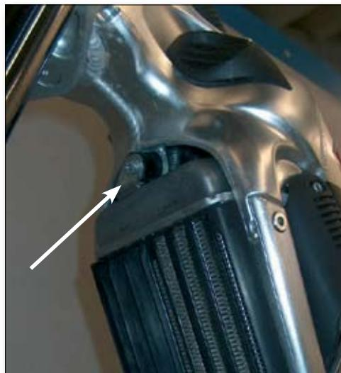
Desatornille el perno que fija el radiador y desmonte todo el bloque del radiador tras desconectar los conectores del ventilador eléctrico y el sensor del radiador.
