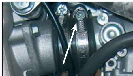
Afloje la abrazadera (A) que fija el manguito de goma a la caja del filtro y tire del carburador hacia atrás (consulte la flecha en la imagen) hasta que el carburador quede completamente desconectado del desvío de admisión de goma.
