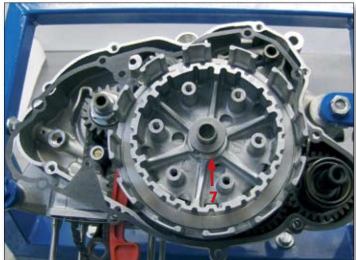
Utilizando un destornillador, libere las lengüetas de la arandela de empuje (10) que bloquea la tuerca de fijación (9) del tambor del embrague (11) y desatornille la tuerca, usando la herramienta especial para bloquear el tambor del embrague.
