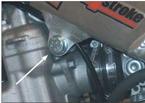
Saque el perno que fija la cabeza del cilindro al bastidor.
