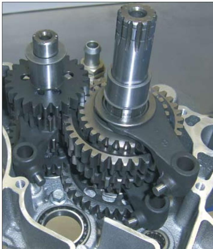
Compruebe el desgaste en las zapatas de la leva de la caja de cambios. Sitúe la leva en su cojinete y los rodillos en las zapatas. Empuje los dos pasadores a través de las horquillas, asegurándose de utilizar el más largo para las horquillas del cigüeñal secundario.
