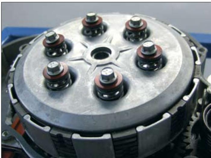
Coloque la tapa del embrague (13), los muelles del embrague (14), las arandelas especiales (15) y los pernos M6x16 (16).
