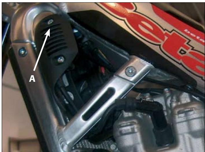
Desatornille los pernos que fijan el bloque al bastidor (A) y saque el perno de montaje del motor delantero (B) tras desatornillarlo.
