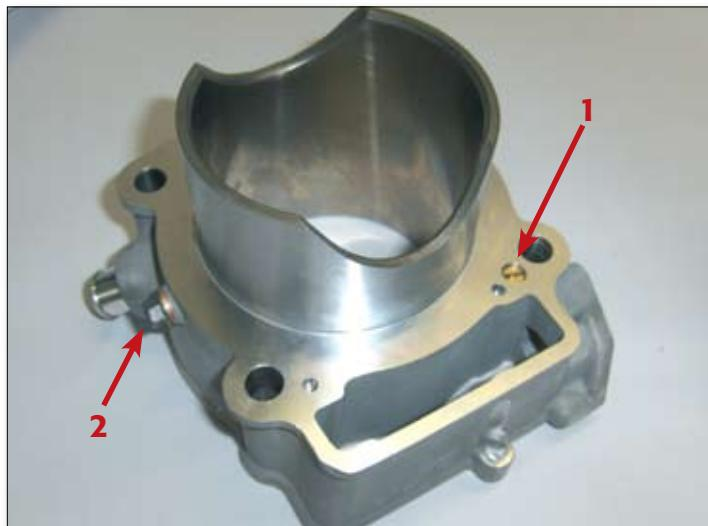
Introduzca el pistón en el cilindro desde abajo, situándolo en la dirección correcta (con la flecha apuntando en el sentido de marcha de la motocicleta). Lubrifique abundantemente las superficies de contacto, y tenga cuidado de no dañar los segmentos de pistón. Seguidamente, introduzca el anillo elástico para fijar el pasador, sólo en un lado. Asegúrese de que la parte abierta del anillo elástico esté mirando hacia arriba o hacia abajo.
