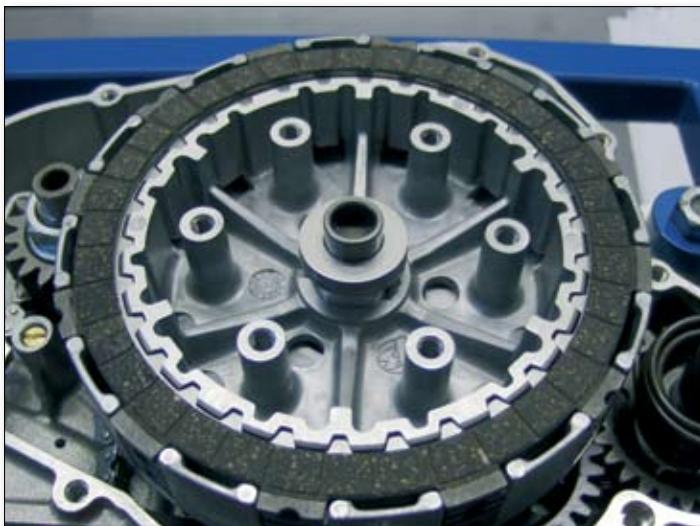
Tras haber colocado todos los discos de fricción, coloque la placa disco (10) en el agujero central de la campana del embrague, junto con la caja de la chumacera (11) y la arandela correspondiente (12). Compruebe el desgaste de la caja de la chumacera y las superficies de contacto. Sustituya los componentes si muestran un desgaste excesivo.
