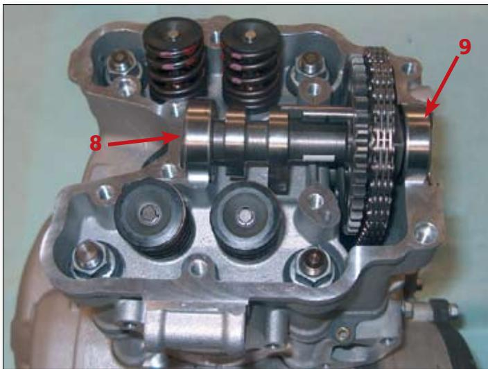
Pase la cadena de distribución alrededor del piñón del árbol de levas, y coloque en el árbol de levas, por este orden, la caja de rodillos sellada (8) y la caja de rodillos del lado de la cadena (9).
