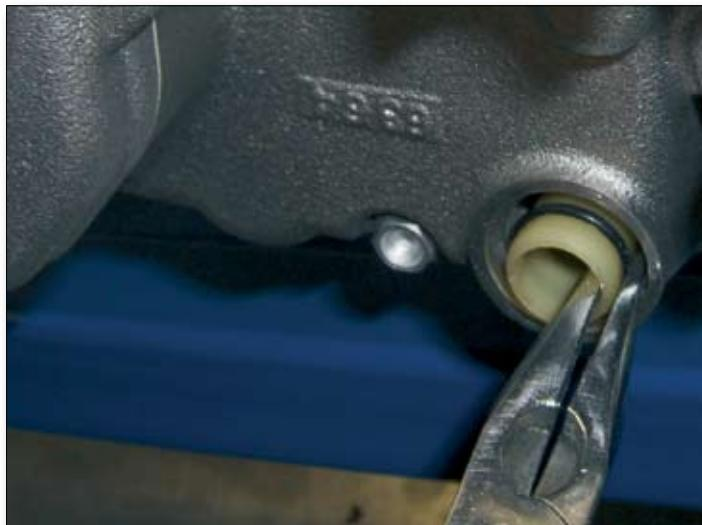
Realice el mismo procedimiento con el filtro de engranaje de descarga, accediendo a él desde el cárter derecho.
