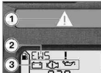
Los avisos se representan mediante el testigo de advertencia general **1** en combinación con una indicación de advertencia, como p. ej., **2** o con uno de los símbolos de advertencia **3**. En función de la urgencia de la advertencia, el testigo de advertencia general se ilumina en rojo o en amarillo. Si hay varias advertencias, se muestran todos los testigos y símbolos de advertencia correspondientes, las
