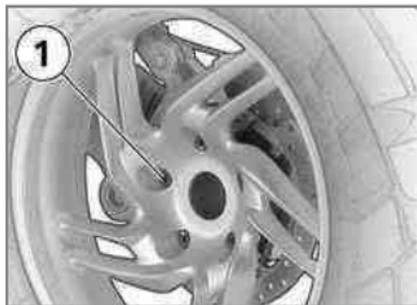
**!** Las longitudes de los tornillos de rueda de la rueda con radios en cruz (equipo opcional) y de la rueda de fundición de aluminio son diferentes. Mezclar o cambiar los tornillos de rueda puede provocar una fijación insuficiente de la rueda trasera y causar un accidente.
