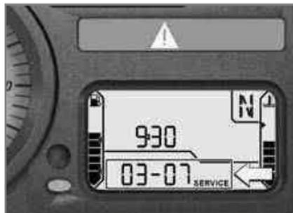
Si el tiempo restante hasta el siguiente servicio de mantenimiento es inferior a un mes, la fecha del servicio de mantenimiento se mostrará seguidamente en el pre-ride check durante un breve espacio de tiempo. El mes y año, ambos con dos cifras, se separan con un guión, en este ejemplo la indicación significa "marzo 2007".
