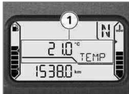
Con el vehículo parado, el calor del motor puede provocar una medición incorrecta de la temperatura ambiente 1. Si la influencia del calor del motor es muy grande, la pantalla muestra -- durante un momento.
