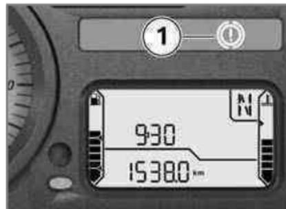
Las advertencias sobre el ABS se muestran mediante los testigos de advertencia del ABS **1**. En algunos países puede optarse por otra representación del testigo de advertencia de ABS.
