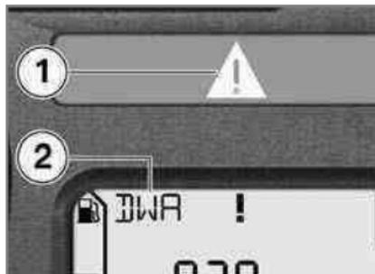
Las advertencias de la alarma antirrobo se muestran a continuación como indicaciones de advertencia **2** en combinación con el testigo de advertencia general **1** en el pre-ride check y se refieren a la capacidad de la batería interna de la alarma antirrobo.
