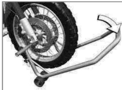
**!** Con la motocicleta sobre el caballete central: si el vehículo se levanta demasiado por delante, el caballete central se levanta del suelo y la motocicleta puede volcar hacia un lado. Al levantarla, asegurarse de que el caballete central permanezca sobre el suelo. ◀
