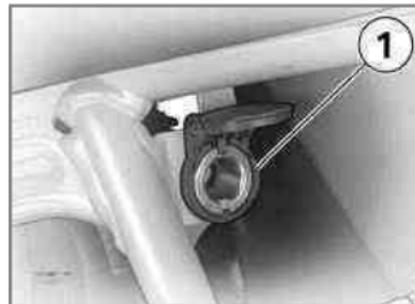
Si la tensión de la batería es baja y se supera la capacidad máxima, se desconectan automáticamente la toma de corriente **1** y la toma de corriente disponible como equipo opcional (EO).
