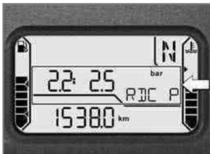
Las presiones de inflado de los neumáticos se muestran con la inscripción RDC P. El valor de la izquierda representa la presión de aire de la rueda delantera, y el de la derecha, el de la rueda trasera. Inmediatamente después de conectar el encendido aparece -- --, ya que la transmisión de los valores de presión comienza a partir de una velocidad de 30 km/h.
