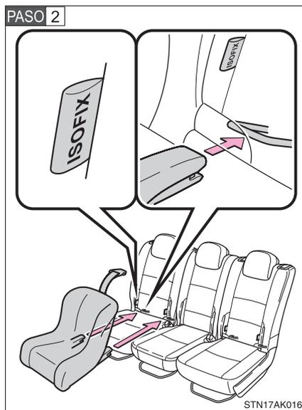
Compruebe las posiciones de los anclajes inferiores e instale el sistema de sujeción para niños en el asiento.
