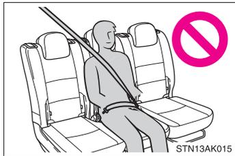
No utilice el cinturón de seguridad del asiento central de la segunda fila con alguna de las hebillas suelta. Abrochar sólo una de las hebillas puede producir lesiones graves o mortales en caso de frenada repentina o de colisión.
