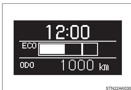
El indicador de conducción ecológica indica el intervalo en el que la aceleración es respetuosa con el medio ambiente, la “zona de conducción ecológica” y la relación de conducción ecológica basada en la aceleración.
