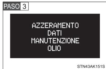
Mientras pulsa el botón de cambio del visualizador (→P. 250), coloque el interruptor del motor en la posición “ON” (vehículos sin sistema de llave inteligente) o el interruptor “ENGINE START STOP” en el modo IGNITION ON (vehículos con sistema de llave inteligente) y en el visualizador aparecerá el mensaje que se muestra en la ilustración.
