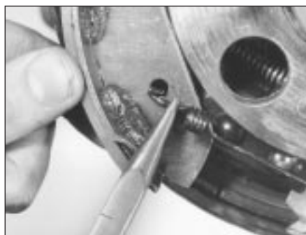
16.5c ... unhook lower return spring ...
