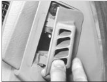
31.11a Remove door demister duct . . .
