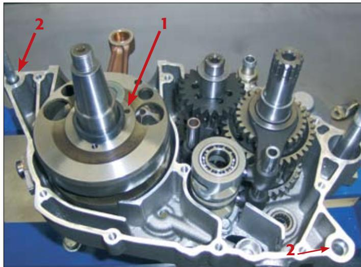
Aplique grasa a la zona del cigüeñal que debe deslizarse en la funda del semicárter izquierdo (1) y coloque la junta central del cárter, cortándola en el área del cilindro (2) para evitar que interfiera con la biela durante el armado del motor.
