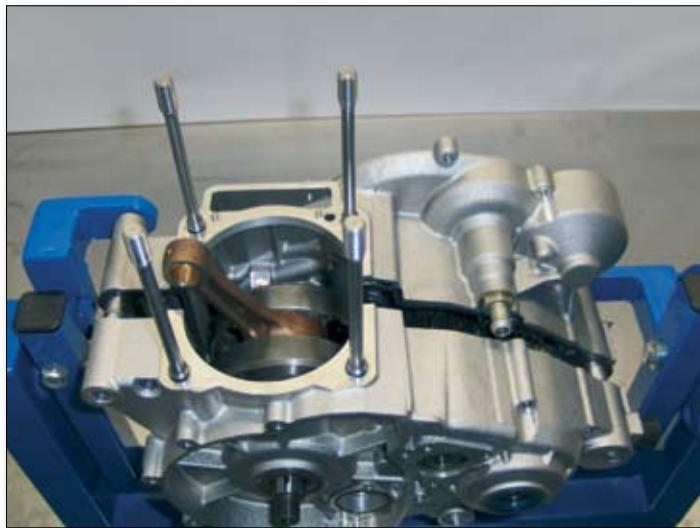
Finalmente atornille el perno situado en el extremo de la herramienta especial hasta que las dos mitades del cárter queden separadas, y saque entonces manualmente el semicárter izquierdo.
