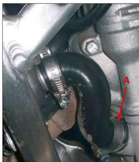
Afloje las abrazaderas que fijan los manguitos del sistema de refrigeración al cilindro (A) y a la bomba de agua (B).
