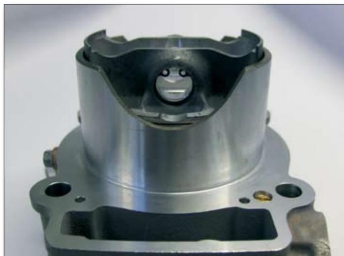
Deslice el cilindro hacia abajo entre los prisioneros hasta que el pie de biela quede alineado con el alojamiento del pasador. A continuación introduzca el pasador desde el lado que aún sigue abierto, y bloquéelo con su anillo elástico, habiendo lubrificado previamente las superficies del propio pasador y su alojamiento.
