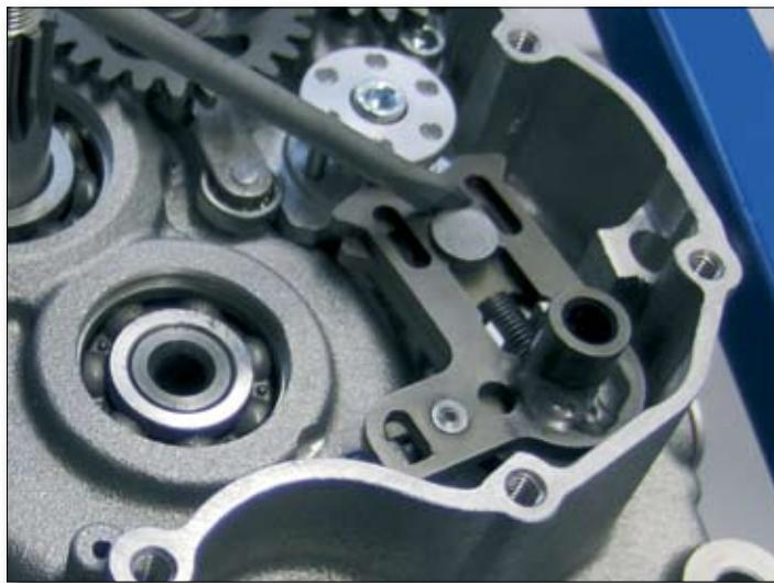
Saque el cigüeñal del mecanismo de cambio de marchas (1), empujando hacia atrás el abanico móvil con un destornillador a fin de evitar que interfiera con la leva de la palanca de cambio de marchas. Tire hacia fuera del engranaje de reenvío (5) junto con su arandela de empuje (4), tras haber retirado primero el anillo elástico de fijación (3).
