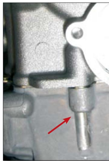
Si necesita sustituir los cojinetes del eje de la bomba de agua, extraiga el cojinete de la parte externa presionándolo con un punzón acolchado hacia el interior del cárter de la distribución hasta que quede liberado por completo. En el caso del cojinete interno, use un martillo deslizante con un extractor interno adecuado.
