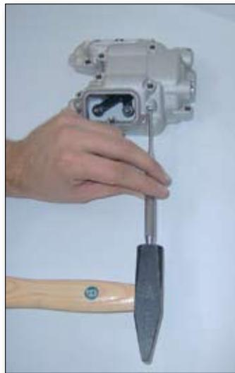
Coloque el balancín lateral de admisión (2) y el balancín lateral de escape (3) tal como se indica en la fotografía, introduciendo las arandelas de empuje 12x17x0,5 (7) entre los balancines y la cubierta de la cabeza, tras haberlos lubrificado abundantemente con aceite de motor.
