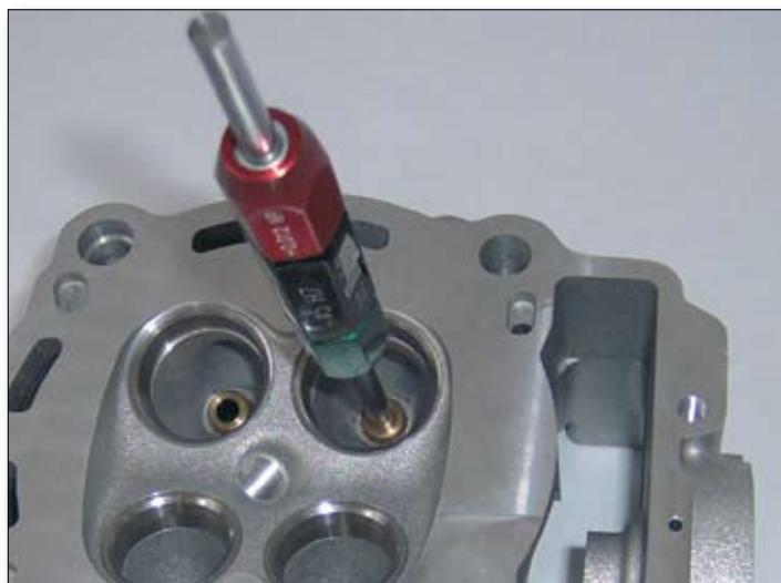
Compruebe el juego del tubo de la válvula/guía de la válvula. Para ello, sitúe la válvula en su guía con la superficie superior del tubo de la válvula alineada con la guía, y mida la oscilación radial máxima de la cabeza de la válvula.
