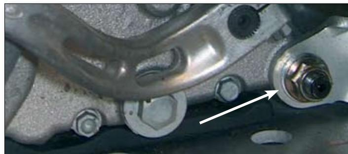
Afloje la tuerca que fija el perno de montaje del motor/bastidor inferior.
