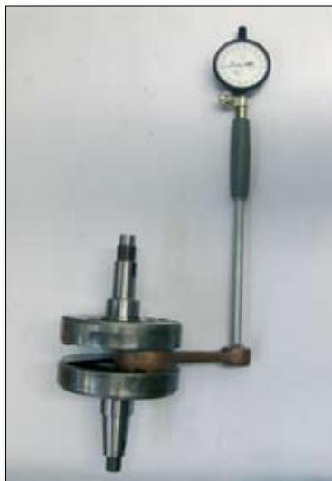
Mida el diámetro interno del pie de biela y determine el juego con el pasador. Si el juego sobrepasa el límite (con el diámetro del pasador dentro de los límites indicados), sustituya la biela.
