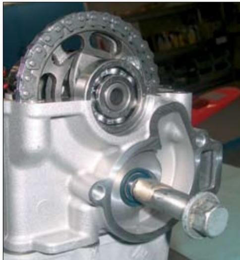
Atornille el eje de la bomba de agua (6) en el engranaje (5) (que está bloqueado por la cadena de distribución) usando la herramienta especial adecuada.
