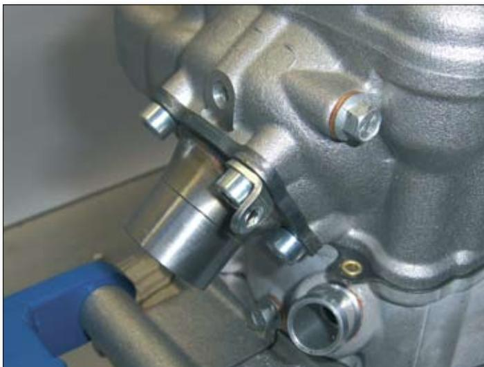
Coloque el desvío de escape (12) con cuatro tornillos M6x15 (14) apretados a 10 Nm. Bajo las cabezas de los tornillos, coloque las dos placas (13) para anclar los muelles del soporte del colector de escape. Estas placas se colocan en los pernos de la parte superior derecha y la parte inferior izquierda, mirando hacia el motor desde la parte delantera (lado de escape).
