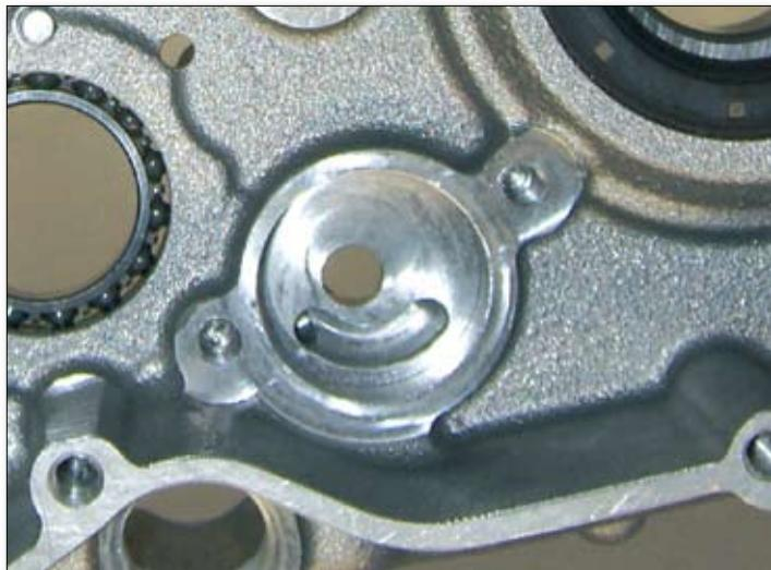
Coloque la funda del cigüeñal (12), lubrificando su superficie externa con grasa para facilitar la inserción en su alojamiento. Ejerza presión sobre ella hasta que quede alineada, con la cara abierta mirando hacia dentro.
