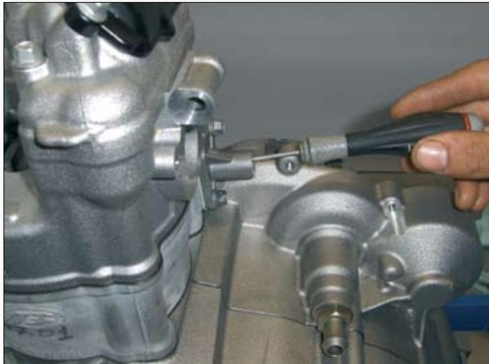
Coloque el cuerpo del tensor y su junta, sujetándolo con pernos M6x16 apretados a 8 Nm. Use un destornillador para empujar el émbolo de modo que tense la cadena de distribución. Seguidamente introduzca el muelle y la arandela y, por último, atornille el perno.
