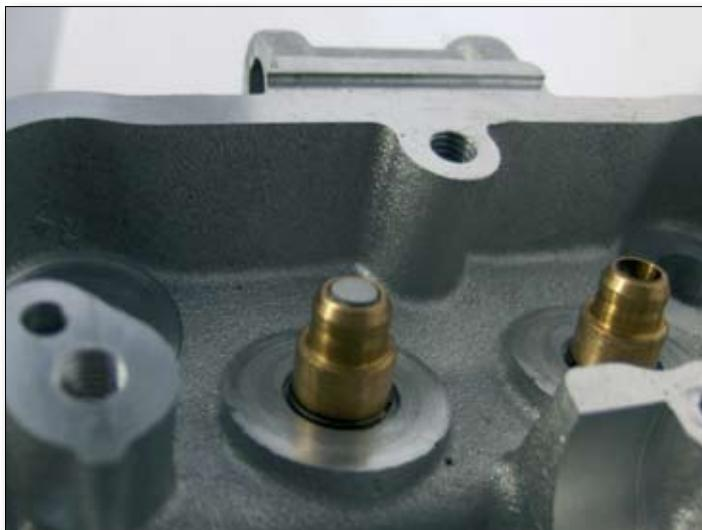
de los asientos de las válvulas. Para ello, aplique una fina capa de pigmento azul de Prusia al área de contacto de la válvula con el asiento. Seguidamente introduzca la válvula en la guía hasta que quede presionando el asiento, y gírela con respecto a su eje. Al retirar la válvula, el pigmento no estará en el área de contacto. El ancho del área de contacto debe estar entre los siguientes límites:
