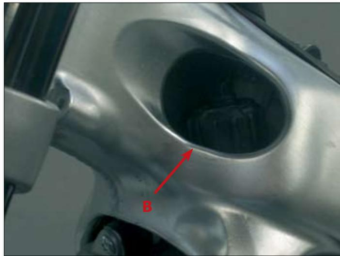
Seguidamente abra el tapón del radiador (B) para permitir que salga todo el líquido del sistema.
