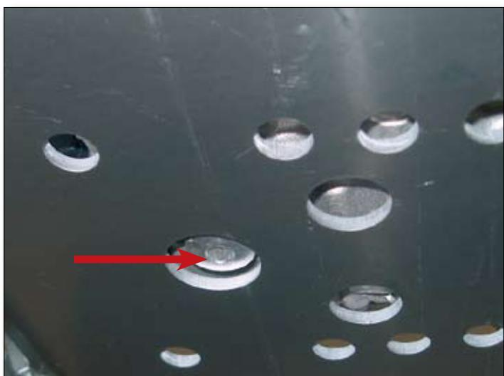
Desatornille el tapón para el escape de aceite y drene todo el aceite en un recipiente de drenaje. Limpie en profundidad el magneto del tapón para el escape de aceite a fin de eliminar las impurezas metálicas que haya recogido.
