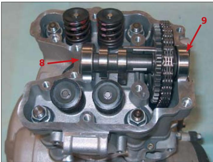
Pase la cadena de distribución alrededor del piñón del árbol de levas, y coloque en el árbol de levas, por este orden, la caja de rodillos sellada (8) y la caja de rodillos del lado de la cadena (9).
