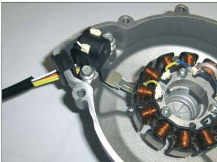
Coloque el estátor (3) en la cubierta del volante (2), sujetándolo con tres tornillos M5x25 (4). Apriete los tornillos a 6 Nm. Procure que la placa guía del cable del estátor quede mirando hacia el interior de la cubierta.
