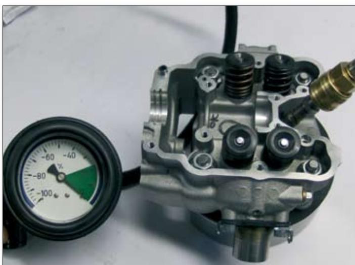
Usando un probador adecuado, compruebe el correcto sellado de las válvulas una vez armada la cabeza del cilindro.
