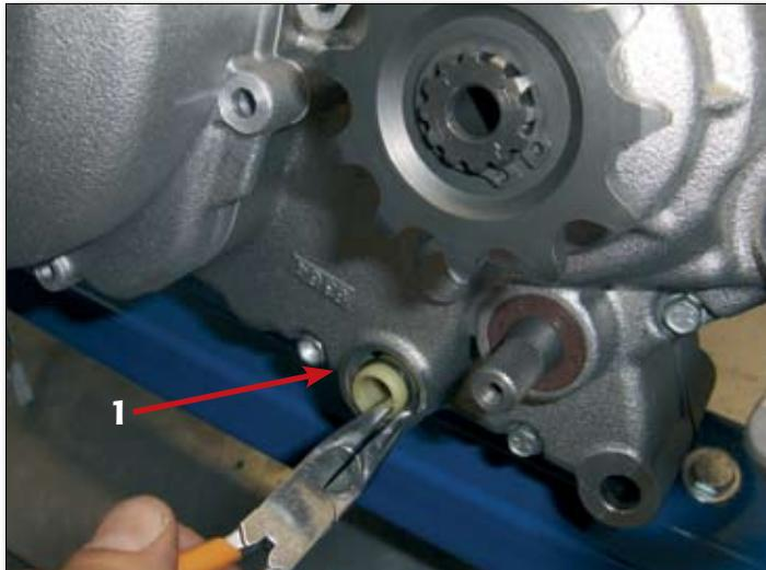
Saque los filtros de aceite del semicárter izquierdo (1) y el semicárter derecho (2) tras haber retirado primero las cubiertas de los filtros.
