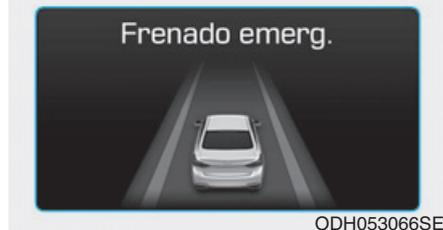
Cuando sea necesario accionar el pedal del freno o el volante debido a una frenada brusca o a una distancia insuficiente con respecto al vehículo que le precede aparecerá un mensaje de advertencia y sonará una señal acústica. Los mensajes de advertencia varían según la gravedad de la situación. Reduzca inmediatamente la velocidad para evitar una colisión.
