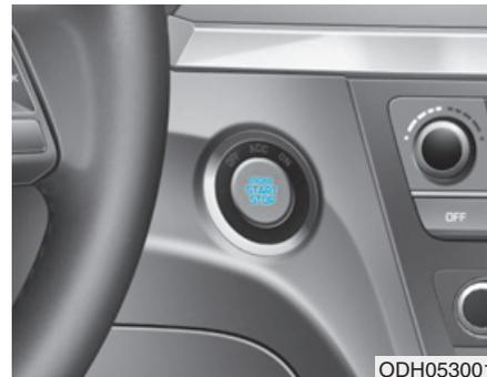
Quando la puerta delantera está abierta, el botón Start/Stop del motor se ilumina y se apaga 30 segundos después de cerrar la puerta.
