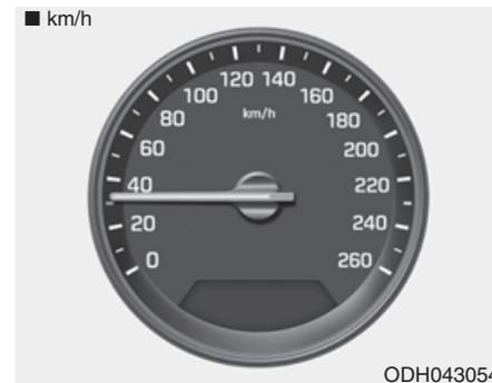
El velocímetro indica la velocidad del vehículo y está calibrado a kilómetros por hora (km/h).
