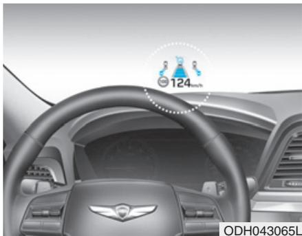
La pantalla superior es una pantalla transparente mediante la cual se proyecta información del tablero de instrumentos y del sistema de navegación en el parabrisas.
