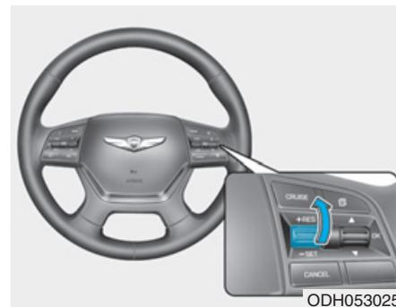
Si se utilizó otro método distinto a la palanca CRUISE para cancelar la velocidad de cruceo y el sistema sigue activo, la última velocidad ajustada se recuperará automáticamente cuando pulse la palanca hacia arriba (RES+) o hacia abajo (SET-).
