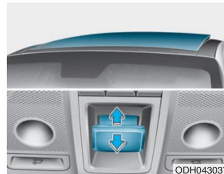
Al empujar la palanca de control del techo solar hacia arriba, el parasol se abrirá completamente y el cristal del techo solar se inclinará.
