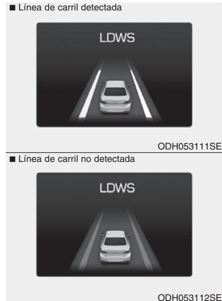
Si el sistema detecta que el vehículo se sale del carril con el LDWS accionado y una velocidad del vehículo superior a 60km/h, la advertencia funciona como sigue:
