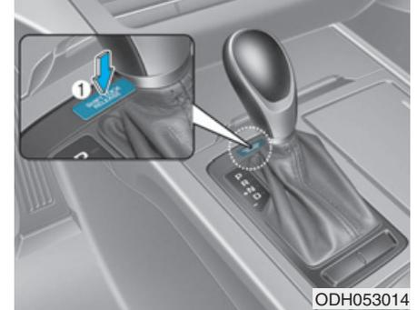
Si no puede mover la palanca de cambio de la posición P (estacionamiento) a la posición R (marcha atrás) con el pedal del freno pisado, siga pisando el pedal del freno y a continuación haga lo siguiente:
