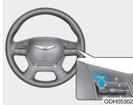
Pulse el botón CRUISE (el testigo indicador CRUISE se apaga).
