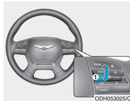
Empuje la palanca (1) hacia arriba (RES+). Si la velocidad del vehículo es superior a 40 km/h, el vehículo recuperará la velocidad preajustada.
