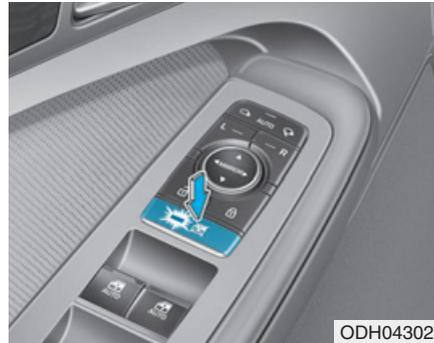
El conductor puede desactivar los interruptores de los elevallas eléctricos de las puertas de los pasajeros traseros pulsando el interruptor de bloqueo del elevallas eléctrico. Se iluminará el indicador.
