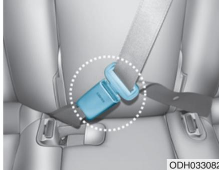
Si se utiliza el cinturón de seguridad trasero central, debe hacerse uso de la hebilla con la marca "CENTER".
