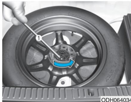
Si resulta difícil aflojar el perno de palomilla de fijación de la rueda con la mano, podrá aflojarlo más fácilmente usando la manivela del gato.
