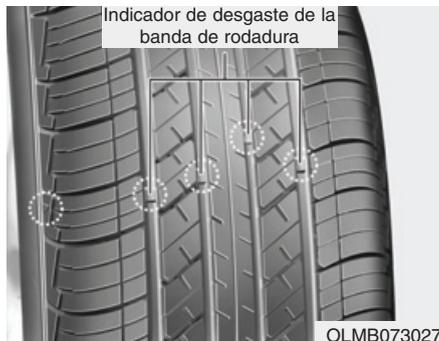
Si el neumático está desgastado de manera uniforme, el indicador del desgaste de la banda de rodadura aparecerá como una banda sólida a lo largo de la banda de rodadura. Esto indica que queda una banda de rodadura en el neumático inferior a 1,6 mm. Reemplace el neumático cuando esto ocurra.
