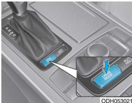
El modo de conducción puede seleccionarse según las preferencias del conductor o las condiciones de la carretera.
