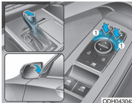
Cuando coloca la palanca de cambios en R (marcha atrás), el(los) retrovisor(es) exterior(es) se girará(n) hacia abajo para facilitar el estacionamiento marcha atrás. La posición del interruptor del retrovisor exterior (1) determina si los retrovisores se mueven:
