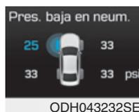
**Indicador de la posición del neumático con presión baja e indicador de la presión de los neumáticos**
