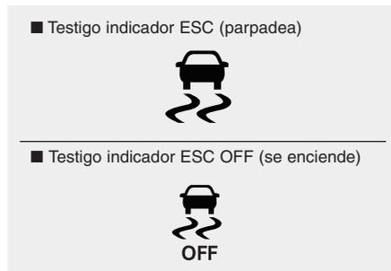
Si el botón Start/Stop del motor se pulsa a ON, el testigo indicador ESC se ilumina, después se apaga si el sistema ESC funciona con normalidad.
