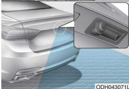
La cámara de visión trasera se activa cuando el motor está en marcha y la palanca de cambio está en la posición R (marcha atrás).
