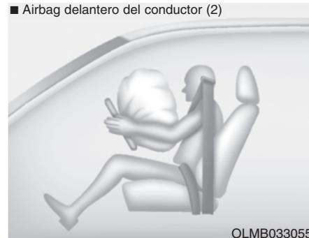
Una vez desplegado, las costuras moldeadas directamente en las cubiertas del panel se separarán por la presión de la expansión del airbag. Esta mayor apertura de las cubiertas es lo que permite el completo inflado de los airbags.
