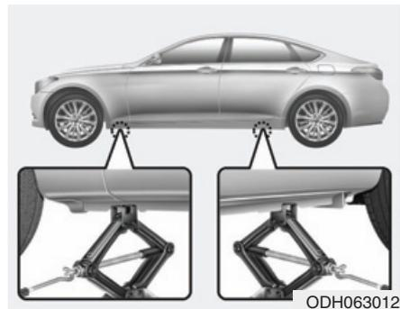
8. Sitúe el gato en la posición designada para el mismo debajo del bastidor junto a la rueda que desea cambiar. Las posiciones para el gato son placas soldadas al bastidor con dos lengüetas y un punto de apoyo. No coloque el gato en ninguna otra posición ni parte del vehículo. Podría dañar la moldura lateral.
