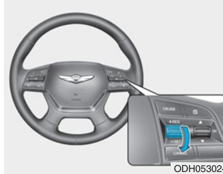
3. Mueva la palanca hacia abajo (SET-) y suéltela a la velocidad deseada. En la pantalla se iluminará la velocidad ajustada y la distancia de vehículo a vehículo.
