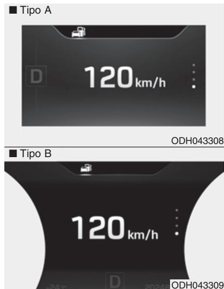
Este mensaje muestra la velocidad del vehículo (km/h, MPH).
