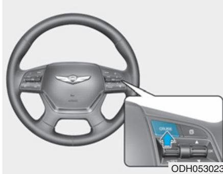
1. Pulse el botón de CRUISE del volante para activar el sistema. El indicador CRUISE se ilumina.
