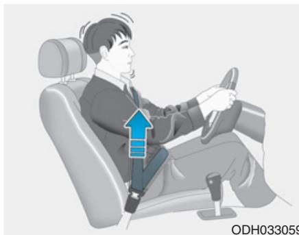
La función del cinturón de seguridad con sistema pre-safe es tensar el cinturón de seguridad al detectar una colisión, durante el frenado de emergencia o cuando se detecte una pérdida de control.
