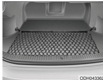
Para evitar que el equipaje se desplace en el maletero, puede utilizar cuatro soportes ubicados en el maletero para colocar una red en el maletero.
