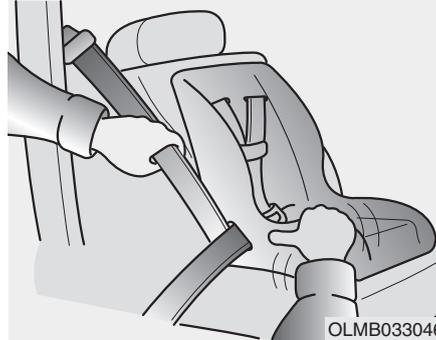
3. Elimine la mayor cantidad de holgura del cinturón como sea posible empujando el sistema de sujeción para niños hacia abajo mientras hace regresar la parte del hombro del cinturón de seguridad al interior del retractor.
