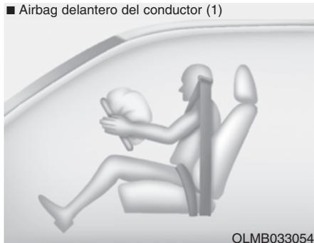
Cuando el SRSCM detecta un impacto fuerte en la parte delantera del vehículo, se desplegarán automáticamente los airbags delanteros.
