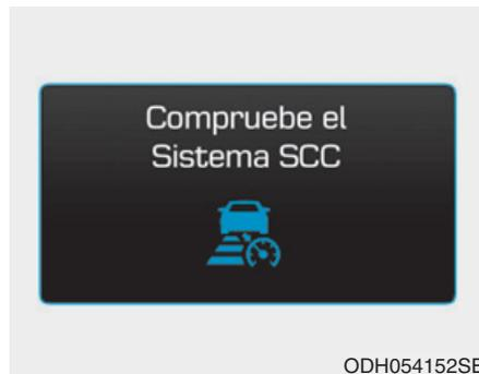
Este mensaje aparece cuando el sistema de control de distancia de vehículo a vehículo no funciona correctamente.
