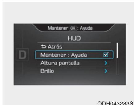
Para activar la pantalla superior, seleccione "HUD" en el "Modo de ajustes del usuario" en el tablero.
