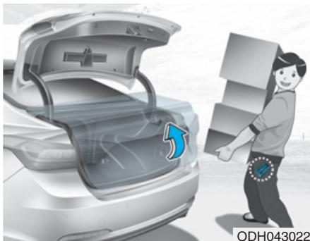
En los vehículos equipados con una llave inteligente, el maletero puede abrirse mediante activación sin contacto usando el sistema del maletero inteligente.
