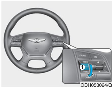
3. Empuje la palanca (1) hacia abajo (SET-) y suéltela. El testigo indicador SET se iluminará.
