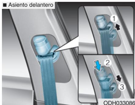
Para ajustar la altura del anclaje del cinturón de seguridad, suba o baje el regulador de altura a la posición adecuada.
