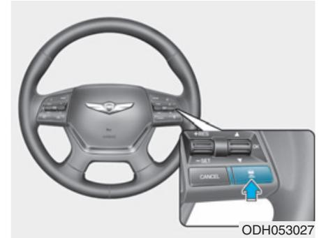
Cuando el sistema del control de crucero inteligente esté activado, puede ajustar y mantener la distancia del vehículo que le precede sin pisar el pedal del acelerador o del freno.
