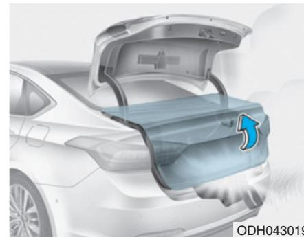
Si un objeto o una parte del cuerpo bloquea la apertura o el cierre automático de la puerta del maletero, la puerta automática del maletero detectará la resistencia y detendrá el movimiento o se moverá a la posición de apertura completa para poder retirar el objeto.
