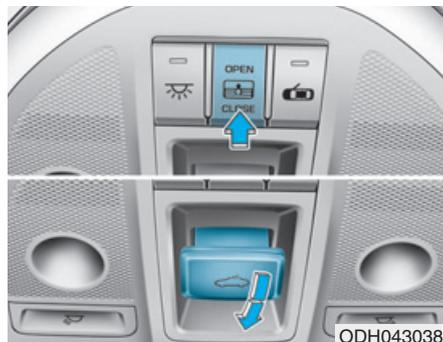
Pulse el botón CLOSE del parasol. El cristal del techo solar se cerrará y el parasol se cerrará. Para detener el movimiento del techo solar en algún punto, pulse brevemente el interruptor de control del parasol.
