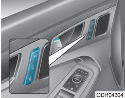
El sistema de memoria de la posición del conductor se ha equipado para almacenar y recuperar los siguientes ajustes con una simple operación de un botón.
