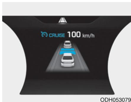
En este modo se visualiza el estado del control de cruceo inteligente avanzado (ASCC), del sistema de aviso de salida del carril (LDWS) y del sistema de ayuda de permanencia en el carril.
