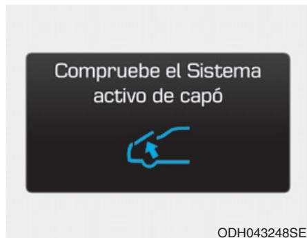
En caso de producirse un problema en el sistema, aparecerá un mensaje en la pantalla LCD del tablero. Este mensaje de advertencia significa que la protección de los peatones mediante el sistema de elevación activa del capó no funciona correctamente.
