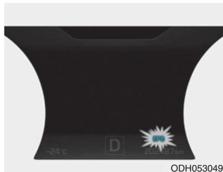
El testigo de advertencia se ilumina si el botón Start/Stop del motor se cambia a la posición ON y se apaga aprox. después de 3 segundos si el sistema funciona correctamente.
