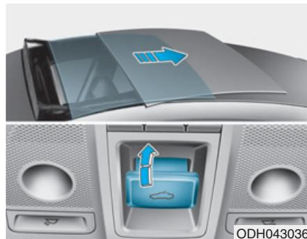
Al tirar de la palanca de control del techo solar hacia atrás, el parasol se abrirá completamente y el cristal del techo solar se abrirá también completamente. Para detener el movimiento del techo solar en algún punto, tire o empuje la palanca de control del techo solar brevemente.
