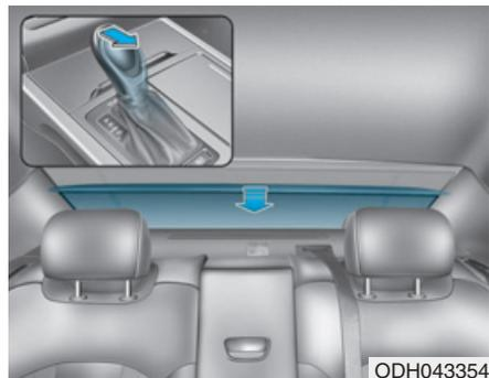
La cortina trasera bajará automáticamente cuando mueva la palanca de cambios a R (marcha atrás) y subirá automáticamente cuando mueva la palanca de cambios de R (marcha atrás) a P (estacionamiento).
