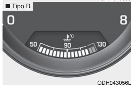
Este indicador muestra la temperatura del refrigerante del motor cuando el botón Start/Stop del motor está en ON.
