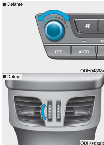
2. Gire el mando de control de temperatura para ajustar la temperatura deseada.
