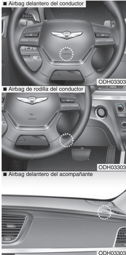
El propósito del SRS es el de suministrar una protección adicional al conductor del vehículo y al acompañante más allá de la que ofrece el sistema del cinturón de seguridad en caso de un impacto frontal con la suficiente gravedad.
