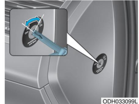
El objetivo del interruptor es desactivar el airbag delantero del acompañante para transportar a ocupantes con gran riesgo de sufrir lesiones relacionadas con el despliegue del airbag debido a su edad, tamaño o condición de salud.
