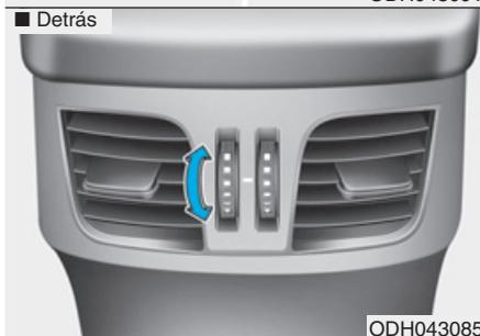
Gire el mando de control de temperatura para ajustar la temperatura deseada.
