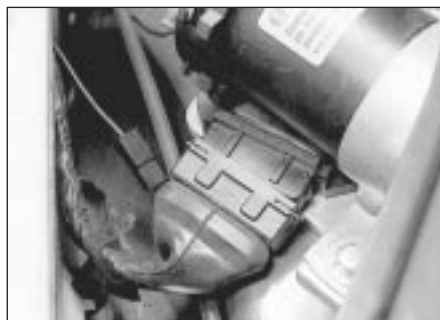
6.3 Ignition module wiring plug
