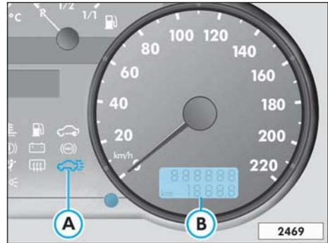
El indicador de límite de velocidad, tiene la función de indicar al conductor a través de un testigo de advertencia **(A)** y una señal sonora, cuando el vehículo atinge una velocidad memorizada. **Para algunos mercados esta velocidad está limitada en 120 Km/h y el conductor no puede modificarla.**
