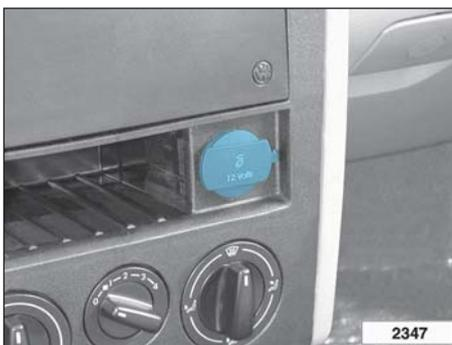
La toma de corriente de 12 V\*, también se puede utilizar para cualquier otro accesorio eléctrico con absorción de potencia de hasta 120 vatios. Con el motor parado, sin embargo, se irá descargando la batería. Para más información, véase el capítulo "Accesorios".
