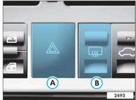
El conmutador de los intermitentes de emergencia (A) lleva un triángulo.
