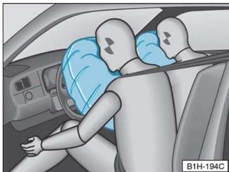
Cuando se activa el sistema, las bolsas se inflan con gas y se despliegan delante del conductor y acompañante.
