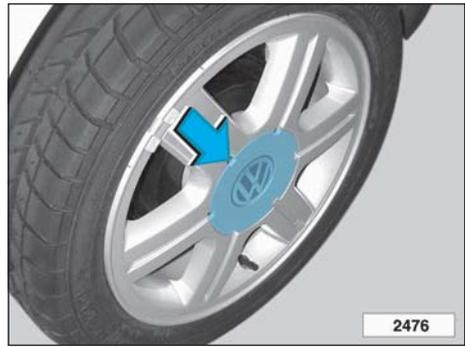
Para montar el **embellecedor integral** de rueda hay que oprimir primero el lado donde se encuentra el hueco para la válvula y después encajar correctamente el resto (figura arriba).
