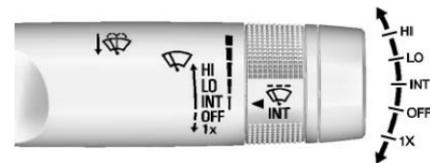
La palanca del limpiador/lavador del parabrisas está en el lado derecho de la columna de dirección.
