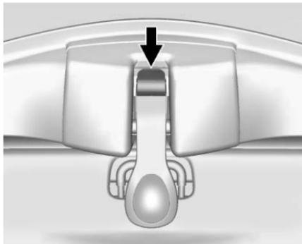
7. Oprima el botón en la parte frontal de la manija de apertura trasera para desbloquearla. Se abrirá la palanca del pestillo.
