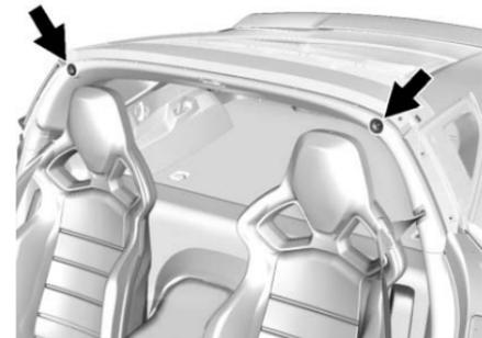
5. Posicione el borde inferior del panel de techo al lado de la cinta aislante de la parte trasera de la abertura del techo. Luego alinee y acomode los pernos de la parte trasera del panel de techo dentro de las aberturas de la cinta aislante de la parte superior trasera. Baje suavemente el borde frontal del panel de techo a la parte frontal de la abertura del techo.
