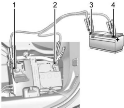
1. Terminal positiva (+) de batería descargada
