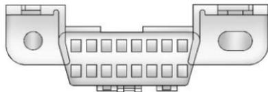
El DLC está debajo del tablero de instrumentos del lado izquierdo del volante. Conectar dispositivos que no se utilicen para realizar una Inspección de emisiones/Prueba de mantenimiento o para dar servicio al vehículo puede afectar la operación
