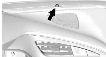
Hay un sensor de luz en la parte superior del tablero de instrumentos. No cubra el sensor,
