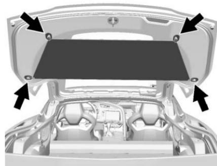
Una los lazos elásticos en las cuatro esquinas de la cubierta de carga a los ganchos en las esquinas delanteras y traseras de la cajuela.
