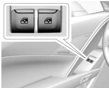
Las ventanas funcionan cuando el vehículo se encuentra en ON/RUN (encendido/operación), ACC/ACCESSORY (accesorios), o en Energía retenida para accesorios (RAP). Consulte *Energía retenida para los accesorios (RAP)* ⇨ 215.
