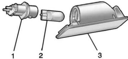
3. Haga girar el receptáculo del foco (1) en sentido contrario a las manecillas del reloj para retirarlo del ensamble de la luz (3).
