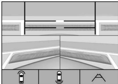
Si está instalada, se muestra una vista del área delante del vehículo en la pantalla de la columna central. La pantalla muestra una vista frontal, de arriba hacia abajo en la parte superior e imágenes de la cámara frontal izquierda y derecha en la parte inferior.
