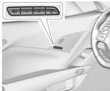
Si están instalados, los botones 1, 2, SET, y
