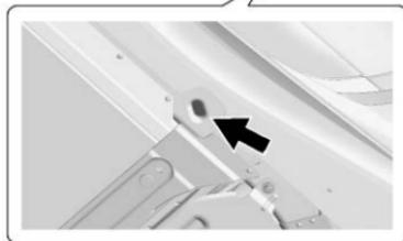
Use únicamente un gato de servicio con un diámetro de almohadilla de elevación de 64 mm (2.5 pulg) o más pequeño, y suficientemente grueso para asegurarse de que el gato no toque la carrocería del vehículo.
