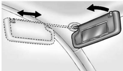
Tire de la visera hacia abajo para bloquear el resplandor. Desconecte la visera del montaje central para pivotarlo a la ventana lateral o, si está equipado, para extenderlo a lo largo de la varilla.
