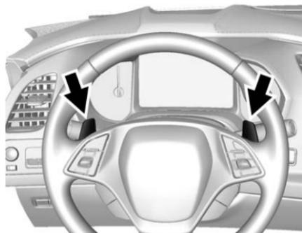
Cuando se mueve la palanca de cambios a M (Modo manual), la transmisión entra al modo manual. La transmisión mantendrá la velocidad actual hasta que se pida un cambio. Las paletas en el volante se pueden usar para hacer un cambio ascendente o descendente a la transmisión. La paleta derecha (+) más hace cambios ascendentes, y la paleta izquierda (-) menos hace cambios descendentes.
