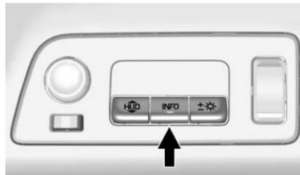
El control del HUD está al lado izquierdo del volante en el tablero de instrumentos.
