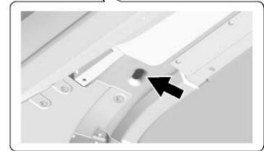
Use únicamente un gato de servicio con un diámetro de almohadilla de elevación de 64 mm (2.5 pulg) o más pequeño, y suficientemente grueso para asegurarse de que el gato no toque la carrocería del vehículo.
