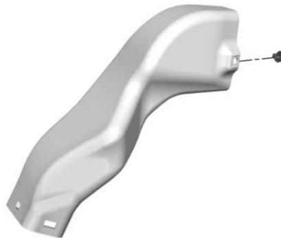
7. Coloque la tuerca U sobre el ducto superior.
