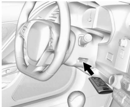
1. Coloque el transmisor en la cavidad del transmisor en la columna de dirección con los botones hacia arriba y la parte inferior del transmisor hacia el lado del pasajero.
