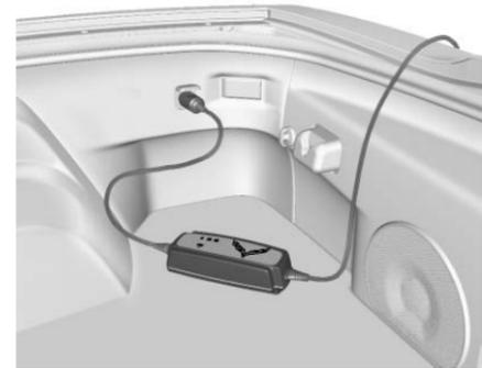
Algunos vehículos tienen un paquete de mantenedor de batería. Siga las instrucciones indicadas en el paquete de mantenedor de batería para mantener la batería cargada cuando el vehículo no esté en uso. Conecte el mantenedor de la batería únicamente a la toma de corriente de accesorios trasera. El tomacorriente delantero se apaga después que se apaga la ignición.
