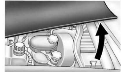
2. Vaya al costado del vehículo y tire hacia arriba del borde trasero del cofre, cerca del parabrisas.
