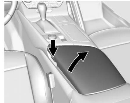
Para abrir, presione el botón del lado del conductor.
