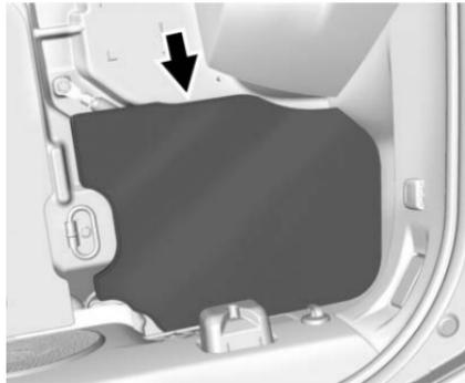
5. Retire la argolla izquierda para la cubierta de carga, después retire la cubierta de la batería y localice las terminales positiva (+) y negativa (-).
