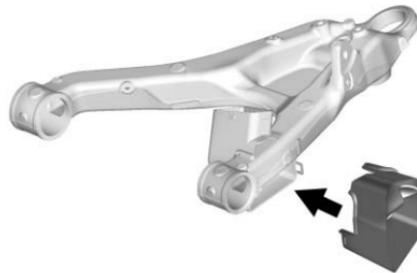
8. Coloque la caja de aire trasera y conecte las lengüetas dentro de la caja de aire delantera alrededor del brazo de control inferior.
