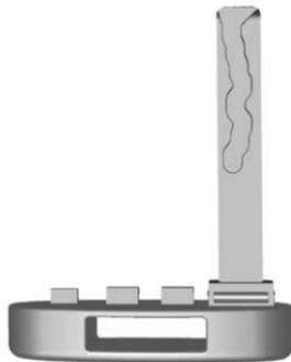
La llave dentro del transmisor RKE se puede utilizar para abrir el vehículo y la puerta trasera/cajuela
