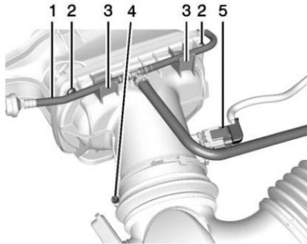
1. Manguera del depósito de recuperación del refrigerante
