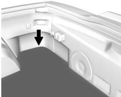
4. Abra la puerta trasera/cajuela y levante la alfombra en el lado del pasajero del vehículo para obtener acceso a la cubierta de la batería.
