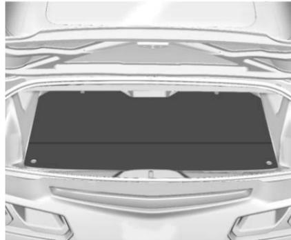
Con el techo convertible arriba, la partición de la cajuela se puede desprender y colocar completamente en el piso para aumentar el espacio de carga de la cajuela.
