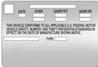
En el borde trasero de la puerta del conductor se encuentra pegada una etiqueta de certificación específica del vehículo. Puede mostrar la capacidad de peso bruto de su vehículo, llamada Clasificación de peso bruto del vehículo (GVWR). La GVWR incluye el
