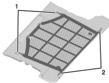
Si está equipado, desdoble la red de carga y sujete los ganchos delanteros (1) a los amarres delanteros en el área de carga. Jale la red sobre cualquier artículo cargado sobre el piso y sujete los ganchos traseros (2) a los amarres traseros.
