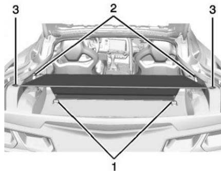
1. Una los lazos elásticos de la cubierta a los amarres en el piso (1) y en los paneles laterales (2).
