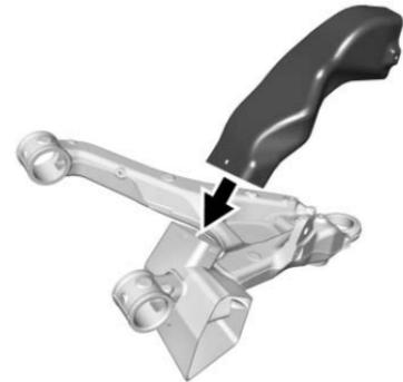
9. Coloque el ducto superior y conéctelo dentro de las lengüetas del ensamble de la caja de aire delantera y trasera.
