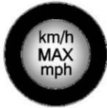
16. Si fue posible inflar la llanta desinflada a la presión de inflado recomendada, retire la etiqueta de velocidad máxima del recipiente de sellador (5) y colóquela en un sitio muy visible. No exceda la velocidad en esta etiqueta hasta que la llanta dañada sea reparada o sustituida.
