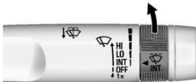
**INT** : Mueva la palanca hasta INT para intervalos intermitentes, y luego gire la banda
