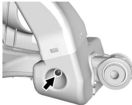
12. Instale los dos tornillos autoroscantes al brazo de control a través de ambos lados de las cavidades de la caja de aire. No apriete en este momento.
