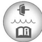
El tapón del depósito del fluido del embrague hidráulico tiene este símbolo. Vea en *Vista general del compartimiento del motor* ⇨ 262 la ubicación del depósito.
