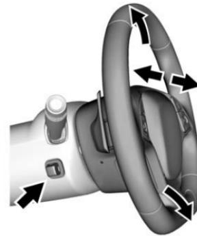
Presione el control para mover el volante de dirección con inclinación y telescópico hacia arriba y hacia abajo o hacia adelante y hacia atrás.
