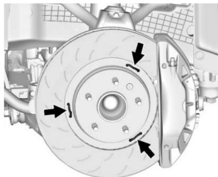
5. Coloque el cable en forma de U a través de los orificios en el anillo de enfriamiento del rotor.
