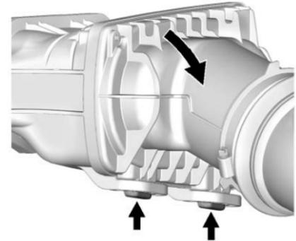
5. Gire la tapa del depurador/filtro de aire y desenganche las lengüetas de montaje de la tapa de extremo inferior de los accesorios de la bisagra de retención inferior. Asegúrese de insertar las lengüetas de montaje de la tapa de extremo inferior completamente en los accesorios de bisagra de retención de la carcasa antes de girar la tapa hacia arriba y volver a colocar los tornillos.
