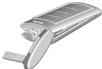
2. Use la base ovalada de la parte plana de la llave para abrir las dos partes del transmisor.
