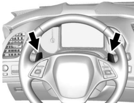
El sistema de Paleta para cambio manual se puede utilizar en D (Conducir) o M (Modo manual). El sistema se activa presionando la paleta izquierda para cambio descendente y la paleta derecha para cambio ascendente. La velocidad actual se mostrará en el grupo de instrumentos, o en la Pantalla superior (HUD), si está equipado.
