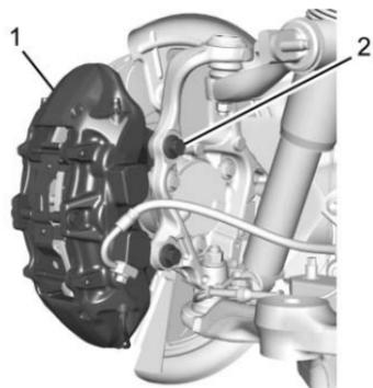
9. Instale el calibrador (1) con los dos sujetadores (2). Apriete a 120 N•m (89 lbs pie).
