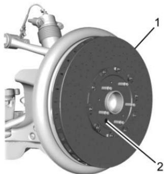
8. Instale el rotor (1) con el sujetador (2). Apriete a 10 N•m (89 lbs pulg.).
