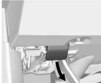
1. Jale la palanca de liberación del cofre dentro del vehículo. Se encuentra debajo del panel de instrumentos en el lado del conductor.
