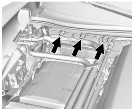
1. Suelte los ganchos sujetadores de la cubierta del filtro de aire del compartimiento del pasajero. Puede ser necesario sujetar brevemente las mangueras de PVC a un lado
