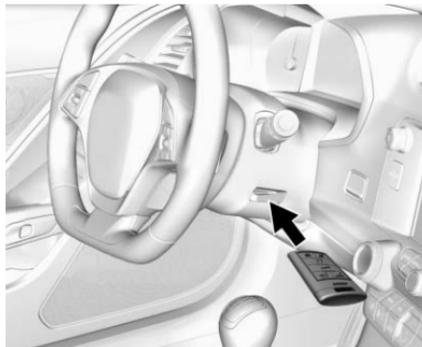
7. Coloque el nuevo transmisor en la cavidad del transmisor en la columna de dirección con los botones hacia arriba y la parte inferior del transmisor hacia el lado del pasajero.
