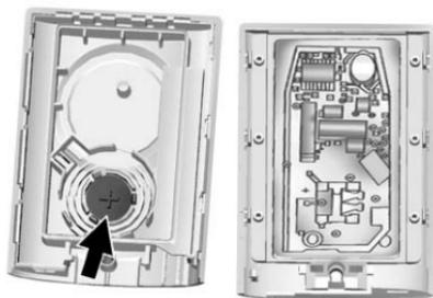
3. Retire la batería vieja. No utilice un objeto metálico.
