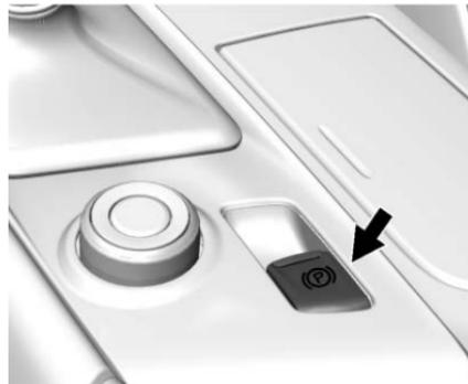
El vehículo cuenta con un Freno de estacionamiento eléctrico (EPB). El interruptor está en la consola central. El EPB siempre puede activarse, incluso con la ignición en la posición de apagado. Para
