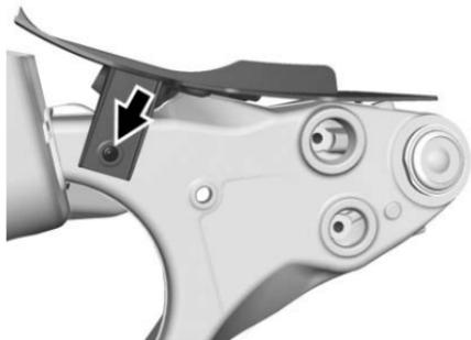
10. Instale el deflector del brazo de control al ducto superior con el tornillo. No apriete en este momento.
