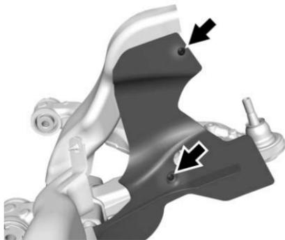
11. Instale el deflector del brazo de control al brazo de control inferior usando los tornillos autoroscantes. No apriete en este momento.
