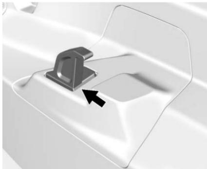
2. Inserte el frente del panel de techo para que las pestañas queden sobre los receptores.
