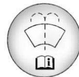
Abra el tapón que tiene el símbolo del lavaparabrisas. Agregue líquido para lavaparabrisas hasta llenar el tanque. Vea *Vista general del compartimiento del motor* ⇨ 262.
