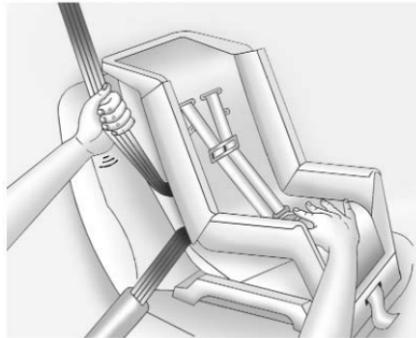
6. Para apretar el cinturón, empuje hacia abajo el asiento de seguridad para niños, jale la porción del hombro del cinturón para apretar la porción de la cintura del cinturón, y regrese el cinturón de hombro dentro del retractor. Cuando instale un asiento con retención infantil que vea hacia delante, puede ser útil usar su rodilla para empujar el asiento con retención infantil mientras aprieta el cinturón.
