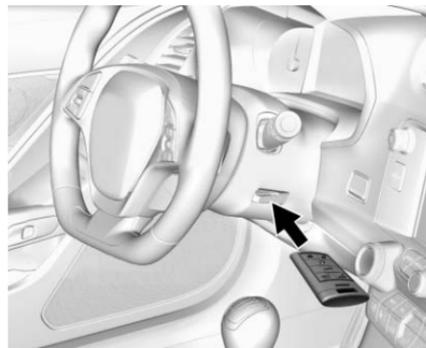
8. Coloque el nuevo transmisor en la cavidad del transmisor en la columna de dirección con los botones hacia arriba y la parte inferior del transmisor hacia el lado del pasajero.
