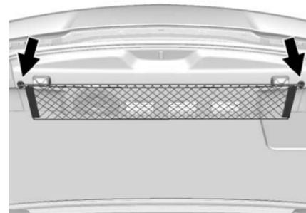
El vehículo puede tener una red de comodidad que se puede usar para cargas pequeñas. Una la red a los ganchos en la parte trasera del compartimento. La red no debe usarse para almacenar cargas muy pesadas.
