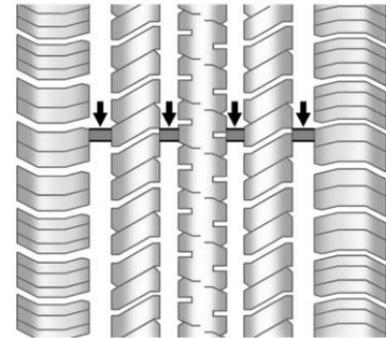
Los indicadores de desgaste del dibujo son una de las maneras de decidir cuándo es el momento para nuevas llantas. Los indicadores de desgaste aparecen cuando las llantas tienen solamente 1.6 mm (1/16 de pulgada) de dibujo
