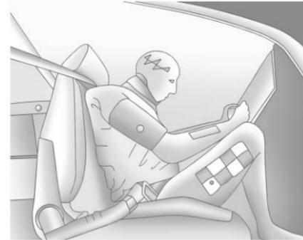
Al ir en el vehículo, usted viaja a la velocidad del mismo. Si algo detiene el vehículo de manera abrupta, usted continuará viajando hasta que algo lo detenga. Podría ser el parabrisas, el tablero de instrumentos o los cinturones de seguridad.
