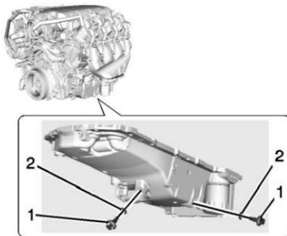
1. Tapones de vaciado del aceite del motor
