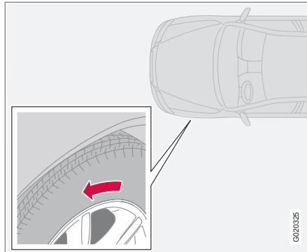
Si los neumáticos se montan de forma incorrecta, empeorarán las características de frenado del automóvil y la capacidad para despejar la lluvia y la nieve.
