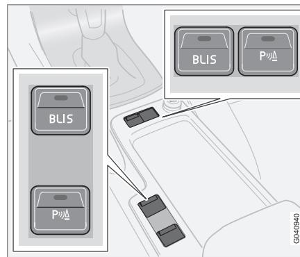
Botón de conexión y desconexión (la posición del botón depende del equipamiento seleccionado).
