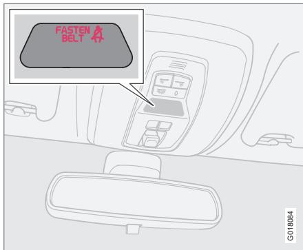
A los ocupantes que no lleven puesto el cinturón de seguridad, se les avisa de que se lo abrochen mediante señales acústicas y luminosas. El aviso acústico depende de la velocidad y en algunos casos del tiempo. La señal luminosa se puede ver en la consola del techo y en el instrumento combinado.
