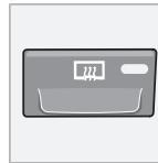
Utilice la función de calefacción eléctrica para hacer desaparecer el hielo y el vaho de la luneta trasera y los retrovisores. Si pulsa el botón una vez, se inicia el calentamiento de la luneta trasera y los retrovisores al mismo tiempo. La luz del botón se enciende para indicar que la función está activa.
