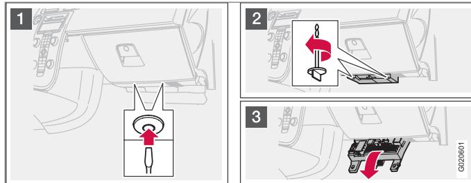
Tiene 50 posiciones de fusibles. Los fusibles están situados debajo de la guantera. También tiene espacio para fusibles de repuesto. La herramienta para el cambio de fusibles está en la caja de fusibles y relés, en el compartimento del motor, ver la página 241.
