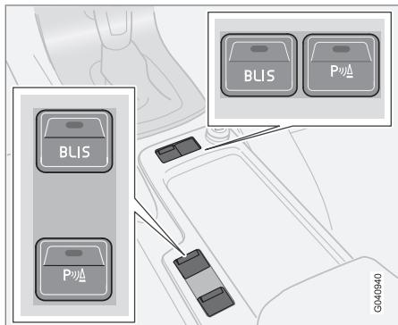
*Botón de conexión y desconexión (la posición del botón depende del equipamiento seleccionado).*
