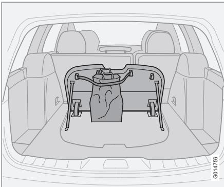
El soporte para bolsas de la compra sujetas las bolsas e impide que vuelquen y que el contenido se esparza por el compartimento para la carga.
