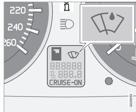
El sensor de lluvia detecta la cantidad de agua que cae sobre el parabrisas y activa los limpiaparabrisas de manera automática. La sensibilidad del sensor de lluvia se ajusta con la rueda (C), ver la página 65.
