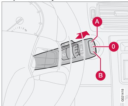
Desplazando la palanca hacia adelante, se inicia el lavado y el barrido de la luneta trasera. La escobilla realiza algunos barridos adiciona-
