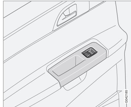
Las ventanillas de las puertas traseras sólo pueden accionarse con los mandos de la puerta respectiva o con el interruptor de la puerta del conductor. Si está encendida la luz del interruptor de bloqueo de los elevalunas traseros (situado en el panel de control de la puerta del conductor), las ventanillas de las puertas traseras sólo pueden accionarse desde la puerta del conductor. Las ventanillas de las puertas traseras se accionan de la misma manera que las de las puertas delanteras.
