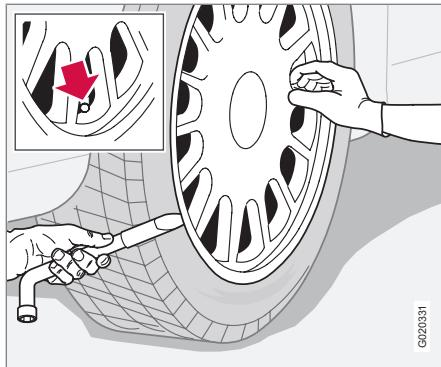
Coloque el triángulo de emergencia en la calzada si necesita cambiar una rueda en un lugar transitado. Asegúrese de que el automóvil y el gato estén sobre una superficie firme y horizontal.
