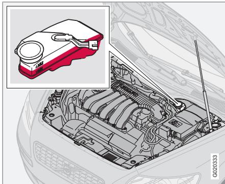
El líquido de freno y embrague tiene un depósito común<sup>3</sup>. El nivel debe estar entre las cotas de **MIN** y **MAX**. Compruebe el nivel de forma periódica. Cambie el líquido de freno cada dos años o cada dos intervalos de servicio programado.
