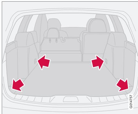
Las anillas de sujeción de la carga se utilizan para fijar las correas o la red con la que se afianzarán los objetos en el compartimento para la carga.
