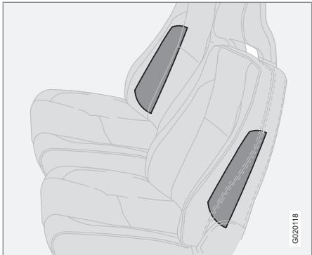
*Colocación de airbag laterales.*
