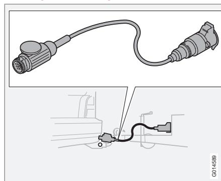
Si el enganche de remolque del automóvil tiene un conector de 13 polos y el remolque tiene un conector de 7 polos, será necesario utilizar un adaptador. Utilice un cable adaptador aprobado por Volvo. Asegúrese de que el cable no arrastre por el suelo.
