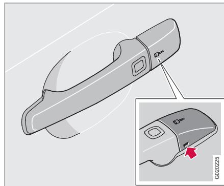
Si no es posible activar el cierre centralizado con el mando a distancia, por ejemplo, si las pilas están gastadas, la puerta del conductor puede abrirse de la siguiente manera:
