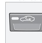
La recirculación impide la entrada de aire contaminado, gases de escape, etc. en el habitáculo. El aire del habitáculo recircula. No entra en el vehículo aire del exterior. Si se selecciona la recirculación (junto con el equipo de aire acondicionado), el habitáculo tarda menos en enfriarse en climas cálidos. Si el aire del automóvil recircula durante mucho tiempo, hay riesgo de que los cristales se empañen.
