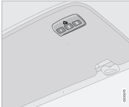
HomeLink® es un mando a distancia programable que puede controlar hasta tres dispositivos diferentes (por ejemplo, la puerta del garaje, el sistema de alarma, la iluminación exterior e interior, etc.) y utilizarse por tanto en lugar de los mandos a distancia correspondientes. El HomeLink se suministra integrado en la visera izquierda.
