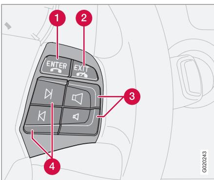
Cuando el teléfono está activado, el teclado del volante sólo controla las funciones de tele-
