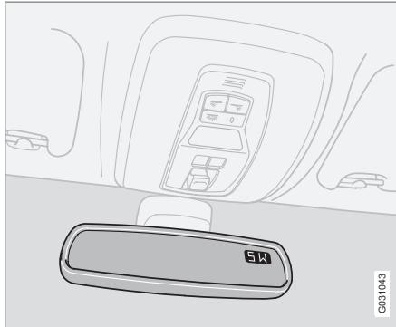
En la esquina superior derecha del retrovisor hay un display que indica el rumbo del automóvil. Pueden aparecer ocho puntos cardinales con abreviaturas en inglés: **N** (norte), **NE** (noroeste), **E** (este), **SE** (sudeste), **S** (sur), **SW** (sudoeste), **W** (oeste) y **NW** (noroeste).
