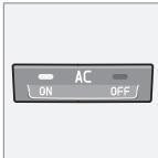
**ON:** El aire acondicionado está conectado. El sistema se regula automáticamente. De esta manera, el aire que entra se enfriá y deshumedece.
