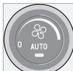
La función **AUTO** regula automáticamente el climatizador para obtener la temperatura seleccionada. La función automática regula la temperatura, el aire acondicionado, la velocidad del ventilador, la recirculación y la distribución del aire.
