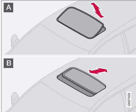
El panel de control del techo solar está situado en el techo. El techo solar puede abrirse en dos posiciones:
