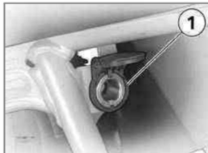
Si la tensión de la batería es muy baja y se supera la capacidad máxima de 5 A, se desconectan automáticamente la caja de enchufe **1** y la caja de enchufe disponible como accesorio opcional.
