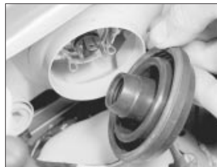
5.2A . . . remove the rubber protector cap . . .
