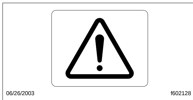
Figura 2.49, Luz indicadora de control de estabilidad de balanceo transversal del tablero
