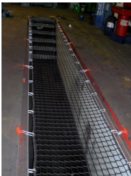
El Secured de Sefac permite cumplir con las exigencias de los servicios de prevención de accidentes en materia de tapar los fosos.
