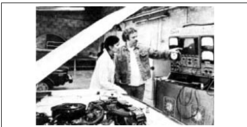
Ejemplo de análisis del motor con un osciloscopio
