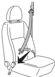
Tire el cinturón de seguridad de manera continua para desenrollarlo. Si tira bruscamente o si el vehículo se encuentra en una pendiente, el cinturón de seguridad puede quedar trabado. Oprima el botón rojo de la hebilla para liberar el cinturón de seguridad. Sostenga la lengüeta y deje que el cinturón de seguridad se enrolle suavemente por completo hasta la posición de guardado.
