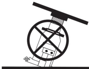
6. Verifique que el vehículo esté sobre suelo firme y nivelado para instalar el crique. No instale el crique en suelo arenoso.
