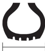
El exceso de presión de inflado en los neumáticos disminuye el área de contacto de la banda de rodaje con la superficie, concentrando todo el peso del vehículo en el centro de la banda de rodaje, provocando el desgaste prematuro de los mismos.
