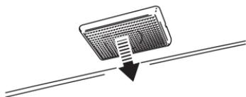
La luz de cortesía puede ser conectada o desconectada desde la perilla del control de iluminación. Para encender la luz, mueva la perilla hasta escuchar un clic.
