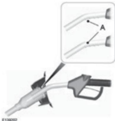
2. Inserte la boquilla del surtidor de combustible hasta la primera muesca de la boquilla A. Manténgala apoyada sobre la cubierta de la abertura del tubo de combustible.
