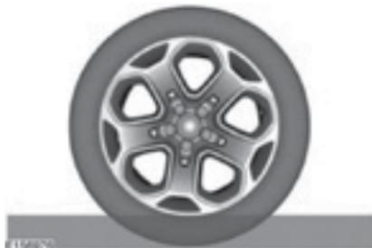
En una emergencia, puede conducir por agua hasta que el agua alcance la parte inferior de la maza de la rueda, si mantiene una velocidad baja constante durante el cruce de hasta 10 km/h. No detenga el vehículo en el agua. Debe tener sumo cuidado cuando conduzca sobre agua en movimiento. Mientras cruza el agua, se deben evitar las olas que se forman delante del vehículo. Estas pueden aumentar e ingresar en la rejilla delantera.
