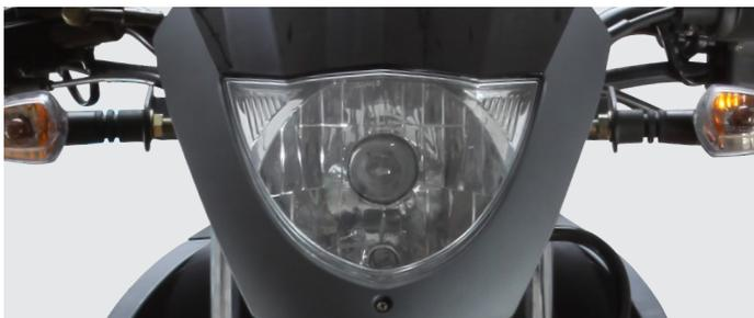
El tornillo de ajuste de la luz principal está ubicado debajo del faro, el que puede ser ajustado de derecha a izquierda con un destornillador de estriadas, para obtener la iluminación apropiada.
