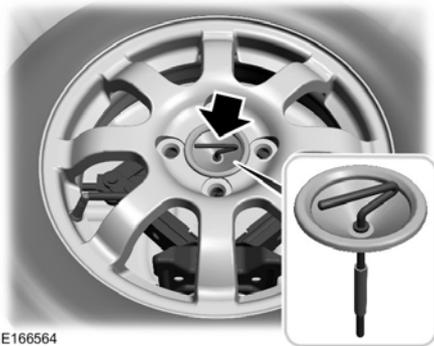
**Nota:** Prenda o pneu sobressalente utilizando o furo direito situado na carroceria do veículo.
