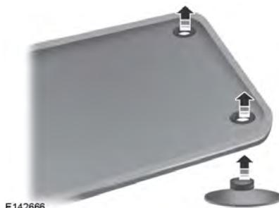
Para instalar os tapetes, posicione o tapete de modo que o orifício fique sobre a haste de retenção e pressione para baixo para travamento.
