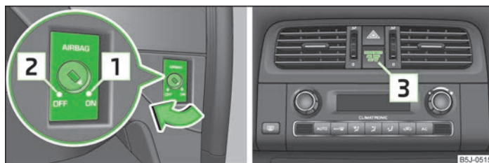
Fig. 106 Conmutador de llave para el airbag lateral del acompañante/Testigo para la desconexión del airbag delantero del acompañante
