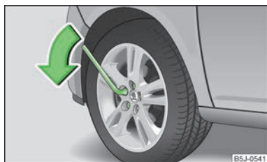
Fig. 133 Cambio de rueda: Aflojar los tornillos de rueda
