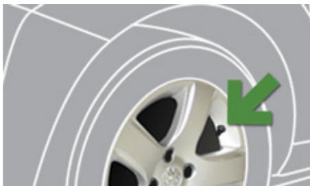
Unos sensores, instalados en cada válvula, disparan una alerta en caso de fallo de funcionamiento (con una velocidad superior a 20 km/h).
