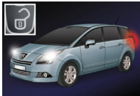
Cuando el sensor detecta que la luminosidad es reducida, el encendido a distancia de las luces de cruce y de posición facilita la llegada al vehículo.
