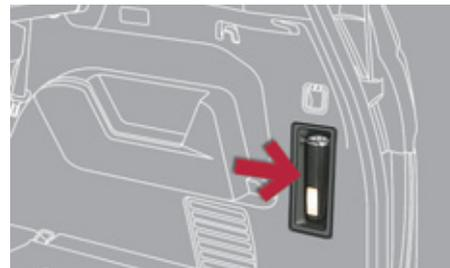
Iluminación amovible, integrada en la pared del maletero, que sirve para iluminar el maletero y como linterna.
