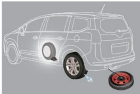
La rueda de repuesto está fijada bajo el vehículo mediante un sistema de torno.
