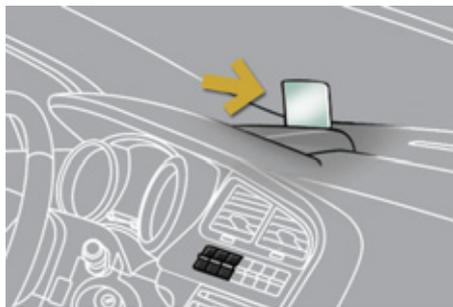
Sistema que proyecta un conjunto de datos en una lámina transparente, en el campo de visión del conductor para que éste no tenga que apartar la vista de la carretera.
