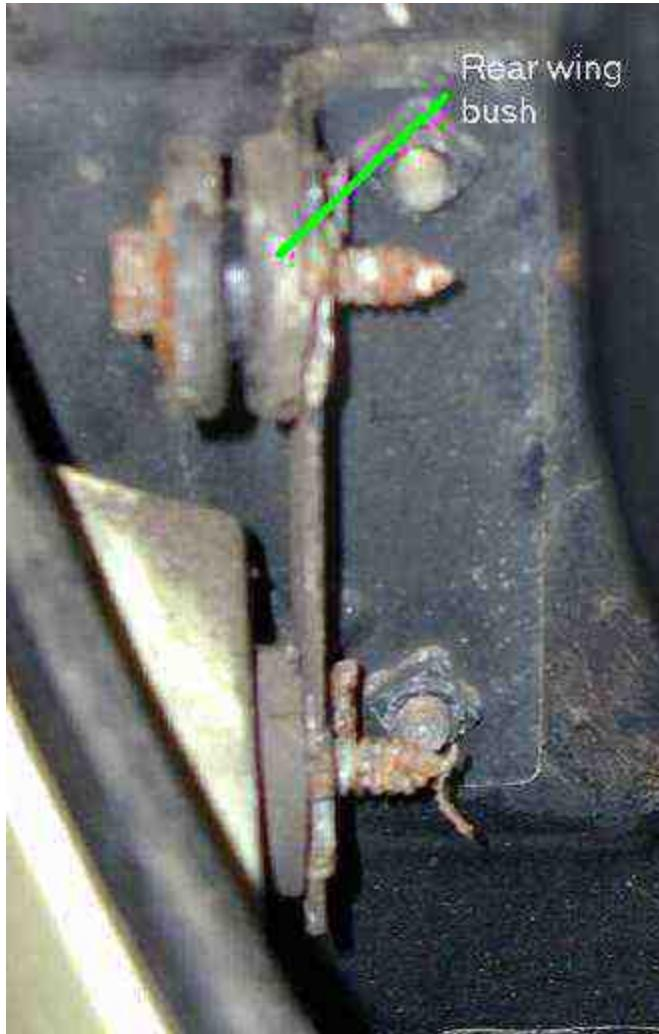
Este es un primer plano de los arbustos de goma utilizados para montar los paneles del cuerpo en la Z1.
