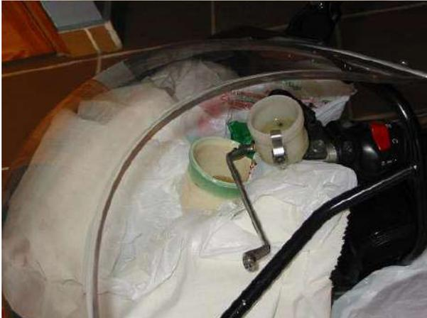
Si tienes una moto con un tercer sangrador en la bomba de freno utiliza este primero; el tiempo de sangrado se reduce notablemente, luego repite la operación con los inferiores hasta que la maneta de freno quede dura. (Sobretudo sobretudo no hagas el merluzo como nosotros y ves a buscar los tubitos o tendrás que empapelar la moto hasta las orejas!!!!).
