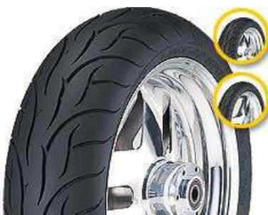
➤ **Dunlop D207 RR:** Se mantiene en catálogo la versión radical del D207, con un dibujo que luego copió el D208. Con un compuesto de goma blanda, tienen un agarre brutal y una agilidad tremenda.
