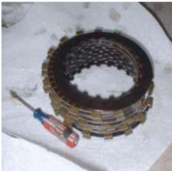
9.- Para volver a montarlo todo, no tienes más que seguir en orden inverso todos los pasos que has realizado hasta ahora: monta los discos (en orden!!! tienen que ir alternados los conductores y los conducidos), el plato de presión, los muelles y sus tornillos. Apriétalos en estrella. Su par de apriete es de 7,86 Nm
