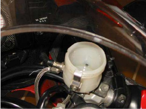
Quita el tapón del depósito de expansión del líquido situado en el manillar derecho (ojo que algunas motos llevan uno en el izquierdo; ese es el del embrague hidráulico) y asegúrate de que no quedan restos. Cierra los sangradores inferiores y llena el depósito con el nuevo líquido. Nosotros hemos utilizado el nuevo DOT 5.1 usado en competición, recomendado por la escudería "Kim Competició" del CEV.
