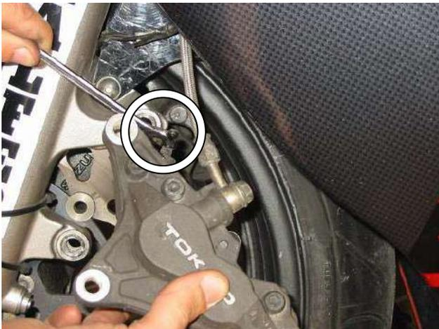
Destapa los sangradores de las pinzas de freno, colócale el tubito de plástico y asegurate de que queda bien ajustado y coloca el recipiente en el extremo inferior del tubo; afloja el sangrador y dale que dale a la maneta/pedal de freno!! Repite esta operación para la otra pinza si dispones de dos discos de freno. Cuidado al vaciarlo, el líquido es corrosivo a tope, si te cae en las llantas utiliza el limpia llantas enseguida, lo mismo reza para los discos de freno.
