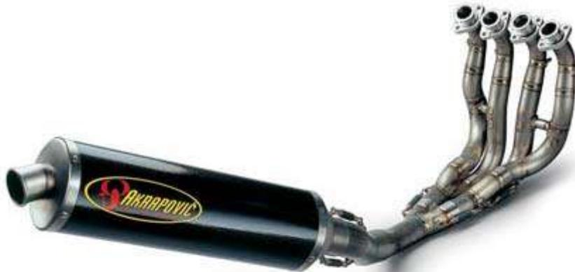
Así, la única forma de comprobar el buen diseño de un tubo es probando el rendimiento del motor en el banco de potencia, después de obtener un reglaje de carburación óptimo. Este detalle es importante, ya que cada tubo, al afectar a la forma en que la moto “respira”, necesita unos reglajes de carburación propios.
