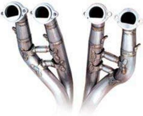
Se supone que si unimos los cilindros contiguos en el orden de explosión (1-4 , 2-3) nos beneficiaremos de mayor potencia en alta, que si unimos los cilindros contiguos físicamente (1-2 , 3-4). Sin embargo, la comunicación de varios colectores mediante el uso de **compensadores**, complican aún más la situación.
