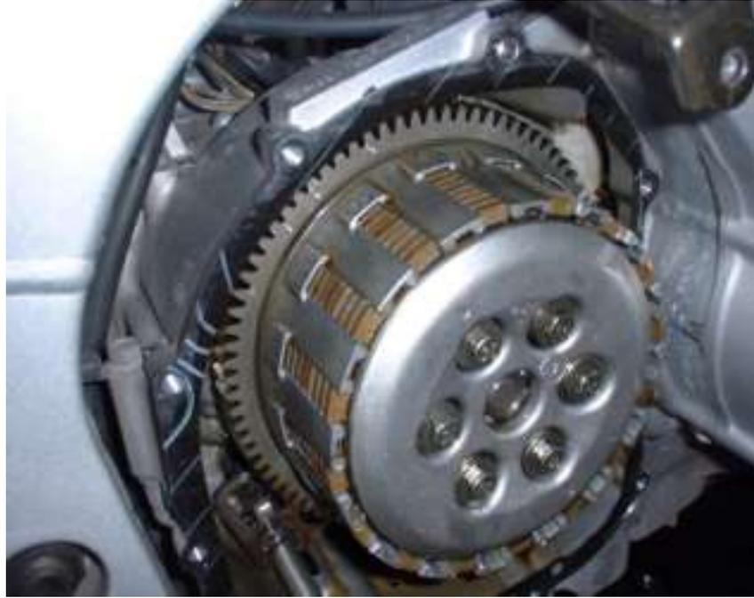
4.- Afloja los tornillos que mantienen comprimidos los muelles del embrague (con la llave de 10mm, no uséis el destornillador, que es frustrante). Has de fijarte bien en qué posición va cada muelle, ya que la YZF lleva muelles de longitudes diferentes (en posiciones alternadas), y debemos recolocarlos en el mismo orden.
