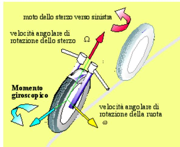
( ángulo di rollio=ángulo de inclinación; velocità angolare di rotazione della ruota=velocidad de giro de la rueda;; rollio verso destra= inclinación a la derecha; velocità angolare di rollio= velocidad angular de inclinación )
