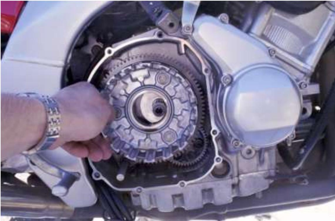
En azul, es la parte del embrague conducida, es decir, es la que va a dar al cambio de marchas. En primer lugar es el propio eje primario del cambio E, que es solidario mediante un estriado al tambor O. Esta es la pieza análoga a la maza, que agarra a la otra clase de discos, los discos conducidos B, gracias al estriado que éstos tienen en su diámetro interno, y que coincide con el del tambor.
