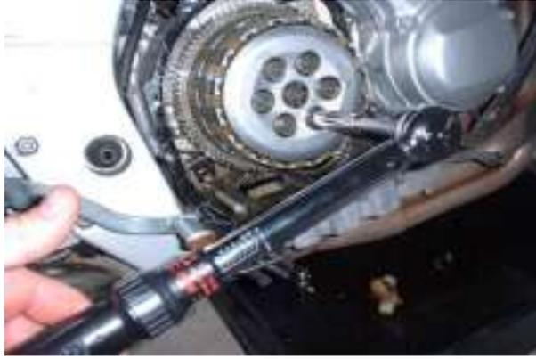
10.- Instala la tapa del embrague. Aprieta los tornillos con la mano, y luego hazlo con la llave dinamométrica a un par de 11,8 Nm.
