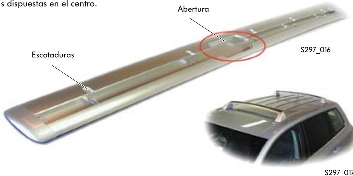
Los tirantes incluyen un mecanismo de sujeción con cerradura: Estando abierta la cerradura y suelta la tapa se empujan los soportes a la posición deseada. Cerrando la tapa y la cerradura se fijan los soportes. El soporte sólo se puede fijar en la zona de las escotaduras.
