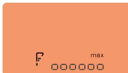
**El parpadeo de los 6 rectángulos y del «max» indica un nivel de aceite superior al máximo.**
