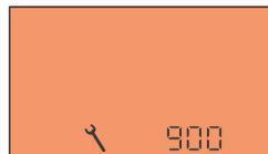
Cinco segundos después, el totalizador kilométrico recupera su funcionamiento normal y la llave de mantenimiento permanece encendida. El símbolo señala que próximamente será necesario efectuar una revisión periódica.
