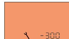
Cinco segundos después de poner el contacto, la llave de mantenimiento permanece encendida y el totalizador kilométrico recupera su funcionamiento normal.
