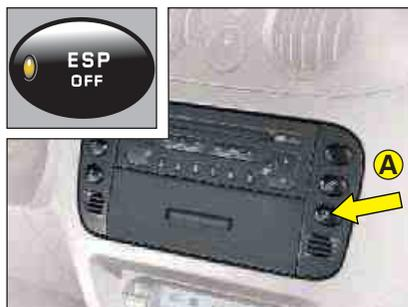
Este sistema está asociado al ABS y lo complementa. En caso de divergencia entre la trayectoria seguida por el vehículo y la deseada por el conductor, el sistema ESP actúa automáticamente sobre el freno de una o más ruedas y sobre el motor para situar el vehículo en la trayectoria deseada.
