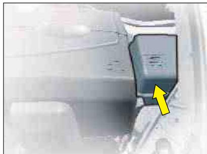
**Fusibles bajo capó motor****Caja de fusibles**
