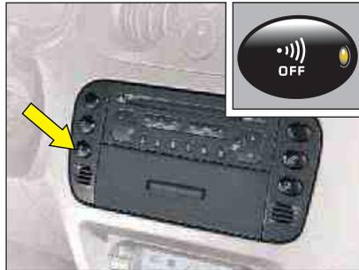
La instalación comprende además una sirena y un testigo visible desde el exterior que indica los tres posibles estados de la alarma:
