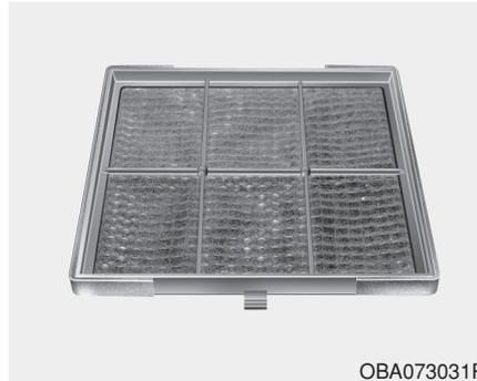
4. Inspeccionar y limpiar el filtro de control de clima con agua.
