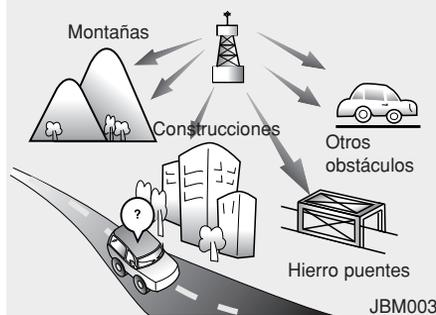
Las emisoras FM se transmiten a frecuencia alta y no sigue la curvatura de la superficie terrestre. Debido a ello, las emisoras FM suelen empezar a perder intensidad a cortas distancia de la estación. Asimismo, las construcciones, montañas u otros obstáculos afectan de manera más fácil las señales FM. Ello afecta a las condiciones de escucha y le haría creer que su radio tiene problemas. Las siguientes condiciones son normales y no implican problemas con la radio
