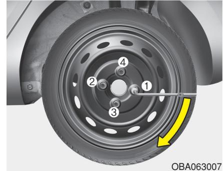
Después la posición de la llave es la que se muestra en la figura y apriete las tuercas de la rueda. Asegúrese de que el casquillo está completamente sobre la tuerca. No pise la manilla de la llave o utilice un tubo de extensión sobre la manilla de la llave.
