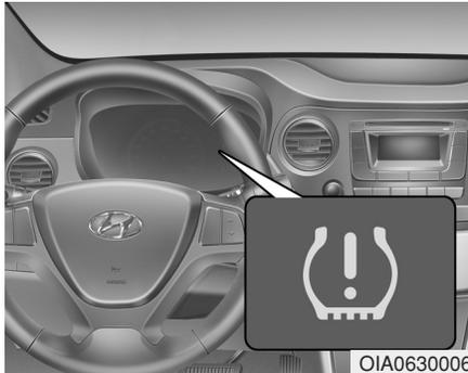
Indicador de presión baja de los neumáticos & Indicador de mal funcionamiento del TPMS
