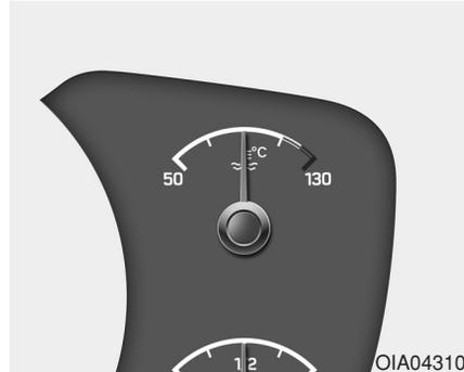
**Indicadores de temperatura del motor (si está equipado)**
