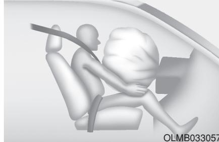
Después de completarse el inflado, el airbag comienza a desinflarse inmediatamente, permitiendo que el conductor mantenga la visión delantera y la capacidad de giro o de accionar otros controles.
