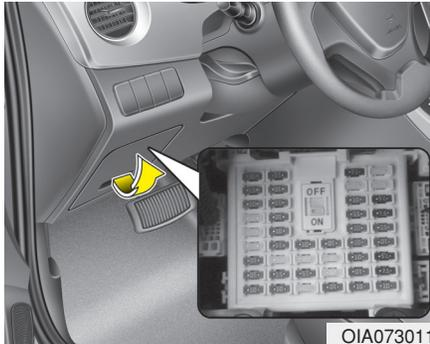
**Reemplazo de los fusibles del panel de instrumentos**
