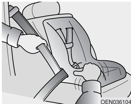
3. Eliminar del cinturón tanta flojedad como sea posible empujando hacia abajo sobre el sistema de retención infantil mientras introduce el cinturón de seguridad de hombro de vuelta en el retractor.
