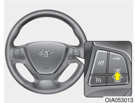
3. Presione el interruptor SET, y suelte a la velocidad deseada. La luz indicadora SET se iluminará en el tablero de instrumentos. Suelte el acelerador al mismo tiempo. La velocidad deseada se mantendrá de forma automática.
