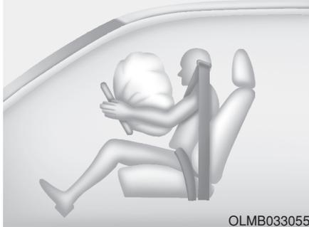
Una vez desplegado, lo roto que parece moldeado directamente en las cubiertas del panel se separará por la presión de la expansión del airbag. Esta mayor apertura de las cubiertas es lo que permite el completo inflado de los airbag.
