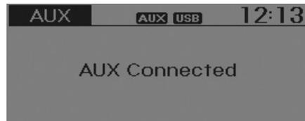
\* El modo AUX no puede iniciarse a menos que haya un dispositivo externo conectado al terminal AUX.
