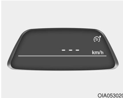
La luz indicadora de límite de velocidad se iluminará en el tablero de instrumentos.
