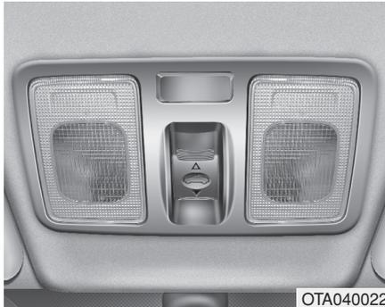
Si el vehículo está equipado con un techo solar, puede deslizar o inclinar su techo solar con los palanca de control ubicados en la consola superior.
