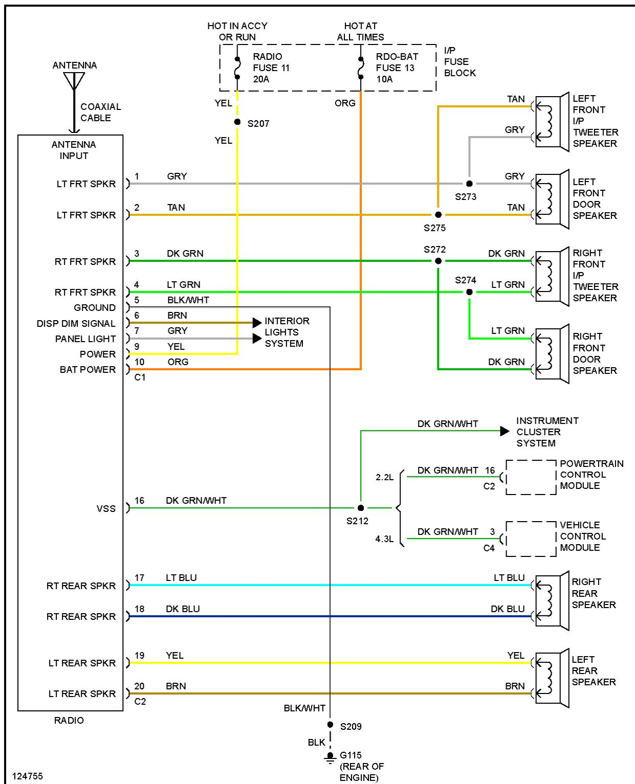
**Fig. 35: 6-Speaker System Circuit**
