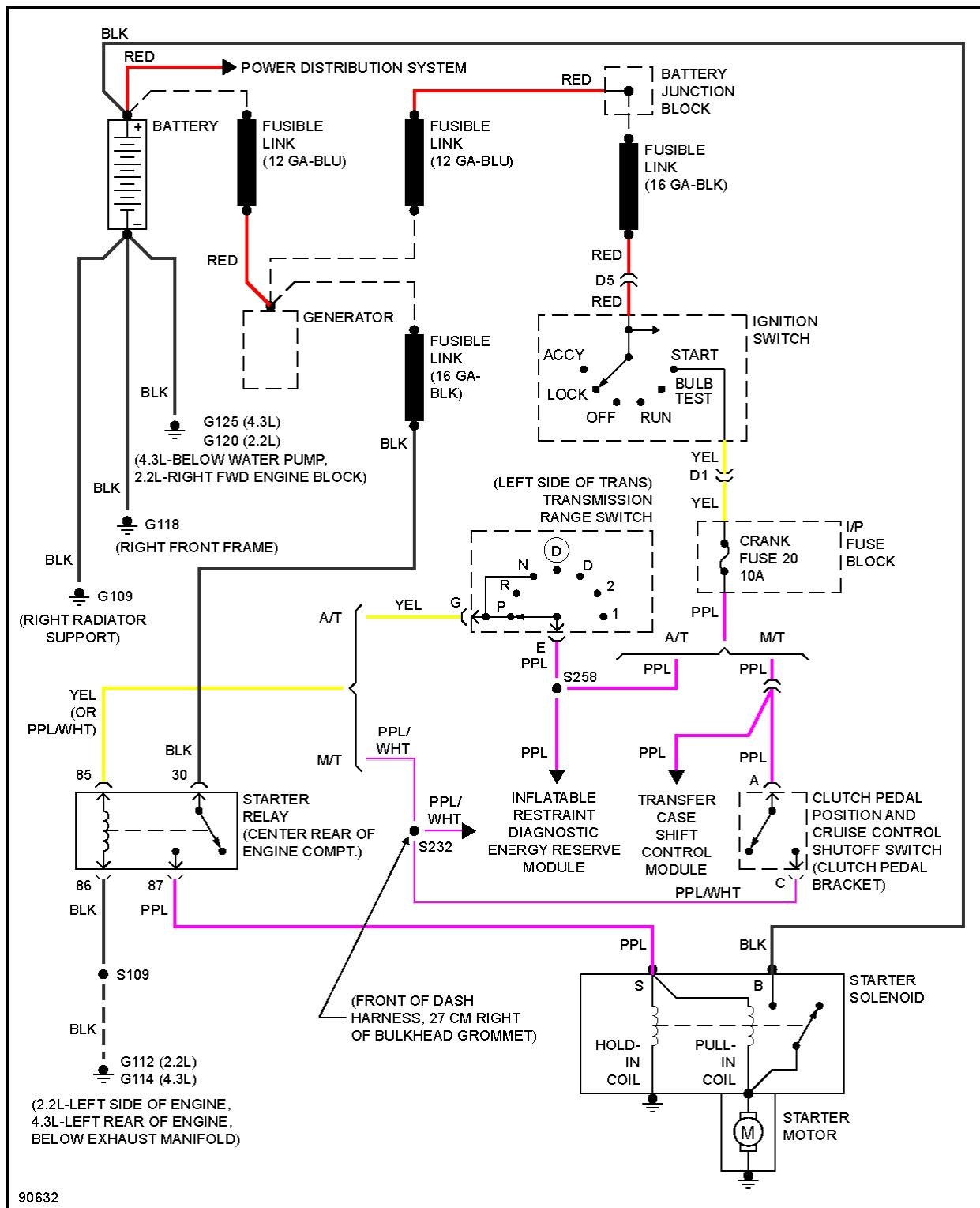
**Fig. 38: Starting Circuit**
