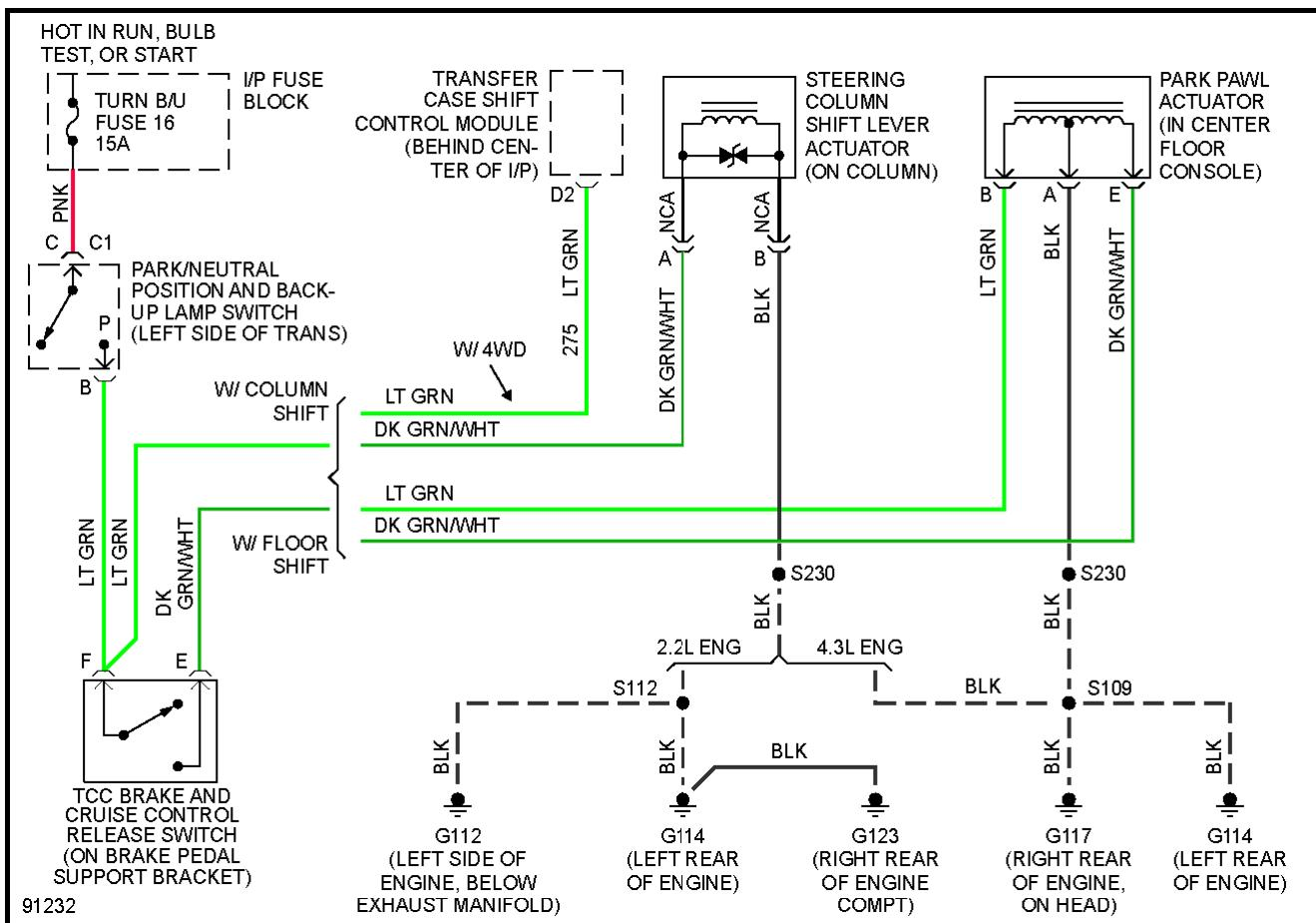
**Fig. 36: Shift Interlock Circuit**
