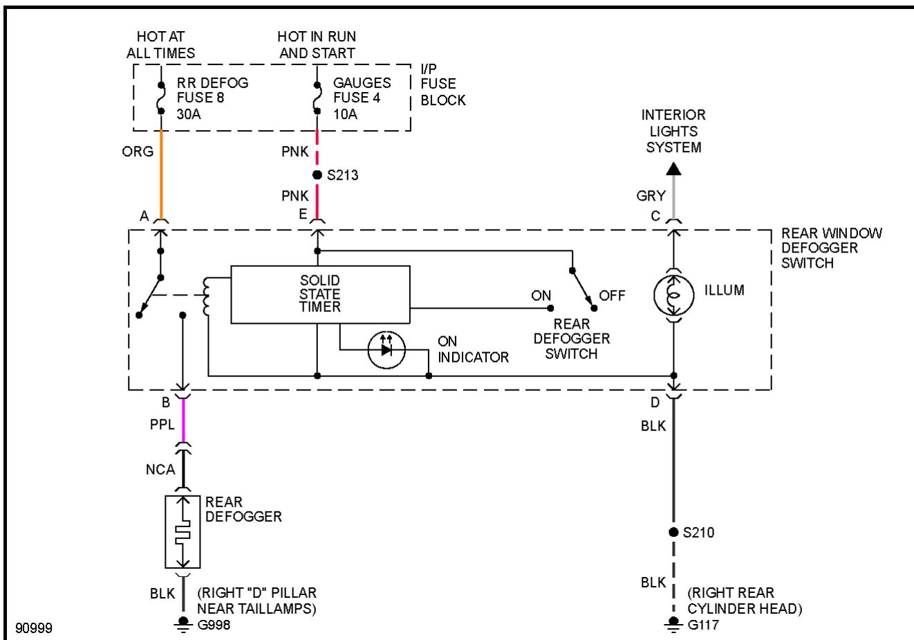
**Fig. 5: Defogger Circuit**
