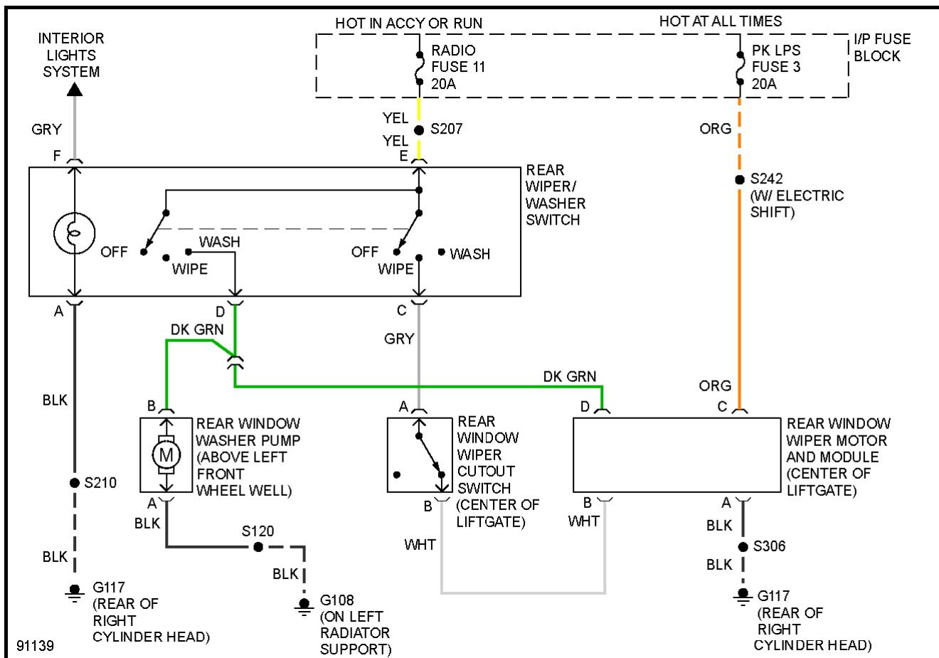
**Fig. 45: Rear Wiper/Washer Circuit**
