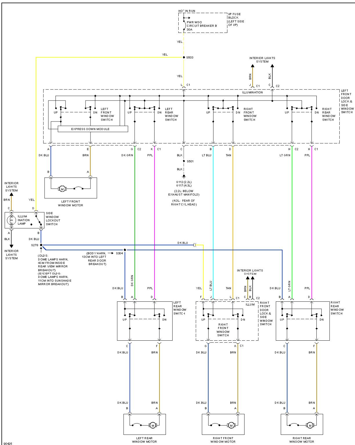
**Fig. 33: Power Window Circuit, 4 Door**
