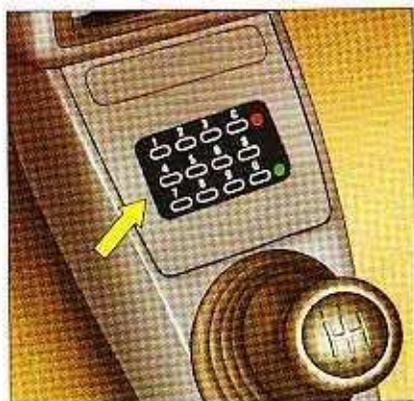
Este dispositivo antirrobo, permite bloquear el sistema de control del motor, a partir de un código reprogramable de cuatro cifras.
