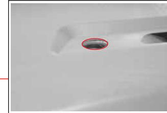
**Sensor de humedad y temperatura interior**
