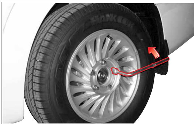
7. Gire la llave inglesa para tuerca de rueda en sentido antihorario para aflojar las tuercas de la rueda una o dos veces. No extraiga las tuercas de las ruedas hasta que el neumático esté fuera del suelo.
