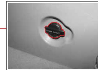
Este tomacorriente está ubicado en el lado derecho de la carrocería, al levantar la cuarta fila de asientos. Para obtener más información sobre precauciones y advertencias, refiérase a la sección "Tomacorriente delantero".
