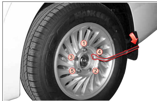
12. Coloque el neumático de auxilio y ajuste temporalmente las tuercas de la rueda con las manos.
