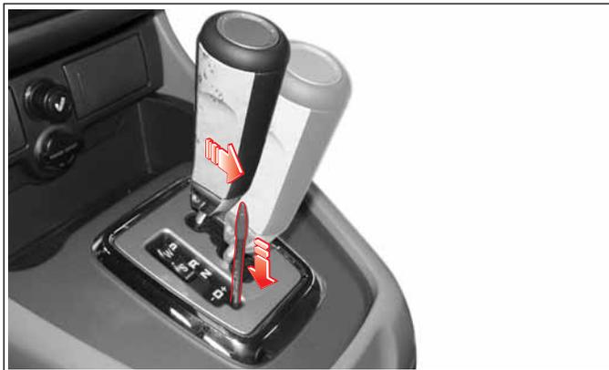
1. Gire la llave de ignición a la posición “ON” y oprima el pedal de frenos.
