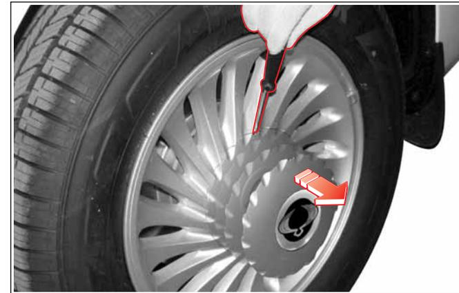
6. Levante la tapa de la rueda haciendo palanca con un destornillador plano.
