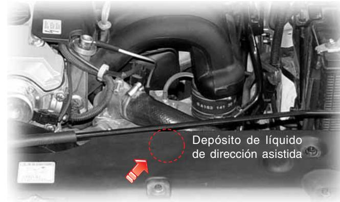
Estacione el motor en una superficie plana, apague el motor y revise el nivel del líquido.
