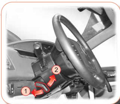
El volante puede ser ajustado hacia arriba o hacia abajo en la posición deseada. Para ajustar el volante, mueva la palanca de control en la dirección de la flecha y ajústelo hacia arriba o hacia abajo en la posición adecuada. Para trabar el volante en esta posición, mueva la palanca de control en la dirección de la flecha.
