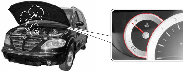
Si el medidor de temperatura del refrigerante del motor indica una condición de sobrecalentamiento u otra razón que indique sobrecalentamiento, detenga y estacione el vehículo.
