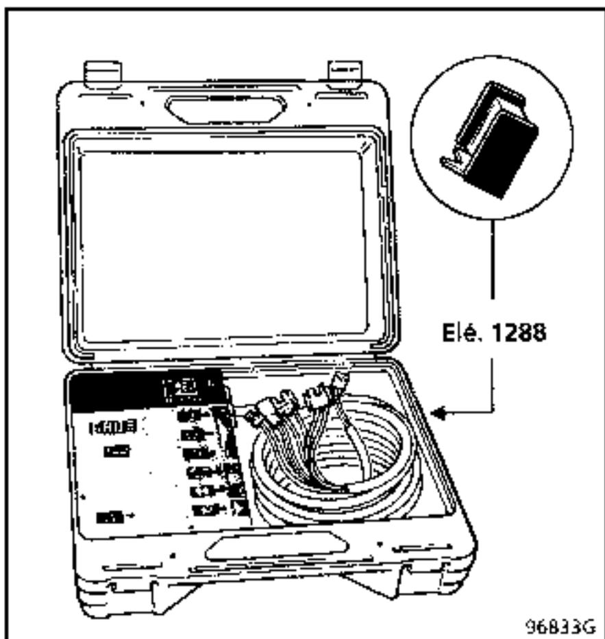
Este aparato es un útil específicamente realizado para el control y el diagnóstico de los dispositivos airbags y pretensores de los cinturones de seguridad.
