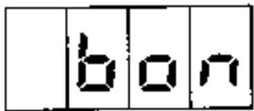
(\*22), ello indica que el código del calculador de inyección no ha sido borrado. En este caso, verificar la conformidad del número de código de emergencia y repetir el proceso.
