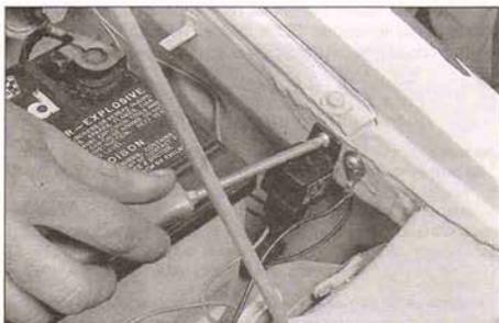
6.35 Si su juego usa un relé y/o una conexión a tierra separada para las luces, taladre perforaciones y conéctelos seguramente al vehículo - asegúrese de que las conexiones a tierra hacen buen contacto eléctrico con la carrocería
