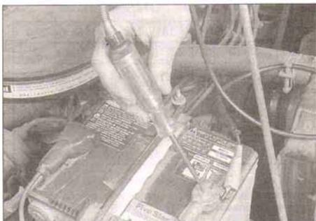
4.21 Para averiguar si la batería tiene una fuga, desconecte el cable negativo y conecte una luz de prueba entre la abrazadera del cable y el poste negativo de la batería. Si se enciende la batería cuando están desconectados todos los accesorios, hay una fuga
