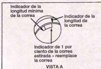
5.7 En algunos modelos, la correa se tensa automáticamente y no es necesario realizar ningún mantenimiento mientras esté en buena condición y el indicador esté en el rango adecuado
