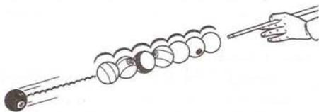
1.3 La corriente se desplaza a la velocidad de la luz utilizando un principio similar al siguiente ejemplo de la mesa de billar - se puede comparar la fuerza de la bola de billar empleada para iniciar el juego con el voltaje y las colisiones de las bolas con el flujo de la corriente
