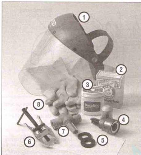
4.11 Herramientas y materiales necesarios para el mantenimiento de la batería
