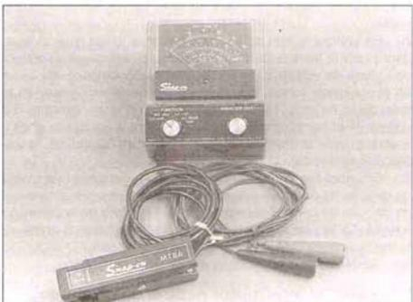
4.29b Los medidores inductivos de amperaje como éste son más caros, pero también pueden hacer variedades de pruebas voltaje DC y de resistencia en el alternador (o generador), voltaje, regulador, diodos, resistores de balasto, etc.
