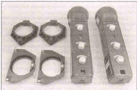
6.25 Componentes mecánicos de enfoque como éstos le pueden ayudar a obtener resultados profesionales - a la izquierda hay adaptadores para varios tipos de luces delanteras
