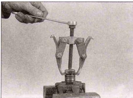
5.52 ... a veces puede utilizarse un extractor de dos mordazas común para remover el cojinete; puede utilizarse un martillo y una llave de tubo del mismo diámetro que el anillo interno del cojinete para colocar el cojinete nuevo en su lugar
