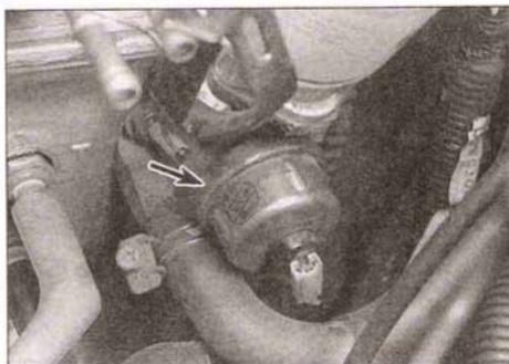
7.14 Aquí presentamos una unidad de envío de presión de aceite usada en un sistema de tipo medidor - observe que es mucho más grande que las unidades de envío para los sistemas de luces indicadoras, ya que debe guardar un resistor variable
