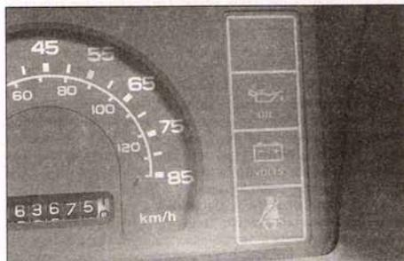
7.1 Montaje de una luz indicadora típica usa una luz detrás de un lente rojo con el tipo de problema o condición que está indicando impreso sobre el lente
