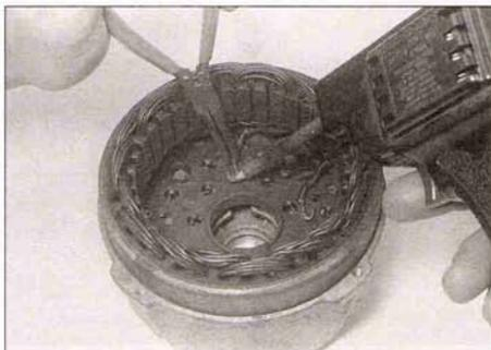
5.46 En algunos modelos, debe desoldarse el estator antes de sacar la placa de diodos
