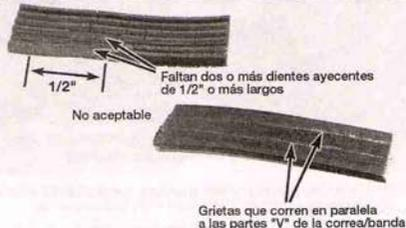
5.4 Grietas pequeñas en el interior de una correa/banda de tipo serpentina son aceptables - grietas en la longitud o falta de pedazos es razón para el remplazo
