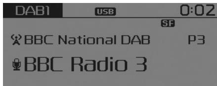
Pulse la tecla **RADIO** para cambiar el modo FM1 → FM2 → FMA → DAB1 → DAB2 → AM por este orden.
