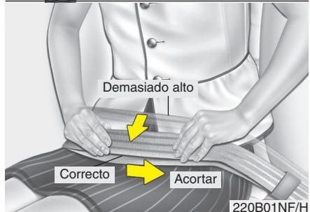
Con los cinturones estáticos de 2 puntos de anclaje hay que ajustar la longitud manualmente para que se ciña al cuerpo. Enganche el cinturón y tire del extremo libre para apretarlo. Coloque el cinturón tan bajo sobre las caderas como pueda, no en la cintura. Si el cinturón está demasiado alto, aumenta la probabilidad de sufrir lesiones en caso de accidente.
