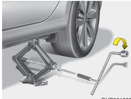
7. Coloque el gato delante o detrás en la posición correspondiente más cercana a la rueda que está cambiando. Sitúe el gato en los lugares designados a tal efecto bajo la carrocería. Las posiciones para colocar el gato son placas soldadas a la carrocería con dos pestañas y un punto elevado para graduar con el gato.
