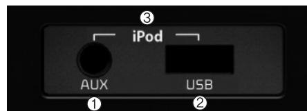
1. Terminal AUX : Terminal de conexión de dispositivo externo
