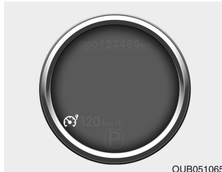
Para conducir sobre pasando el límite de velocidad ajustado, pise con fuerza el pedal del acelerador (más del 80%) hasta que se accione el mecanismo de reducción de marcha con un clic.
