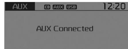
\* El modo AUX no puede ponerse en marcha a menos que se haya conectado un dispositivo externo en el terminal AUX.
