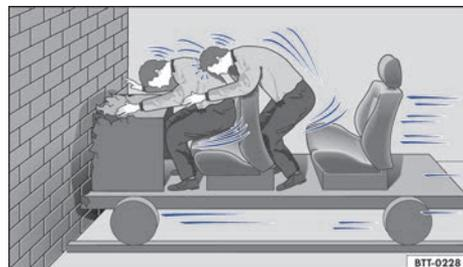
**Fig. 51** El vehículo choca contra el muro. Los ocupantes no llevan colocado el cinturón de seguridad. ▶
