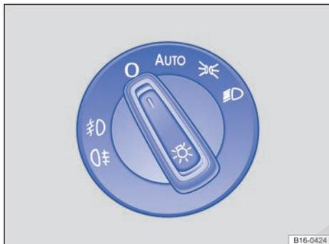
**Fig. 76** Junto al volante: mando de las luces (un tipo).
