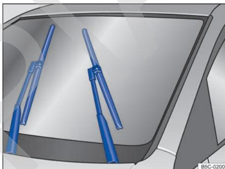
Fig. 82 En el parabrisas: limpiaparabrisas en posición de servicio.
