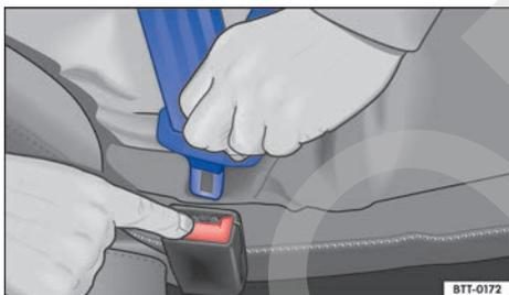
**Fig. 56** Soltar la lengüeta del cierre del cinturón.
