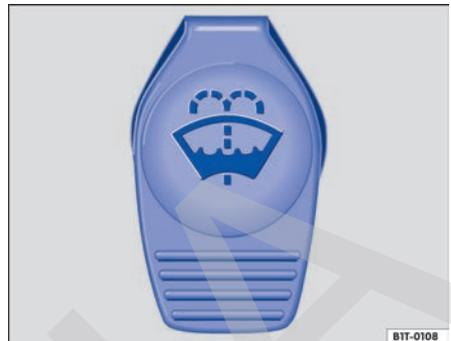
**Fig. 85** En el compartimento del motor: tapa del depósito del lavacrístales.
