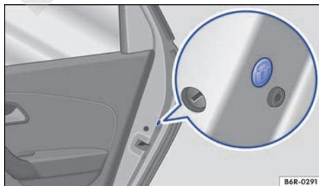
**Fig. 164** En el frontal de la puerta trasera derecha: bloqueo de emergencia tapado por una junta de goma.
