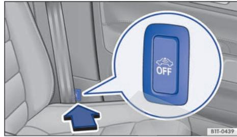
**Fig. 20** Junto al asiento del conductor: tecla para desconectar la vigilancia del habitáculo y el sistema antirremolcado.
