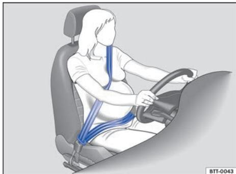
**Fig. 62** Colocación correcta de la banda del cinturón en el caso de mujeres embarazadas.
