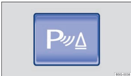
**Fig. 119** En la consola central: tecla para conectar y desconectar el ParkPilot (en función del equipamiento).
