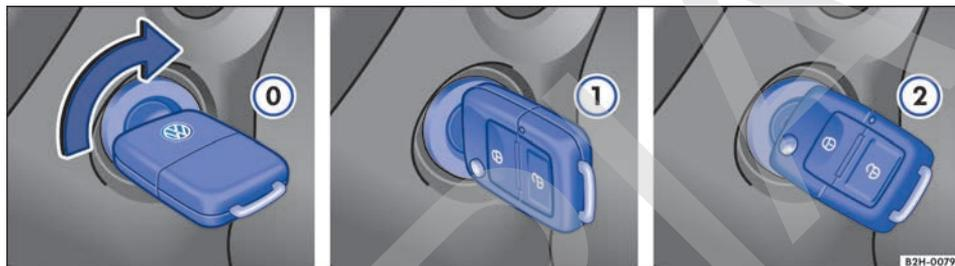
Fig. 107 Posiciones de la llave del vehículo en la cerradura de encendido.
