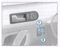
Fig. 15 Detalle de la puerta del conductor: mandos para todas las ventanillas
