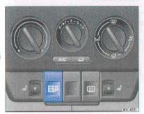
Fig. 65 Consola central: tecla ESP
