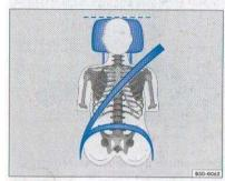
Fig. 32 Visto de frente: apoyacabezas y cinturón ajustados correctamente
