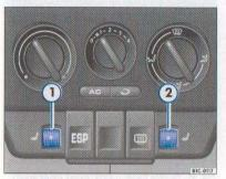
Fig. 38 Consola central: ruedecillas moleteadas para la calefacción de los asientos delanteros
