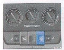
Fig. 31 Consola central: mando para la luneta tér-
