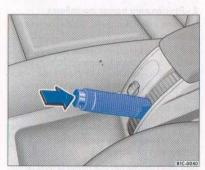
Fig. 70 Palanca del freno de mano entre los asientos delanteros
