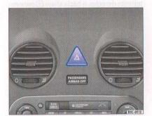
Fig. 22 Tablero de instrumentos: conmutador de los intermitentes de emergencia
