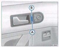
Fig. 5 Detalle de la puerta del conductor: pulsador del cierre centralizado
