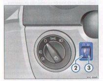
Fig. 21 Detalle del tablero de instrumentos: regulación del alcance de las luces
