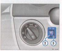
Fig. 20 Detalle del tablero de instrumentos: requladores de la iluminación de instrumentos y mandos
