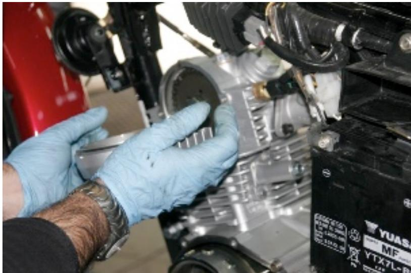
*Retirar los dos tornillos y la tapa lateral izquierda de la culata.*
