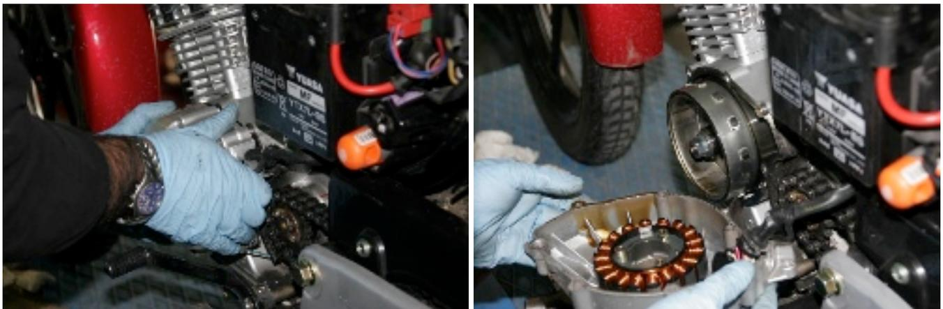
*Retirando la tapa del alternador quedan al descubierto el bobinado del alternador (fijo) y el volante magnético (unido al cigüeñal y que rota con él). En las fotos, modelo YBR'07.*
