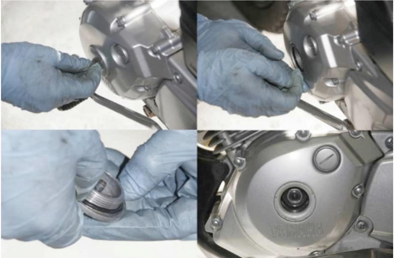
*El tapón central de la tapa del alternador puede desenroscarse con una moneda. Si la junta se queda pegada a la tapa, no olvidar introducirla de nuevo en el tapón. Queda accesible el eje del cigüeñal. El tapón pequeño, algo más arriba y a la derecha, no es necesario quitarlo.*
