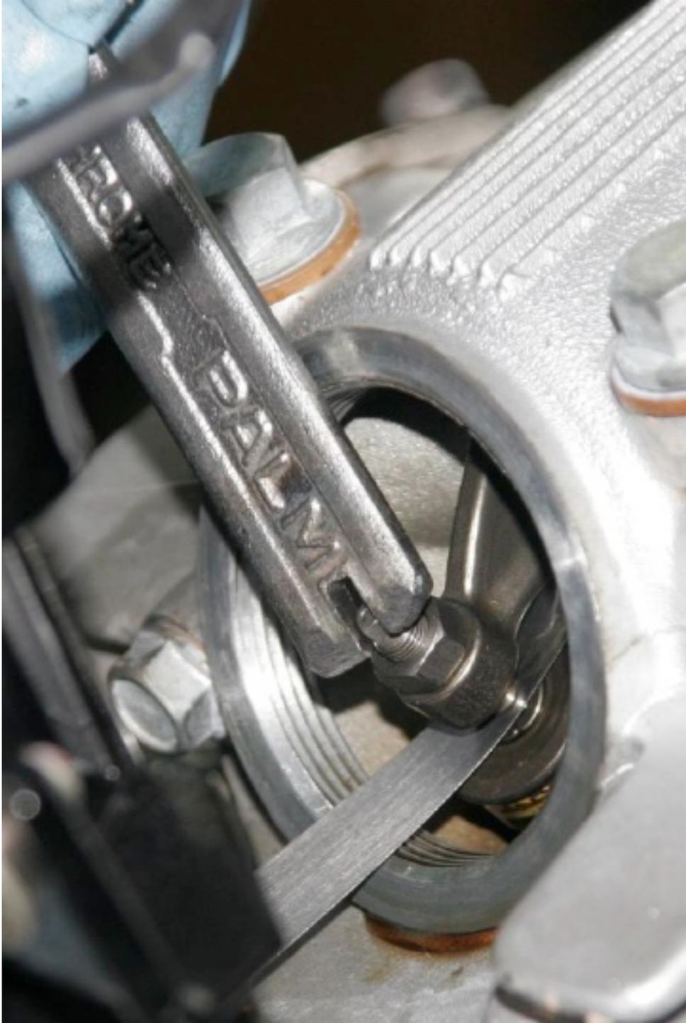
*Reglaje de holgura de válvulas: se gira el tornillo y se comprueba la holgura con la galga.*
