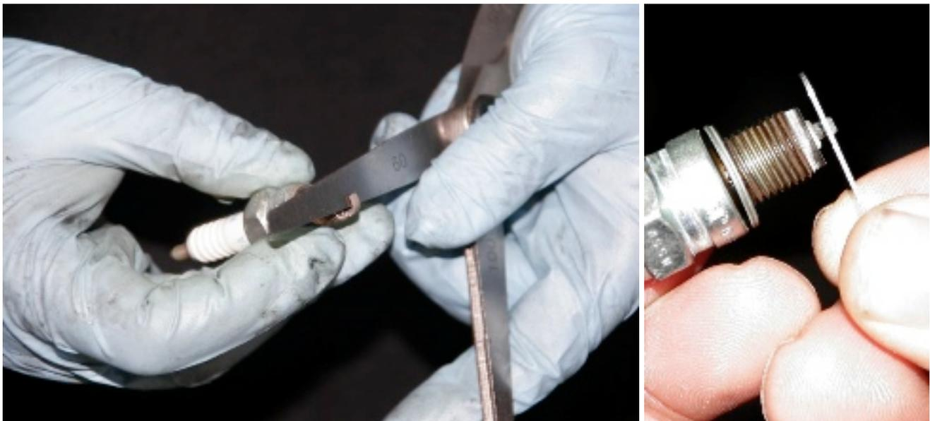
*Separación de electrodos de bujía.*
