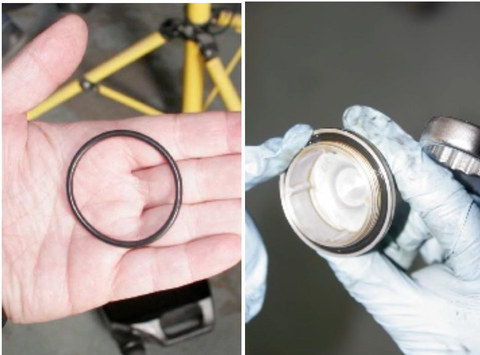
*Junta tórica de tapón. Lubricar con un poco de aceite antes de colocar.*
