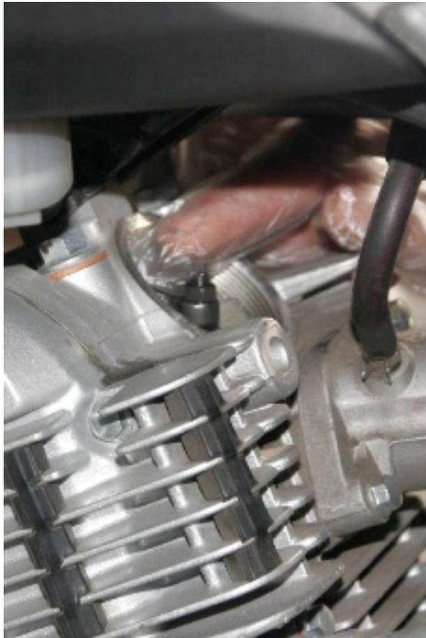
*Comprobación manual de que los balancines no pisan las válvulas.*
