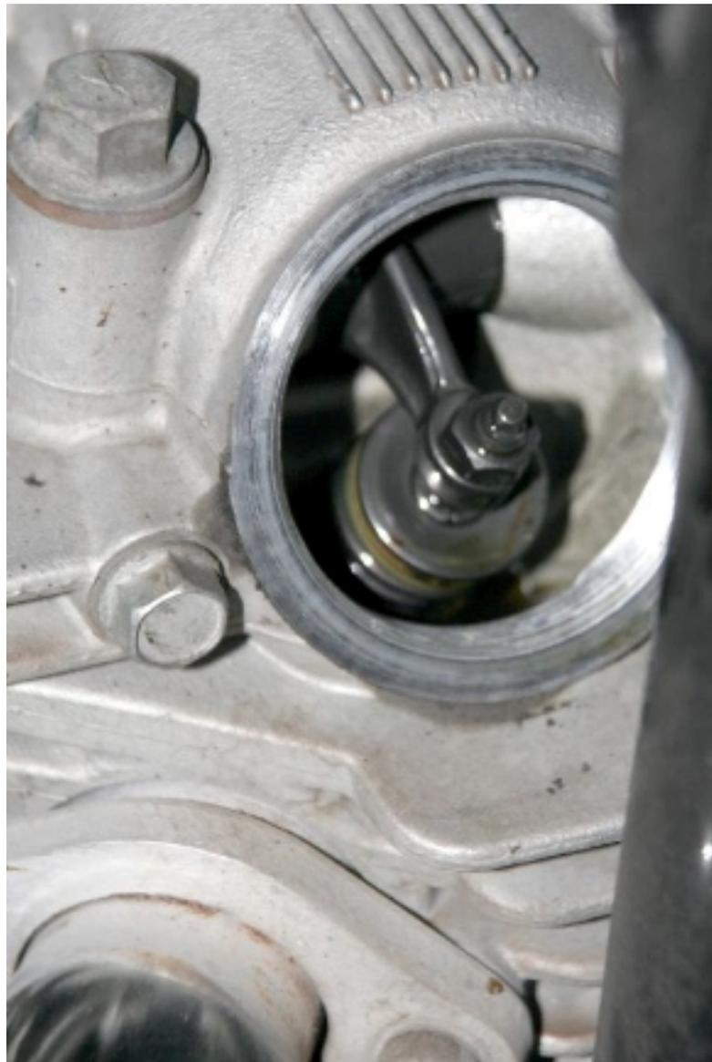
*Piezas retiradas. Quedan al descubierto los balancines que actúan sobre las válvulas*
