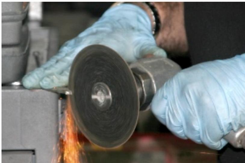
*Fabricación de una llave para el tornillo de cabeza cuadrada. Con una radial se practica una hendidura...*
