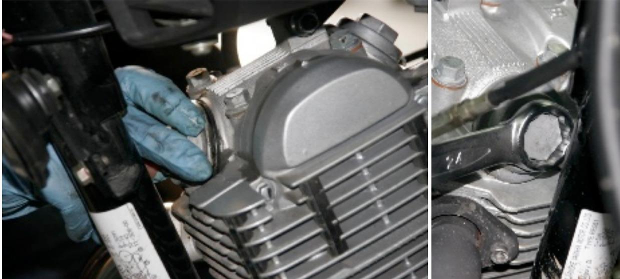
*Se enroscan y aprietan los tapones de acceso a balancines.*
