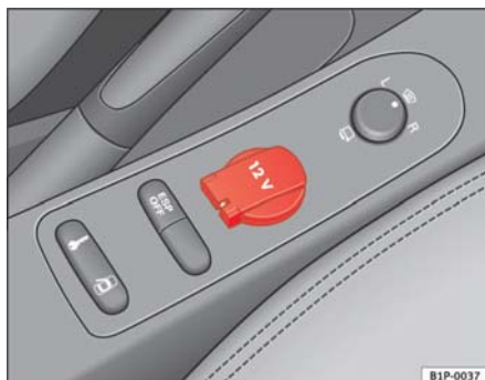
Fig. 101 Toma de corriente consola central delantera
