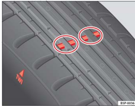
Fig. 144 Indicadores de desgaste del perfil del neumático
