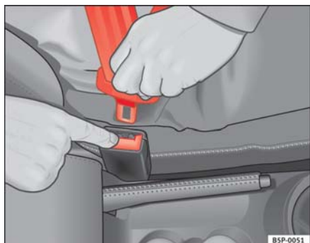
Fig. 15 Retirar la lengüeta del cierre del cinturón
