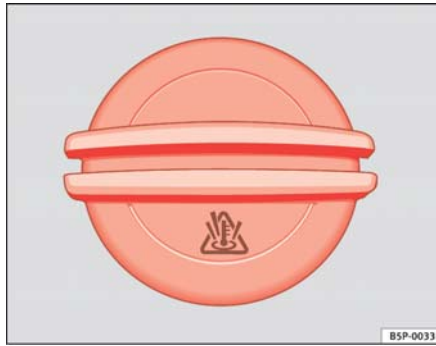
Fig. 139 Tapón del depósito de expansión del líquido refrigerante en el vano motor
