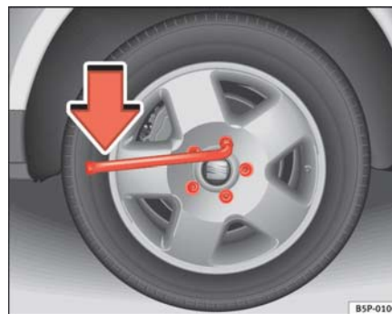
Fig. 148 Cambio de rueda: aflojar los tornillos de rueda
