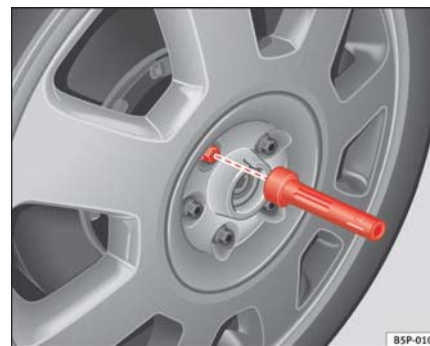
Fig. 151 Cambio de rueda: Útil de hexágono interior para girar los tornillos
