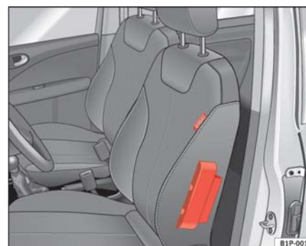
Fig. 21 Airbag lateral en el asiento del conductor
