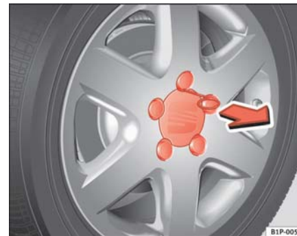
Fig. 147 Cambio de rueda: Retirar el embellecedor de la rueda
