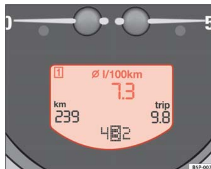
Fig. 39 Pantalla digital del cuadro de instrumentos: indicador consumo medio de combustible
