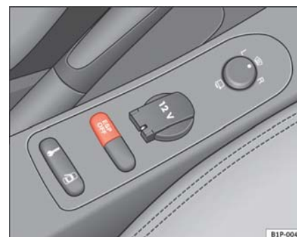
Fig. 113 Detalle de la consola central: tecla ESP
