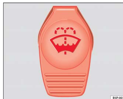
Fig. 140 Tapón del depósito del lavacristales en el vano motor.
