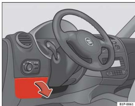
Fig. 153 Tapa de la caja de fusibles en el lado izquierdo del tablero de instrumentos
